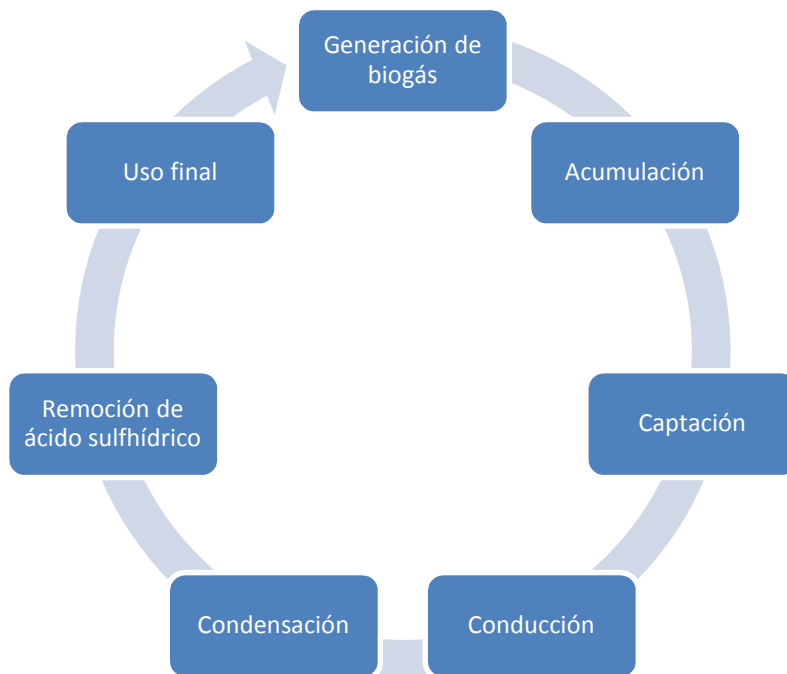
Figura 6 Proceso de Captación y utilización del Biogás
