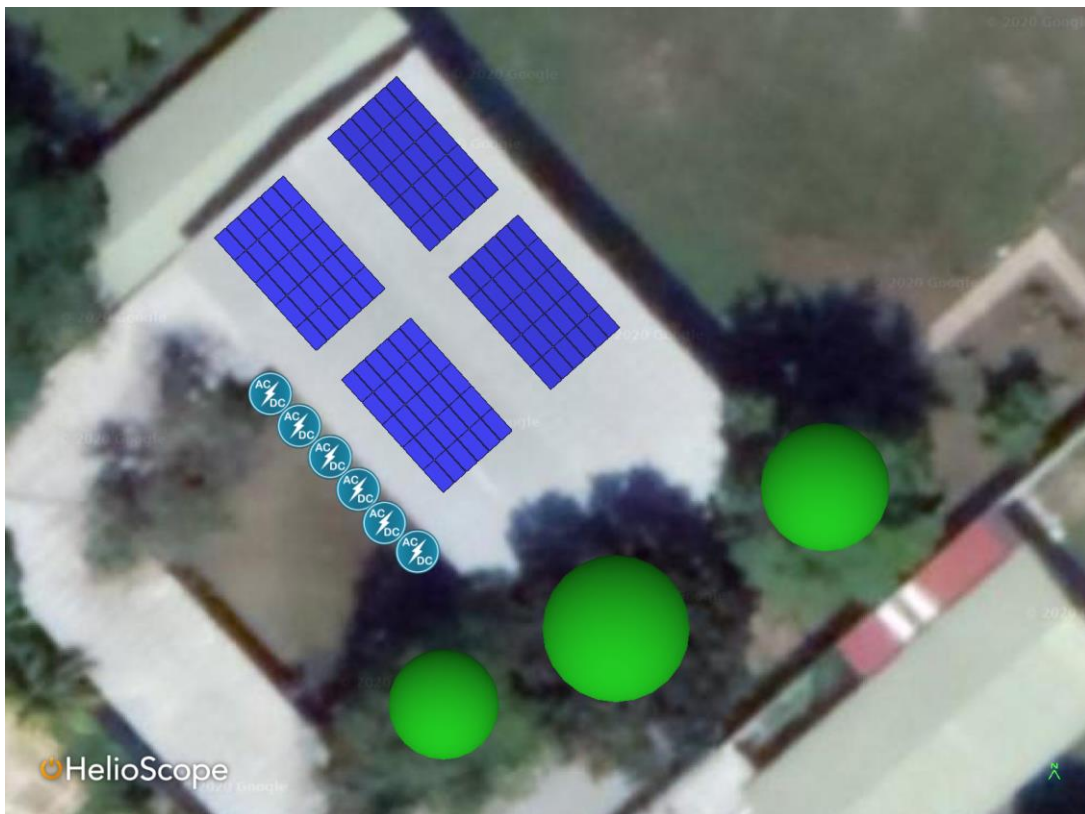
Figura 46 Distribución de los módulos e inversores en las aguas del edificio 2 Fuente: Software Helioscope
