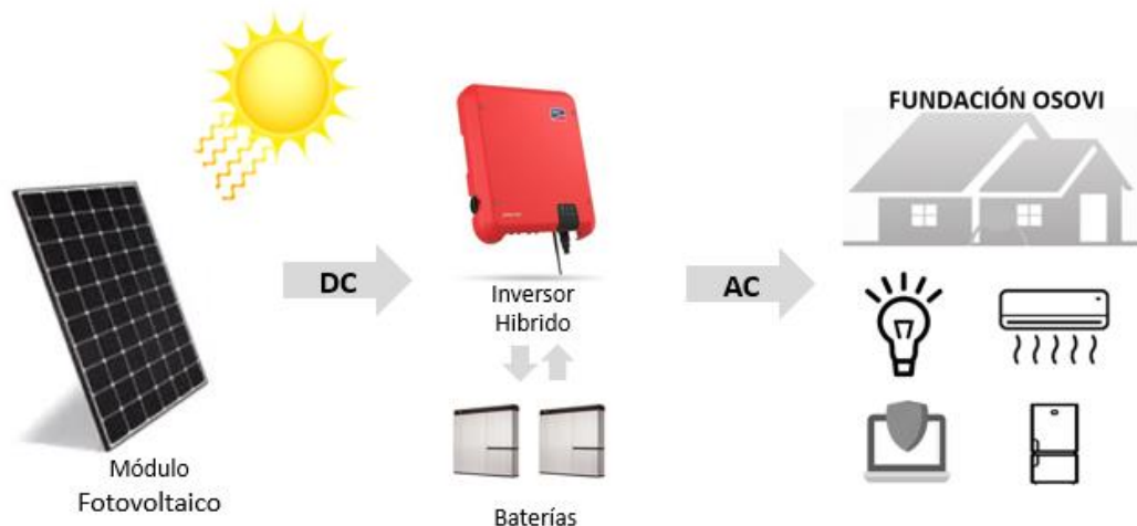
Figura 41 Esquema del sistema híbrido
