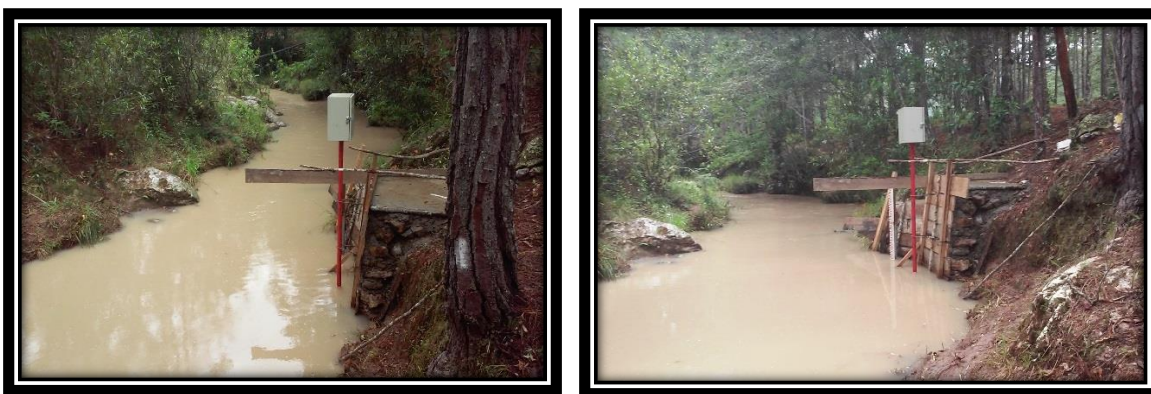
Ilustración 6. Sección transversal de medición, Quebrada "Las Cañas"
