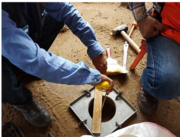
Ilustración 105 Medición de profundidad de hoyo
