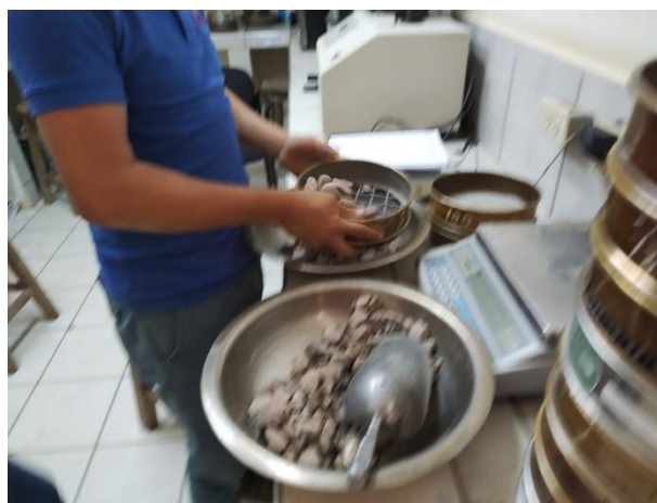
Ilustración 96 Tamizado de granulometría gruesa
