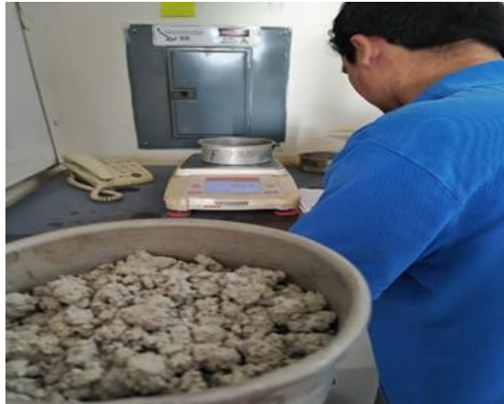
Ilustración 50 Peso de muestras de suelo para ensayo de contenido de humedad
