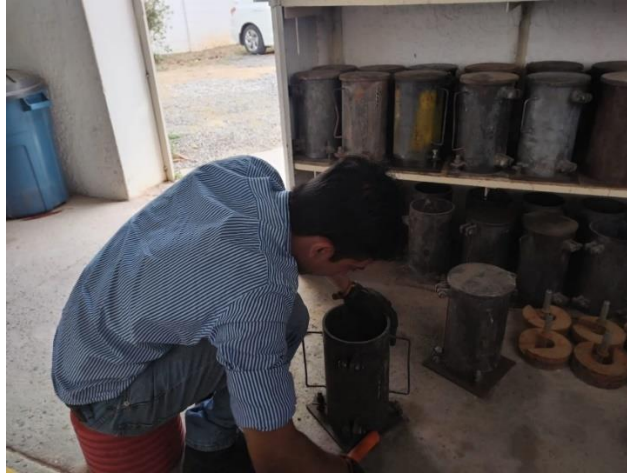
Ilustración 94 Verificación de moldes de cilindros
