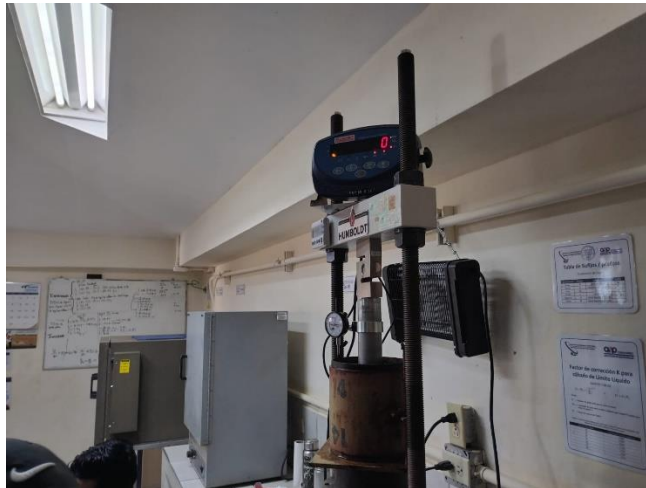
Ilustración 116 Molde esperando carga previa de 30 libras para ser penetrado
