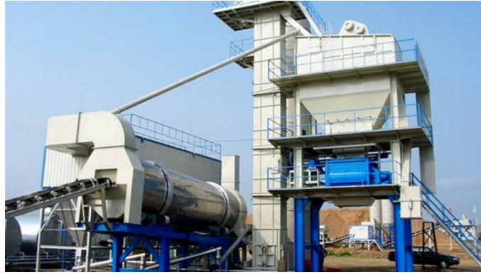
Ilustración 36 Planta de concreto asfáltico
