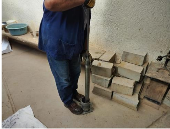
Ilustración 54 Ensayo de Proctor estándar
