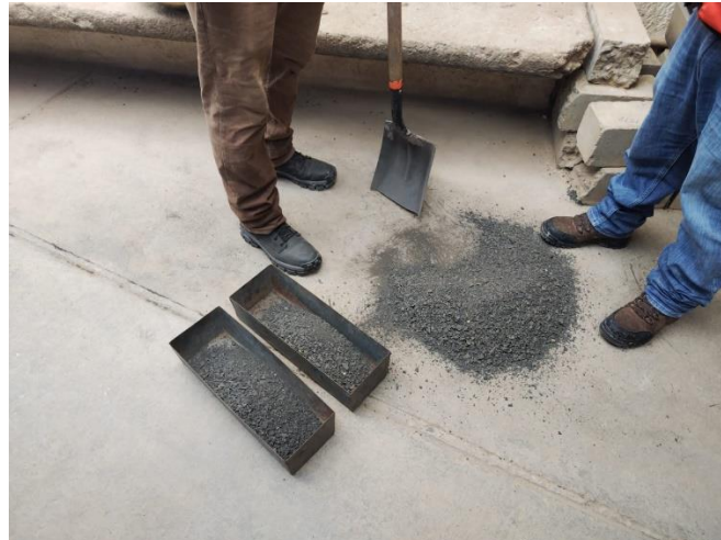
Ilustración 55 Cuarteo agregado grueso
