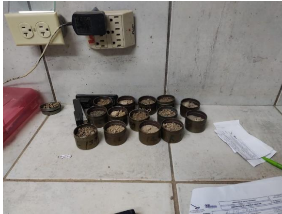
Ilustración 100 Muestras de suelo en latas para contenido de humedad
