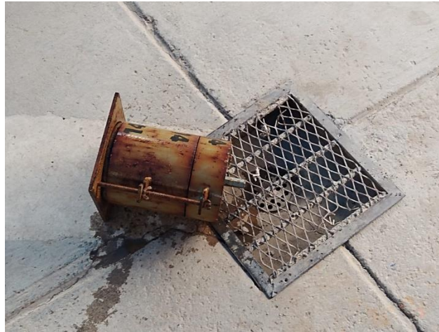
Ilustración 115 Agua de molde CBR escurriendo por diez minutos
