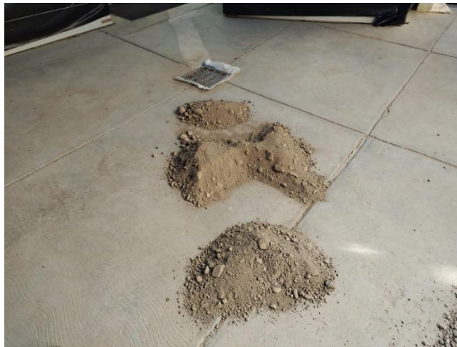
Ilustración 98 Cuarteo de granulometría fina
