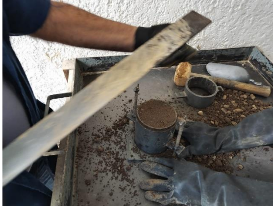
Ilustración 61 Enrasado de molde para Proctor estándar
