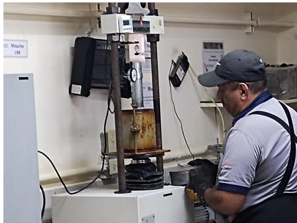
Ilustración 110 Colocación de espaciador sobre molde CBR
