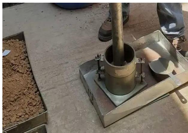
Ilustración 19 Ensayo de compactación Proctor estándar
