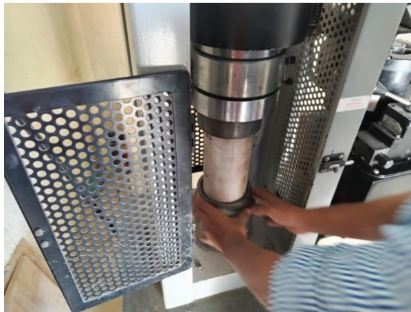
Ilustración 95 Ensayo a compresión de cilindros
