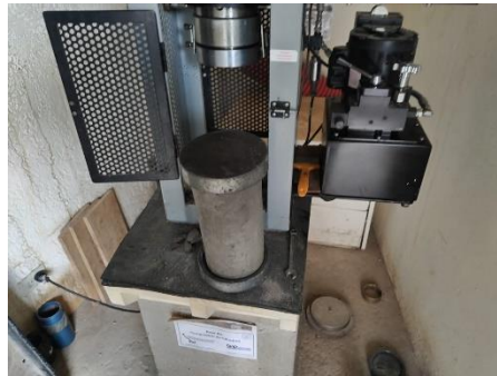
Ilustración 46 Ensayo a compresión de cilindros de concreto
