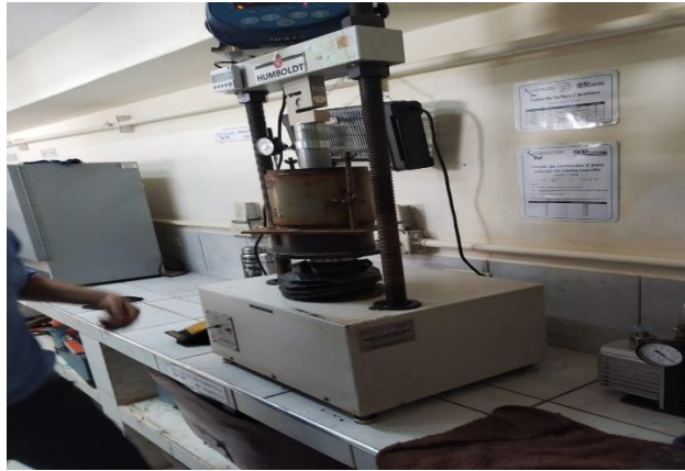
Ilustración 119 Molde CBR listo para ser penetrado
