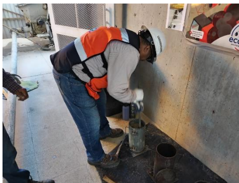
Ilustración 114 Golpes con varilla al concreto en molde de cilindro
