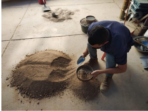
Ilustración 97 Tamizado de granulometría fina
