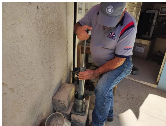
Ilustración 99 Compactación de muestra de suelo
