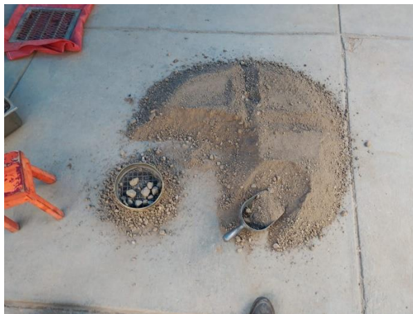
Ilustración 52 Cuarteo de muestra para ensayo de granulometría
