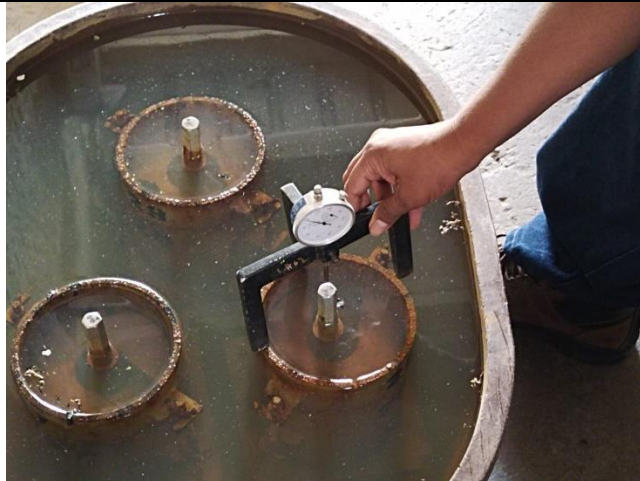
Ilustración 118 Lectura de hinchamiento final molde CBR
