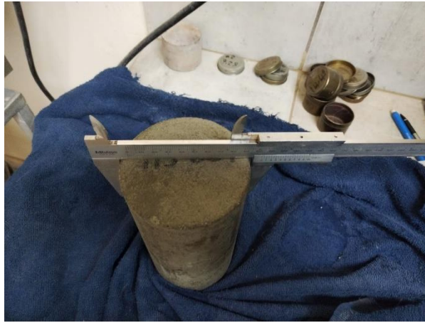
Ilustración 103 Medición de diámetro de cilindro con pie de rey
