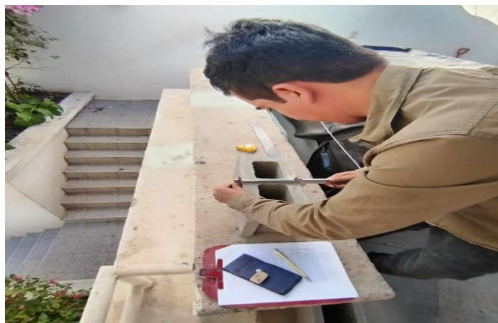
Ilustración 91 Medición de bloques de concreto
