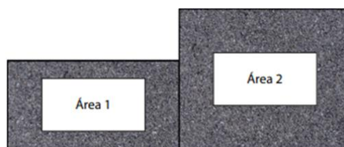
Ilustración 31 Bache de forma irregular
