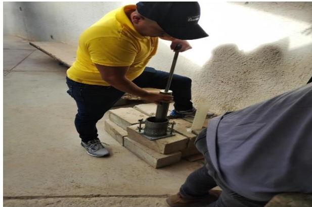
Ilustración 109 Compactación de muestra con martillo de cinco libras
