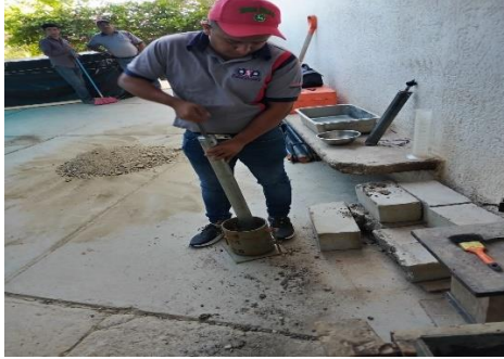
Ilustración 111 Compactación de CBR con martillo de diez libras
