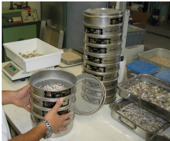
Ilustración 12 Ensayo de granulometría por tamizado
