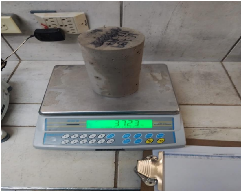
Ilustración 106 Toma de peso de cilindro de concreto
