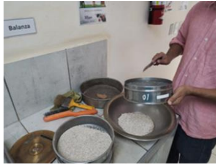
Ilustración 45 Proceso de tamizado para ensayo de granulometría
