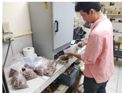
Ilustración 48 Ensayo de contenido de humedad
