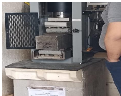
Ilustración 47 Ensayo a flexión para viga de concreto
