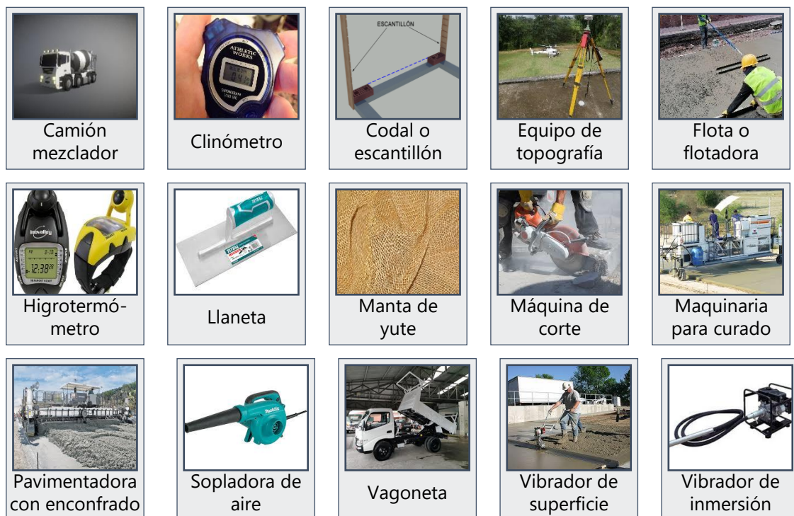
Gráfico 15 Equipo y maquinaria utilizado para concreto hidráulico
