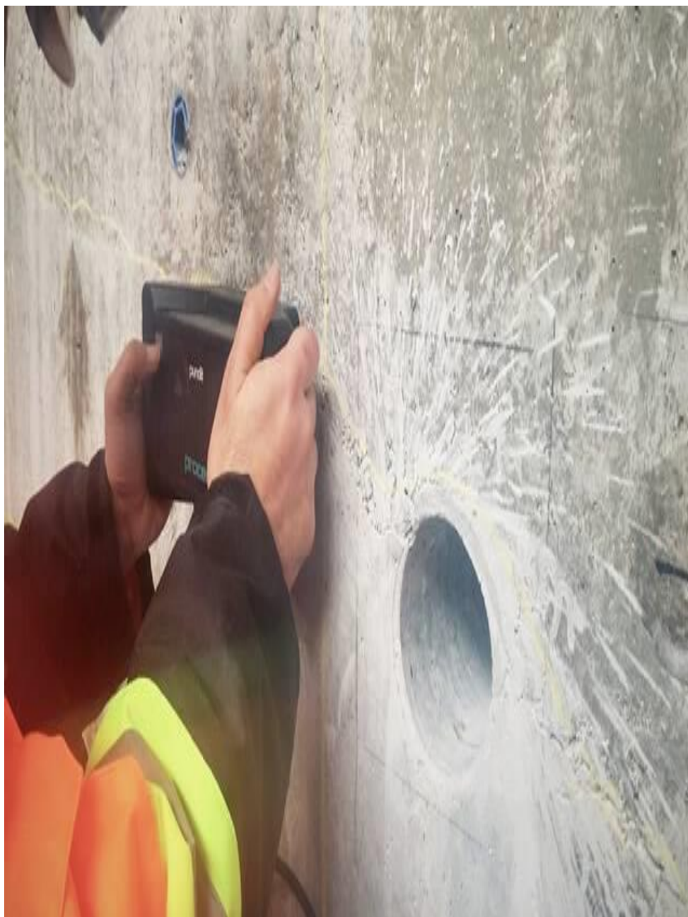
Ilustración 35 Tomografía ecográfica de pulso ultrasónico
