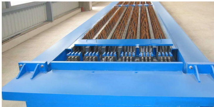
Ilustración 30 Armado de hormigón pretensados
