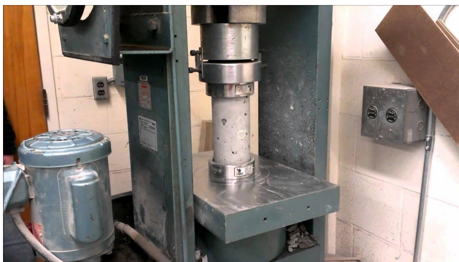
Ilustración 33 Pruebas resistencia a la compresión
