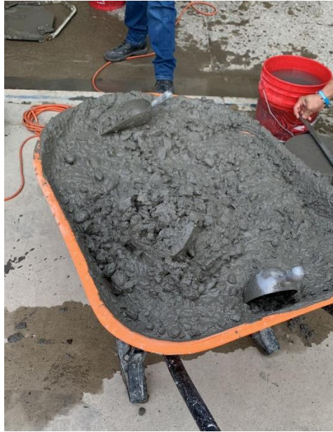
Anexo 1 - Mezcla de concreto con cemento MH
