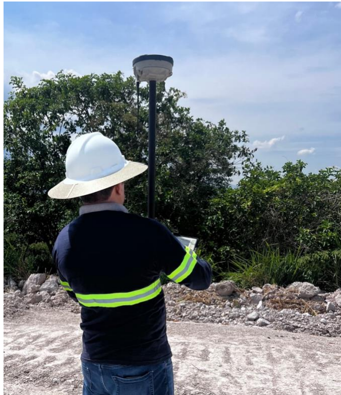
Ilustración 22-Real Time Kinematics "RTK"
