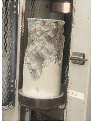
Ilustración 14-Rotura de Especímenes de Concreto
