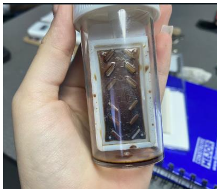
Ilustración 15- Prueba de aditivo para inspección de bacterias
