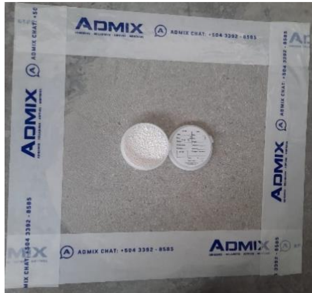
Ilustración 54-Colocación de la prueba sobre el piso
