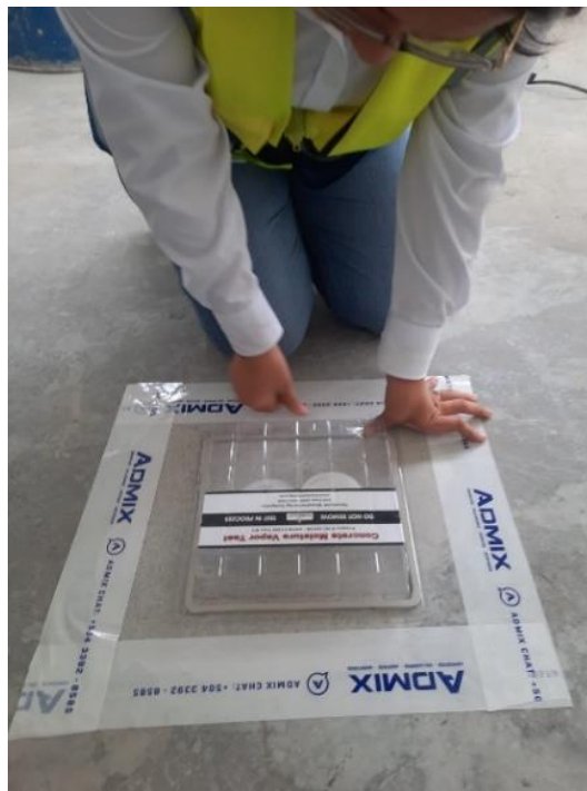
Ilustración 55-Tapadera de plástico para evitar que se dañe la muestra de prueba
