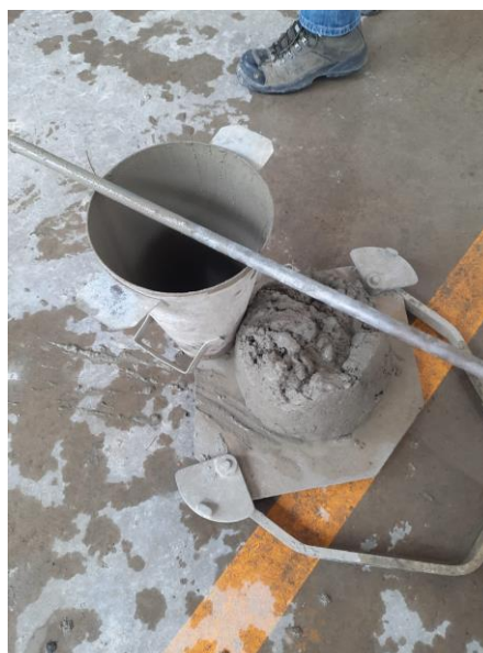
Ilustración 31-Prueba de revenimiento al concreto con Admix K integral
