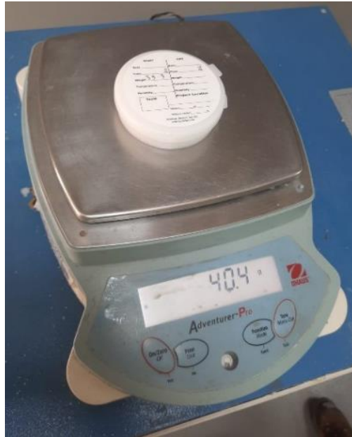
Ilustración 56-Peso final de la prueba de humedad
