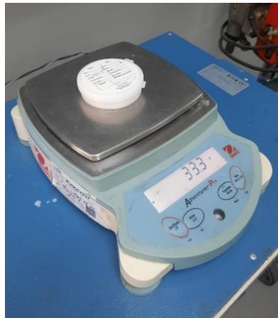
Ilustración 52-Peso inicial del recipiente para prueba de humedad
