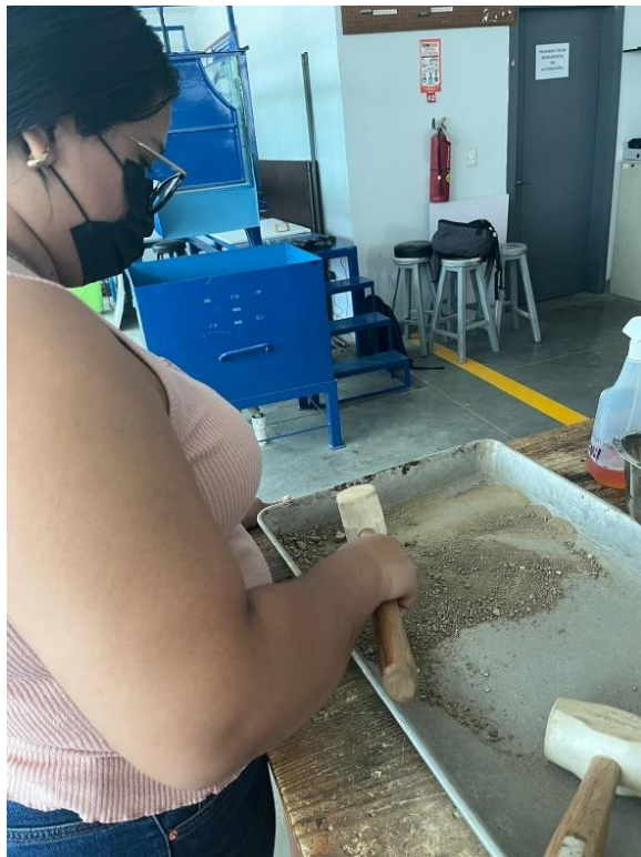
Ilustración 106-Eliminación de grumos en la muestra de suelo
