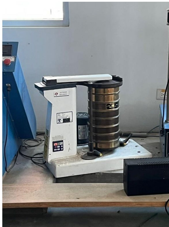
Ilustración 108-Tamizado de la muestra
