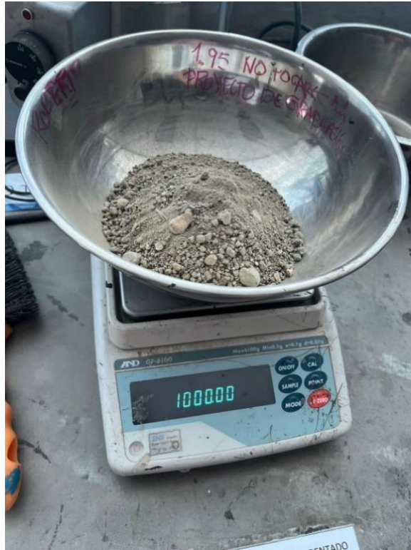
Ilustración 107-Peso de la muestra para granulometría
