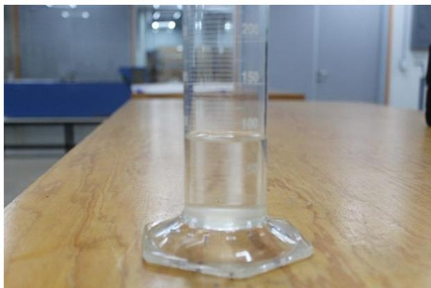
**Ilustración 61 Medición de agua para humectación de sustrato**
