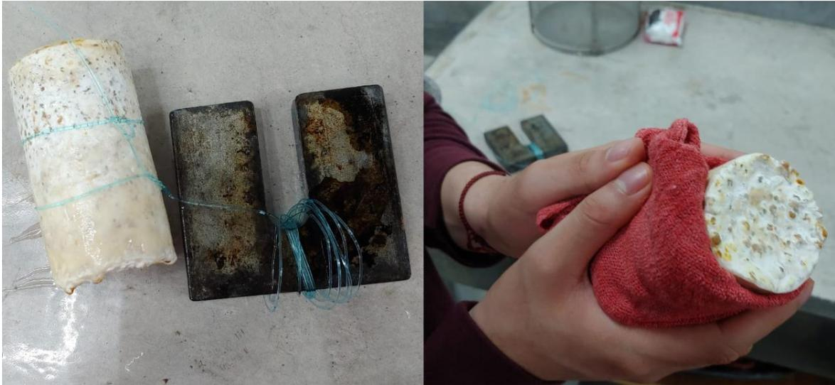
**Ilustración 80** Secado del micelio una vez sumergido en agua durante 24 horas.
