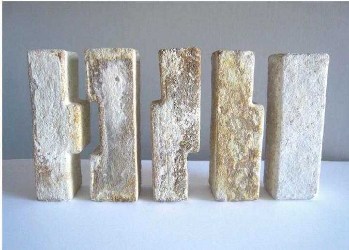
**Ilustración 37 Ladrillo entrelazado fabricados por la empresa "MycoWorks"**
