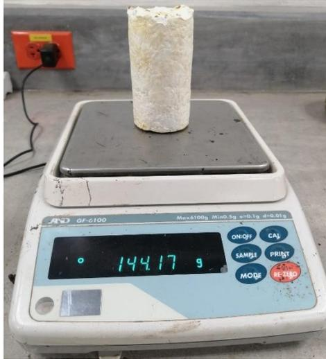
**Ilustración 78** Peso de cilindro de micelio antes de sumersión en agua
