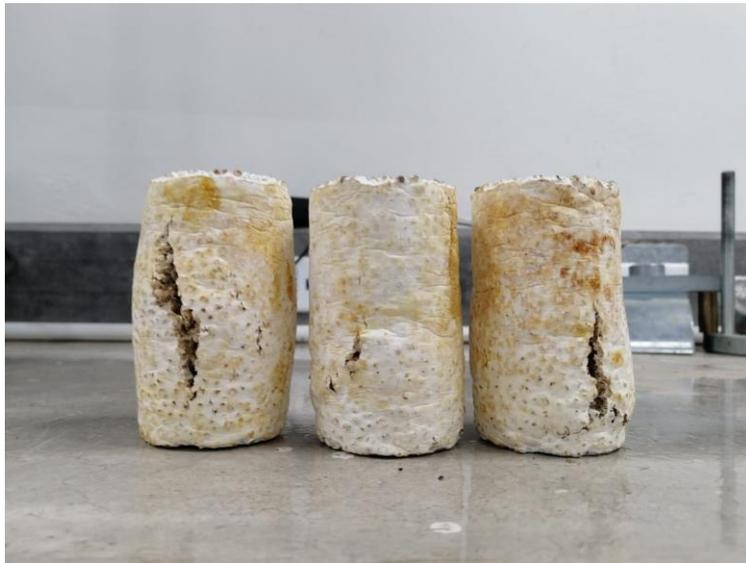
**Ilustración 77 Fallo de cilindros de micelio**
