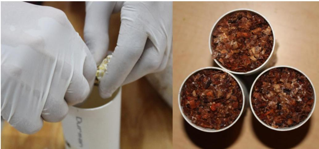
**Ilustración 69 Colocación de sustrato en moldes cilíndricos**
