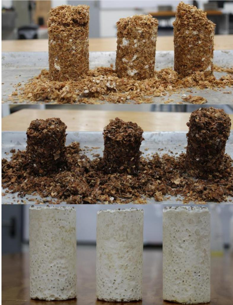
**Ilustración 85 Crecimiento de micelio en moldes cilíndricos**
