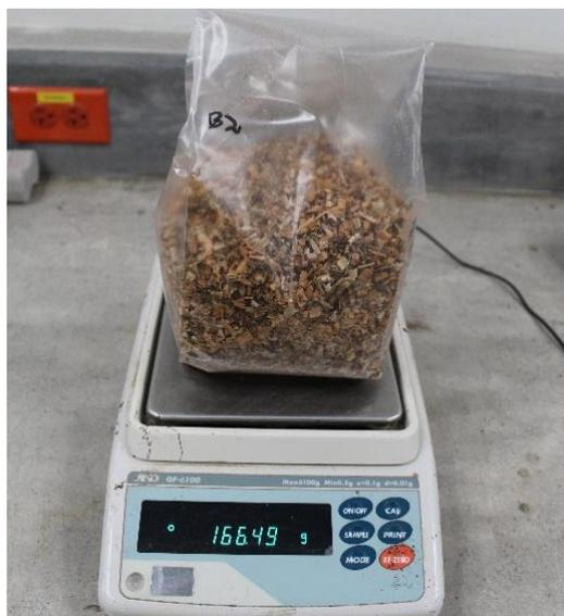
**Ilustración 60 Registro de peso de aserrín de Caoba en bolsa**
