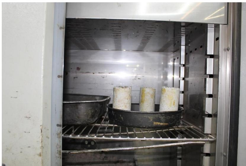
**Ilustración 74 Secado del micelio al horno**
