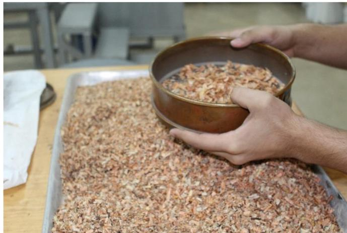
**Ilustración 55 Tamizado #4 de aserrín**
