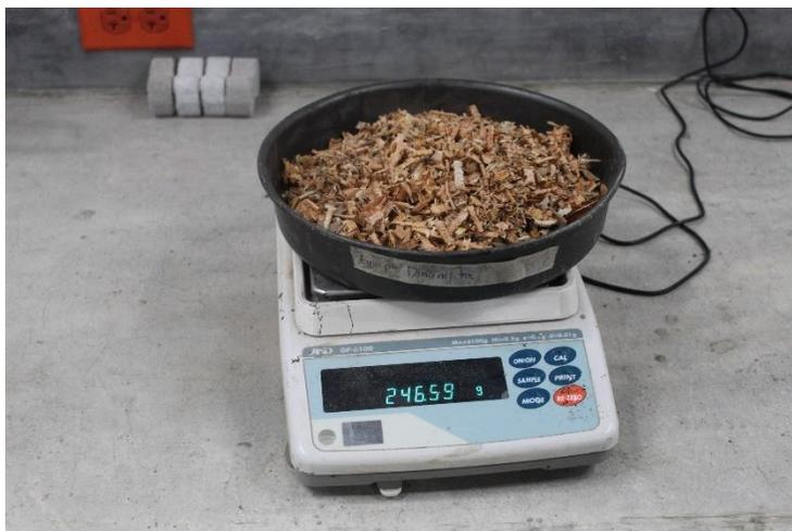
**Ilustración 54 Registro de peso de aserrín retenido en tamiz**
