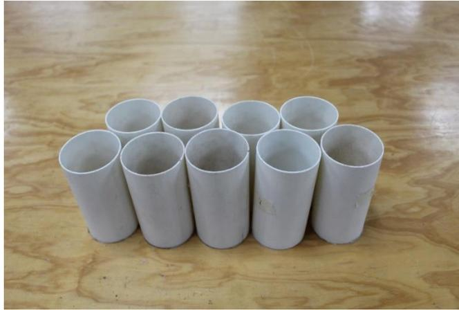
**Ilustración 51 Moldes cilíndricos para realización de probetas de micelio y aserrín**
