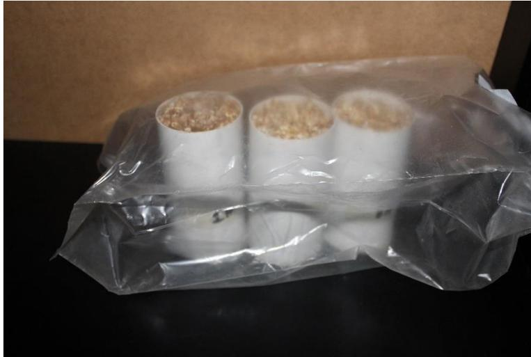
**Ilustración 70 Incubación final del micelio en moldes**
