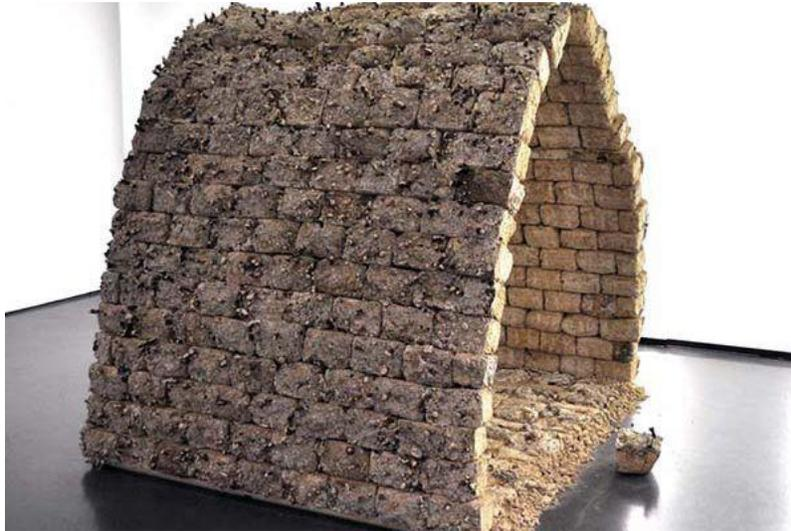
**Ilustración 38 Arco hecho con bloques de micelio de *Ganoderma Lucidum***
