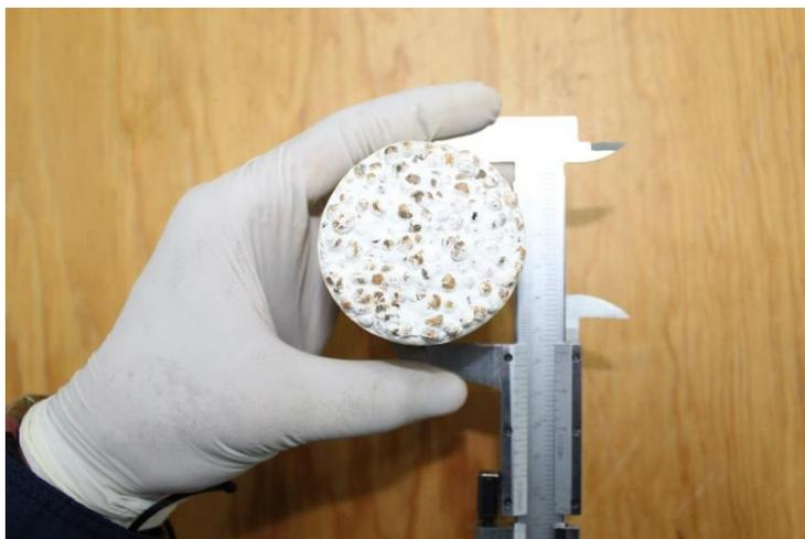
**Ilustración 73 Medición de dimensiones de cilindro de micelio**
