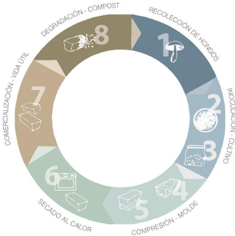
**Ilustración 7 Diagrama cíclico de materiales de micelio**
