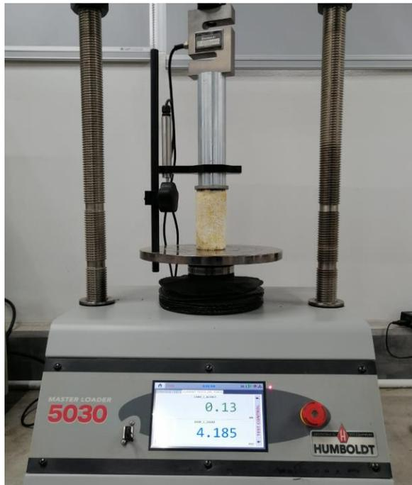
**Ilustración 75 Colocación de micelio en máquina de compresión**
