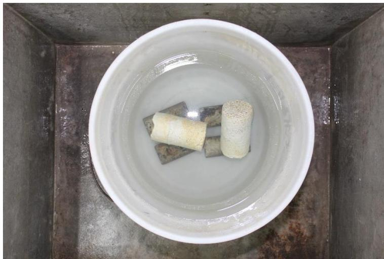
**Ilustración 79** Cilindros de micelio sumergidos en agua
