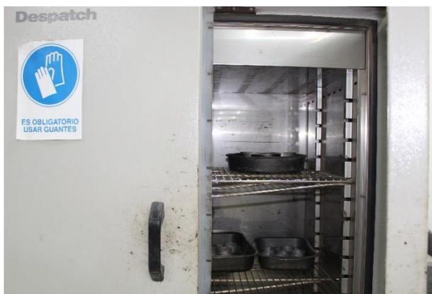
**Ilustración 59 Colocación de latas de contenido de humedad dentro del horno**
