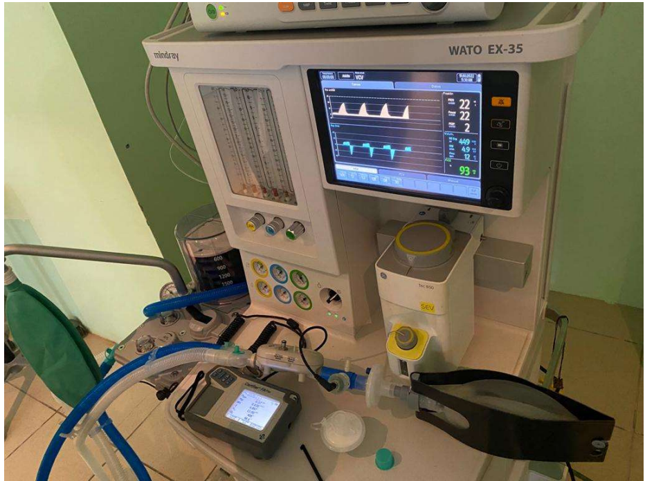
Ilustración 9. Verificación de funcionamiento de máquina de anestesia utilizando analizador TSI
