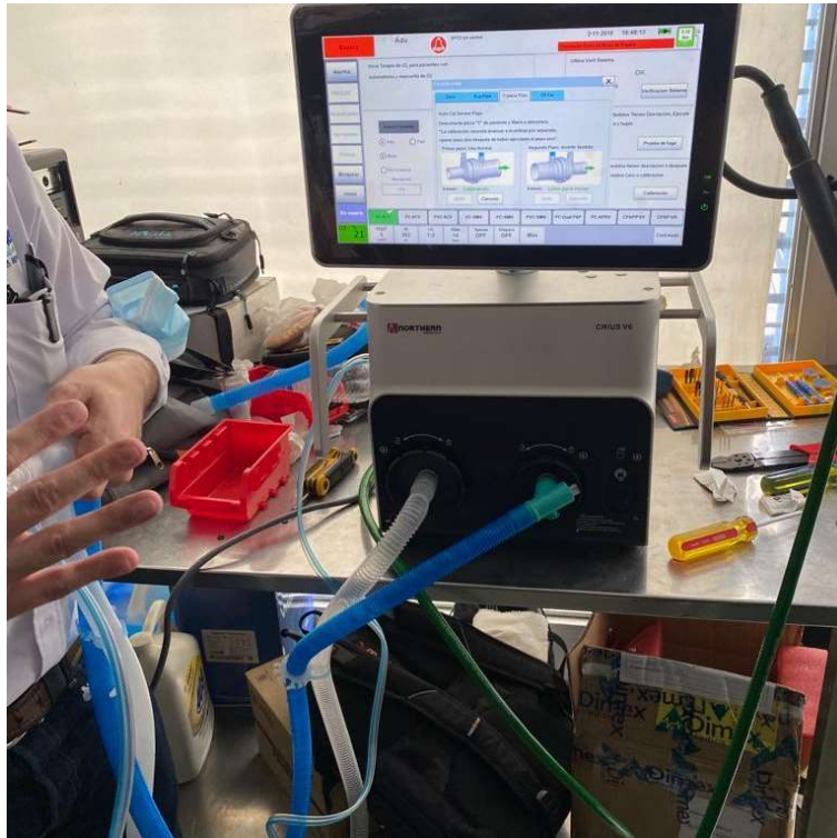
Ilustración 46. Calibración de flujo de ventiladores Northern
