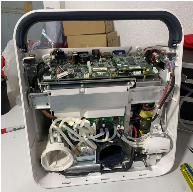
Ilustración 31. Revisión de componentes internos de ventilador Mindray
