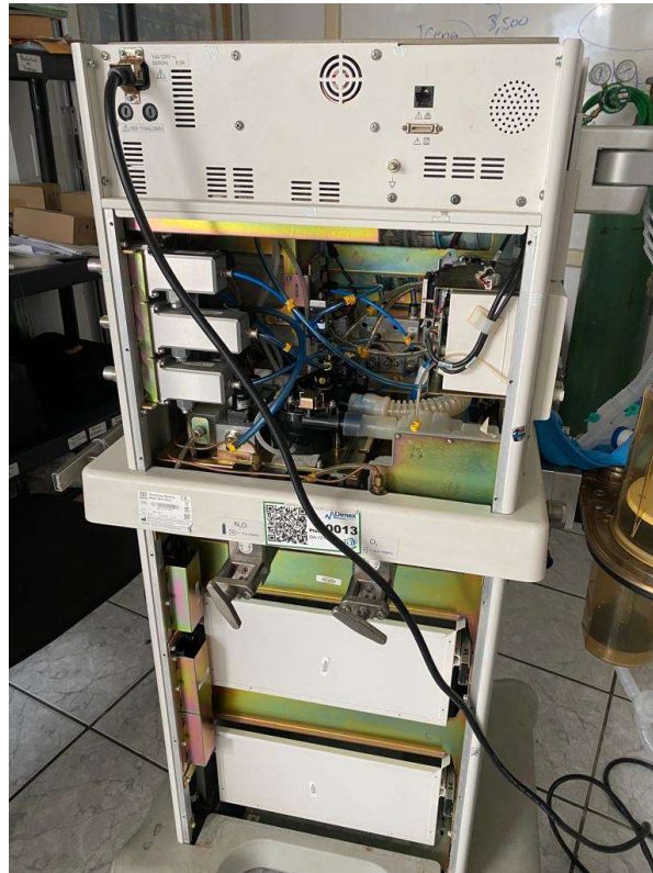
Ilustración 29. Mangueras cambiadas en máquina de anestesia
