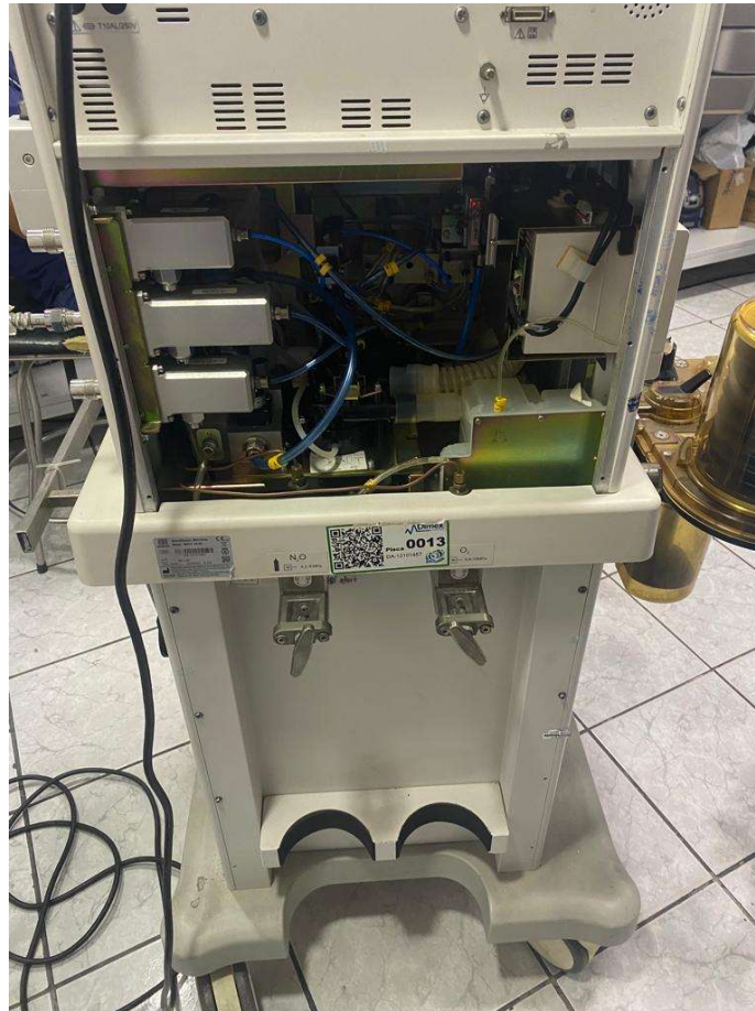
Ilustración 37. Reemplazo de mangueras de máquina de anestesia
