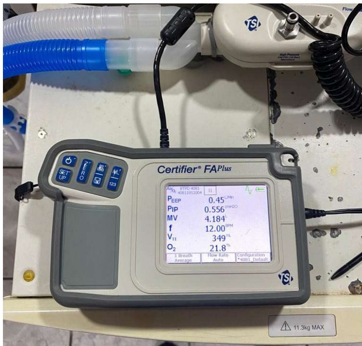
Ilustración 43. Analizador de flujo de gas - sobrepasa el error permitido.
