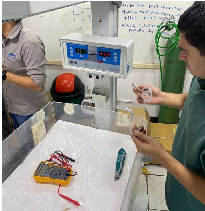
Ilustración 5. Prueba de calidad de incubadora neonatal
