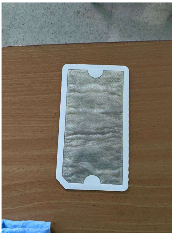
Ilustración 59. Filtro de aire en mal estado
