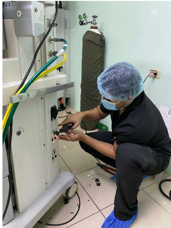
Ilustración 14. Reparación de tomacorriente
