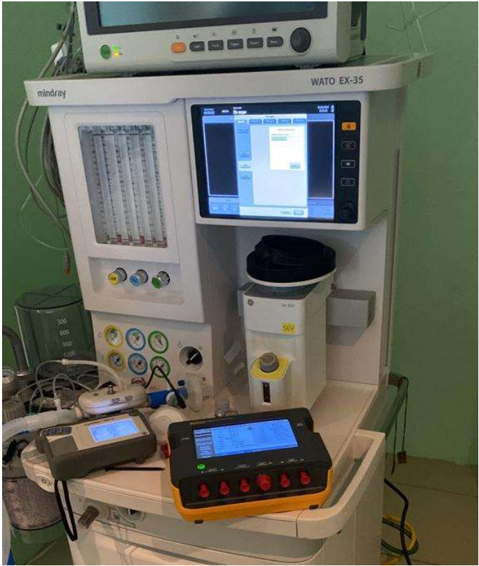
Ilustración 10. Verificación de funcionamiento de máquina de anestesia utilizando analizador Fluke
