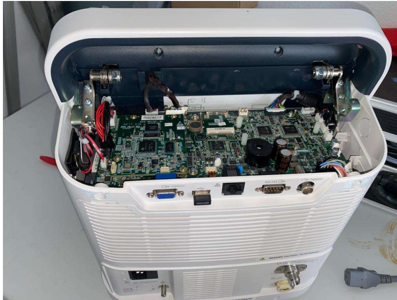
Ilustración 30. Revisión de placa electrónica ventilador Mindray
