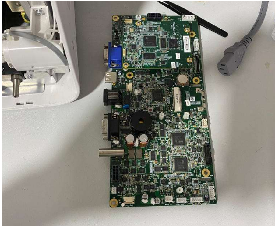
Ilustración 32. Placa electrónica de ventilador Mindray SV300
