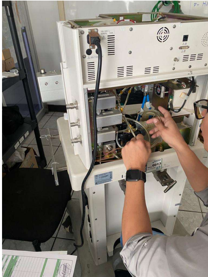
Ilustración 27. Cambio de mangueras en máquina de anestesia.
