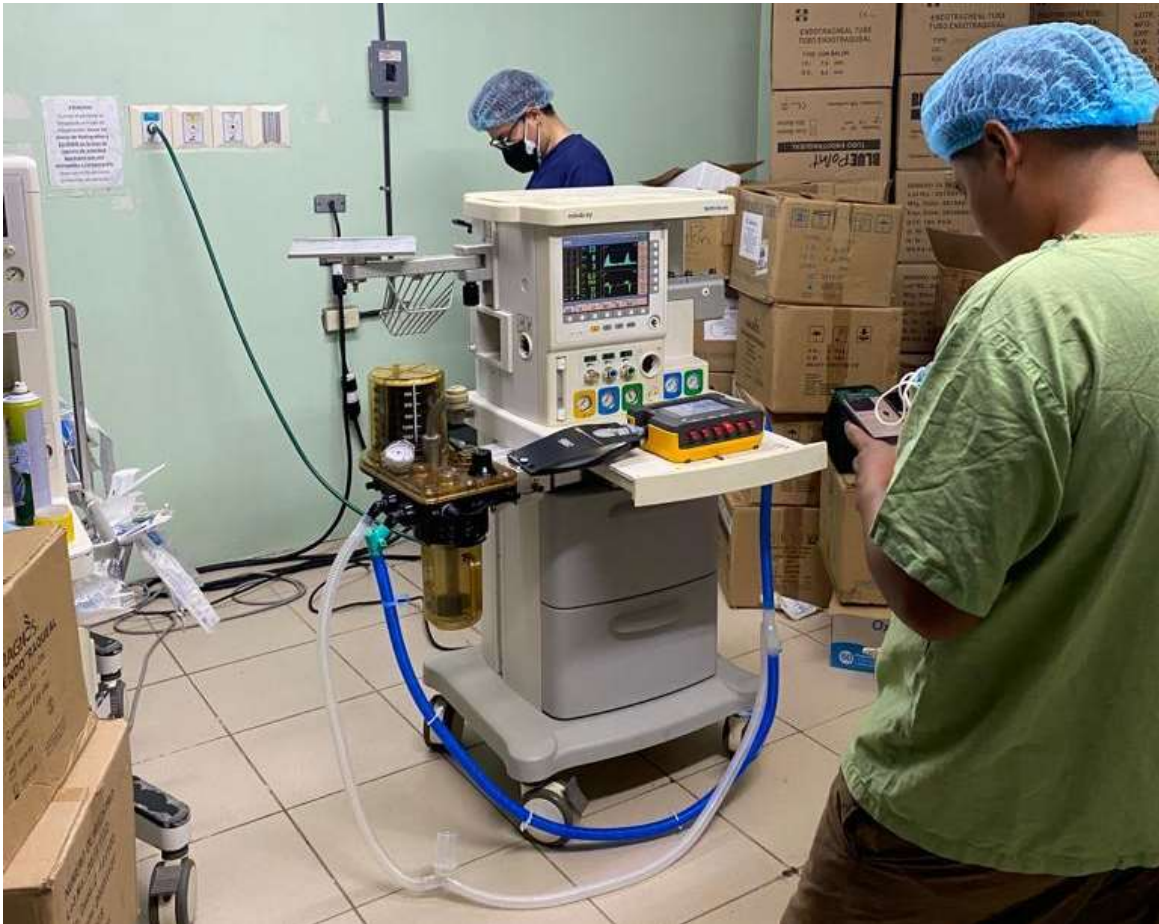
Ilustración 51. Supervisión de pruebas de funcionamiento de máquinas de anestesia
