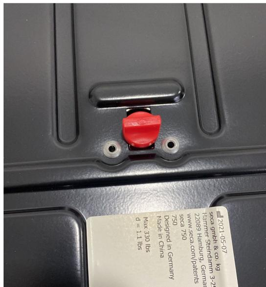
**Ilustración 13 – Pin de seguridad de SECA 750**
