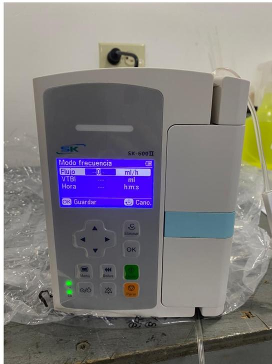
**Ilustración 17 – Configuración de infusión a paciente en modo frecuencia de bomba de infusión**
