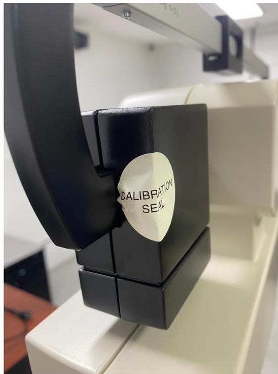
**Ilustración 9 – Sello de calibración en tornillo ajustable**
