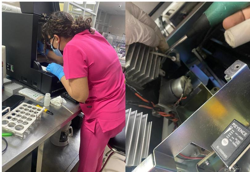
**Ilustración 25 – Desarme de equipo y corte de manguera de desagüe**
