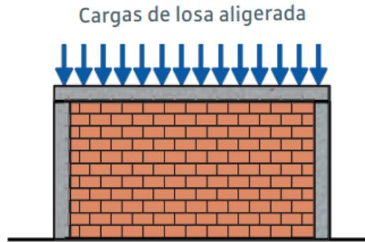
**Ilustración 8 Carga sobre solera**
