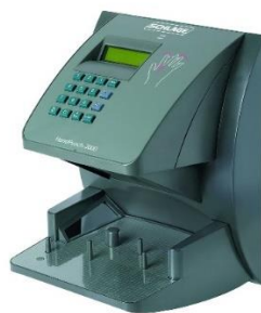
Figura 4.2 Dispositivo SCHLAGE para reconocimiento de la geometría de la mano. (Amazon, s.f.)
