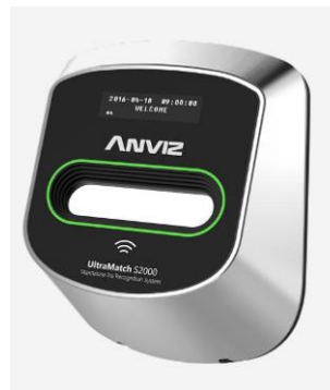
Figura 4.3 Dispositivo ANVIZ para el reconocimiento de iris. (Kimaldi, s.f.)
