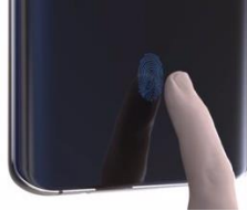
Figura 4.14 Teléfono Qualcomm con sensor de huella ultrasónico. (Español, 2015)
