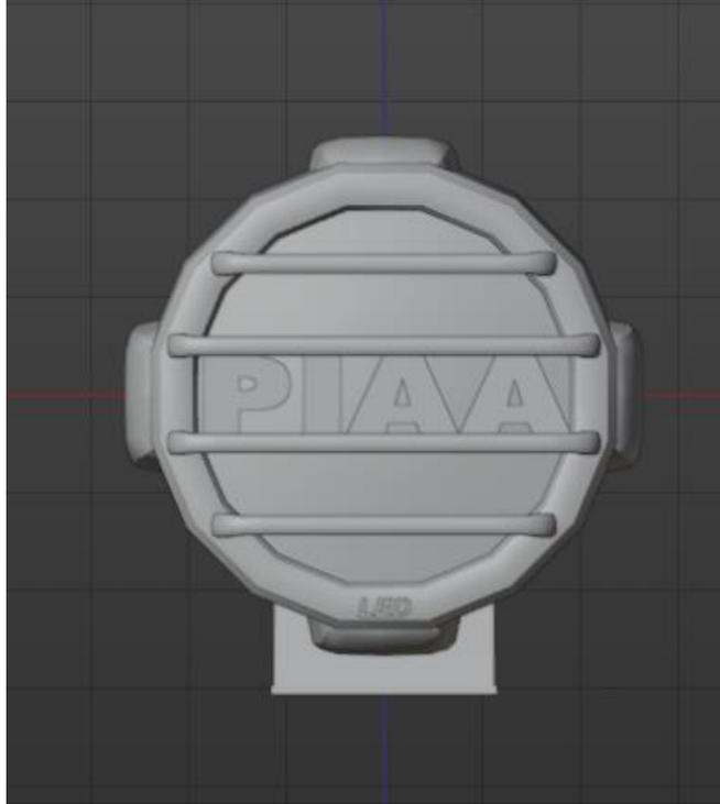
*Imagen 9. Modelo 3D halógenas PIAA 7"*
