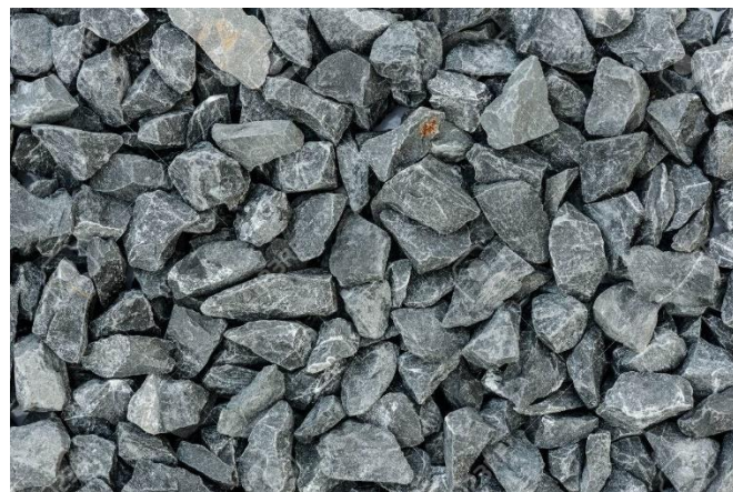
Ilustración 22. Grava como medio filtrante
