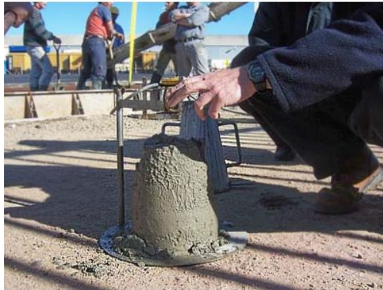
Ilustración 25. Prueba de revenimiento
