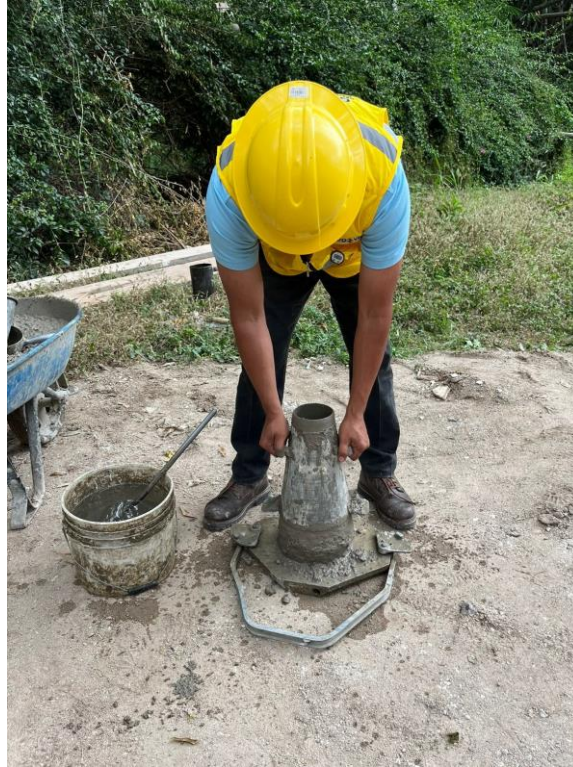
Ilustración 111. Prueba de revenimiento
