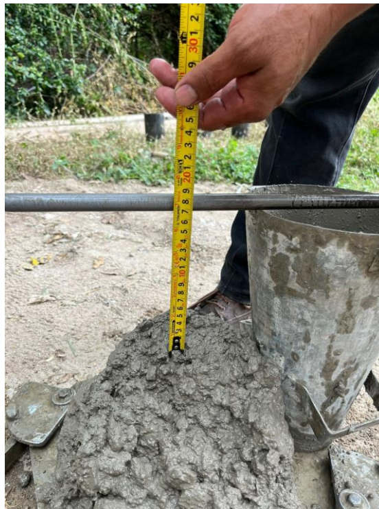
Ilustración 112. Resultado de prueba de Revenimiento
