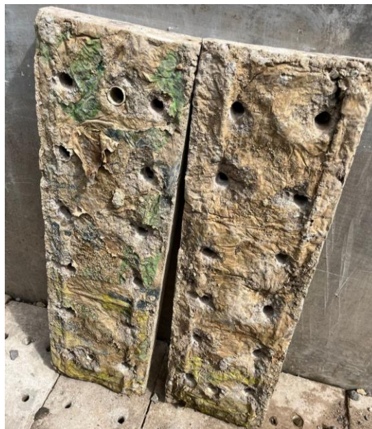
Ilustración 41. Tapaderas del falso fondo rechazadas
