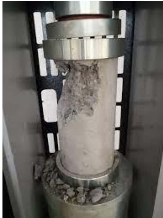
Ilustración 27. Prueba de compresión
