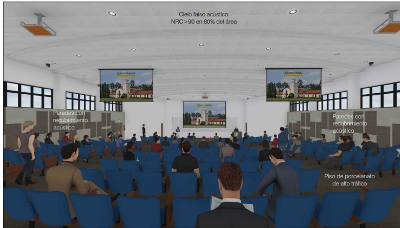
Ilustración 90. Vista frontal remodelación del Auditorio A1
