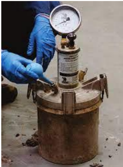
Ilustración 28. Prueba contenido de aire en concreto
