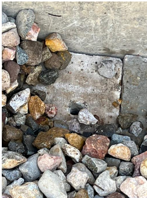
Ilustración 26. Grava 1"φ como material filtrante
