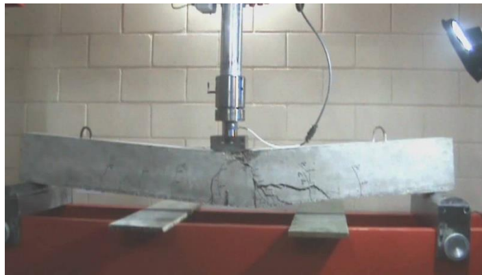
Ilustración 29. Prueba a flexión en concreto
