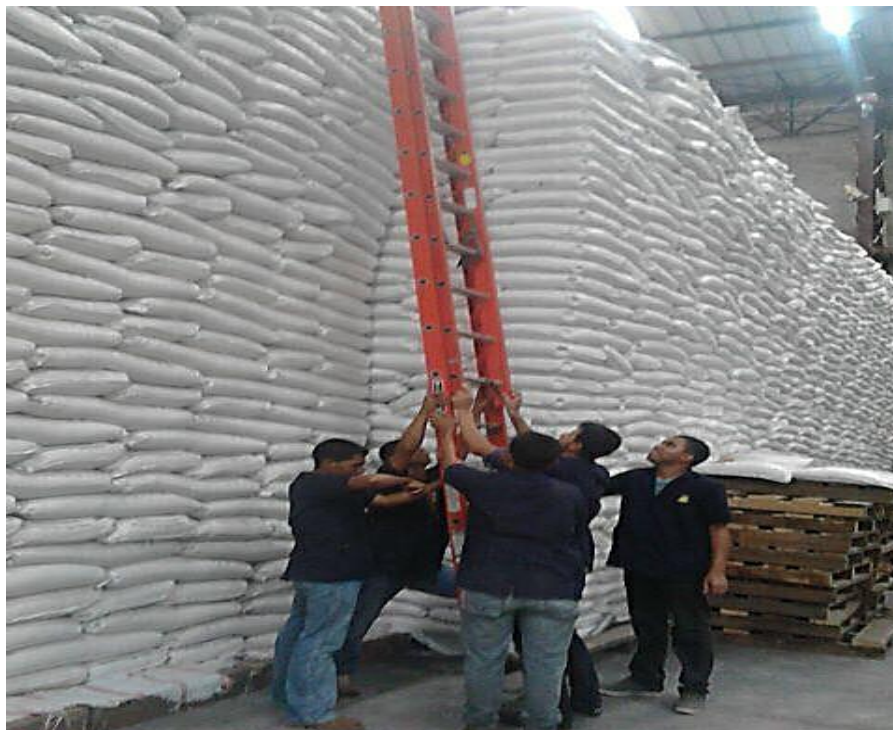
Ilustración 12. Falta de aseguramiento de escaleras en trabajos en Alturas
