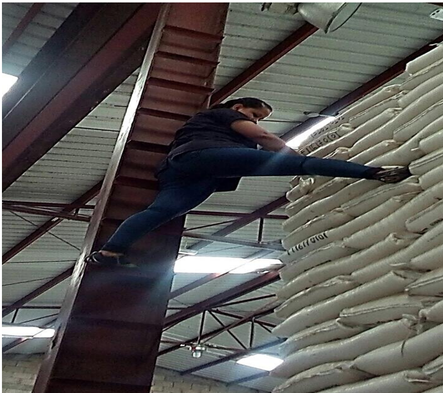
Ilustración 13. Falta de instalación de cuerdas seguras para trabajos en altura y uso de EPP adecuado para realizar ese tipo de trabajo (Arnés / cuerda de vida).
