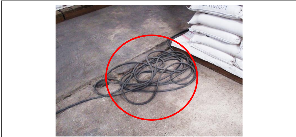
Ilustración 4. Cables y extensiones mal enrolladas y en mal estado.
