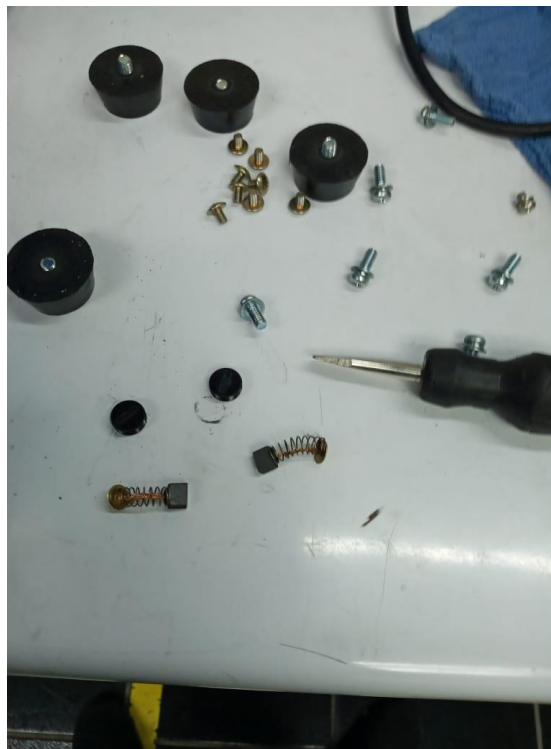
Ilustración 41. Carbones Con Desgaste
