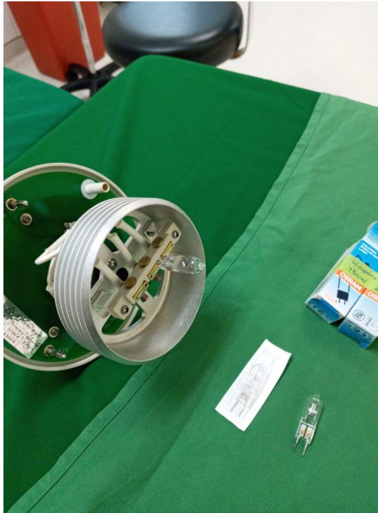
Ilustración 58. Reemplazo de Bombillo de Lampara Quirúrgica
