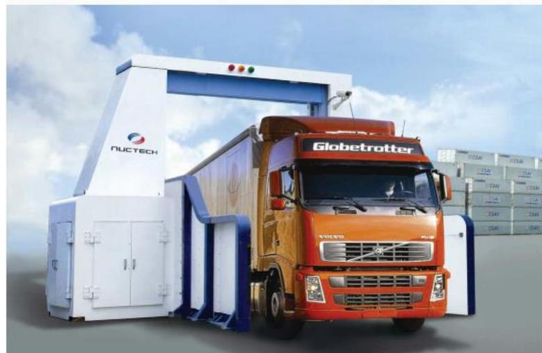
**Ilustración 4.16 Máquina Para Rayos Gamma**
