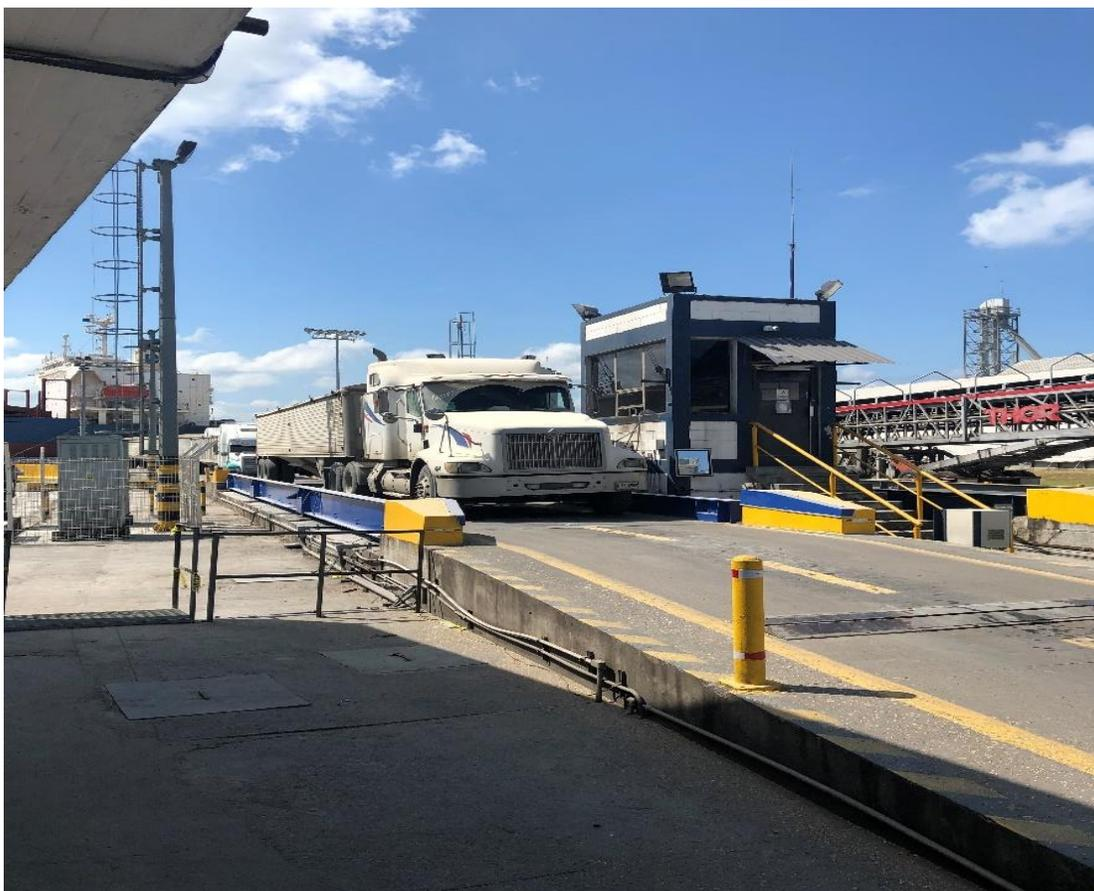
**Ilustración 10.6 Bascula De Salida De La Terminal De Granel Solido**
