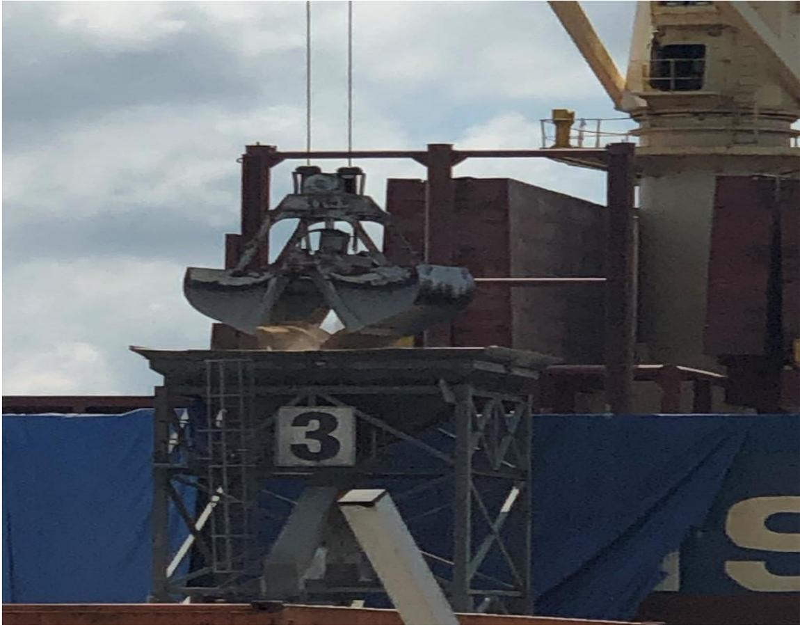
**Ilustración 10.5 Almeja Depositando Granel Solido En La Tolva**
