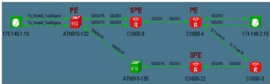
Figure 31 Diagrama de red entre CXs y ATNs
