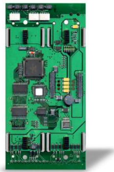
Ilustración 18 – Imagen de la placa de la interfaz RS-232
