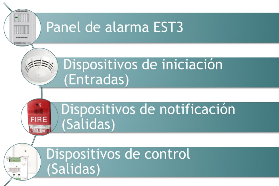
Ilustración 10 – Componentes principales del Sistema de Alarma contra Incendios.
