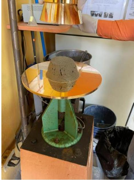
**Ilustración 40. Determinación del flujo del cemento**
