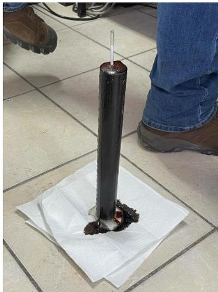
**Ilustración 57. Determinación de la densidad de aditivos**
