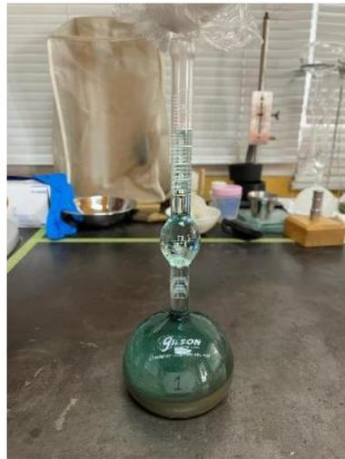
**Ilustración 75. Ensayo de densidad del cemento HE-R después de 24 horas**
