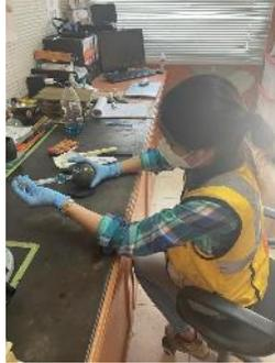
2. Se realizó el ensayo de Blaine para conocer la finura del cemento.
