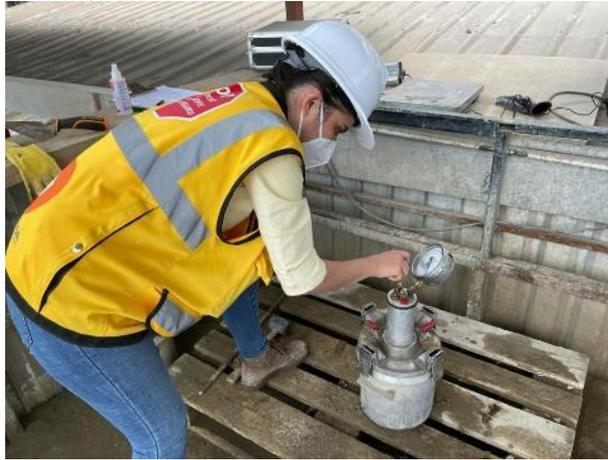
**Ilustración 55. Ensayo ASTM C231 para contenido de aire del concreto fresco**
