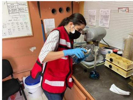
2. Se enseñó y supervisó al nuevo practicante de Ingeniería Civil en el ensayo ASTM C188.
