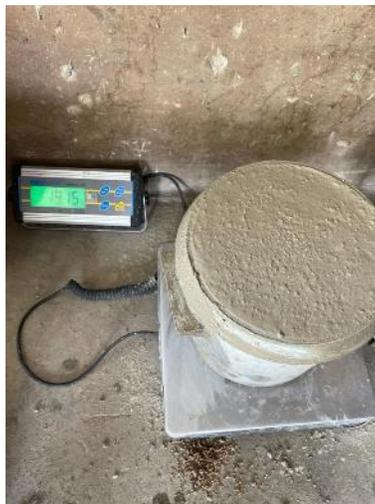
**Ilustración 77. Ensayo de densidad del concreto para experimento**
