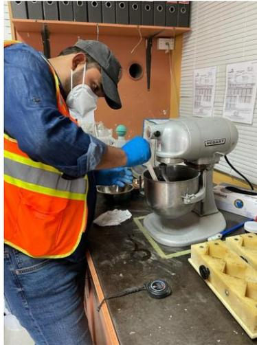
**Ilustración 178. Supervisión al nuevo practicante en ensayo ASTM C109**
