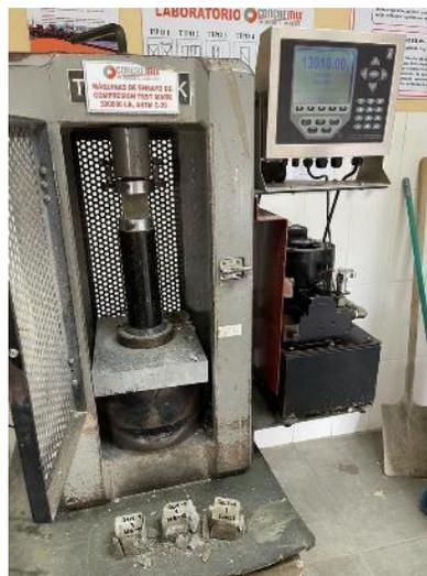
**Ilustración 73. Ensayo de compresión en cubos de cemento**
