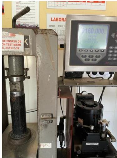
**Ilustración 156. Cubo de cemento en ensayo para determinar resistencia a la compresión**
