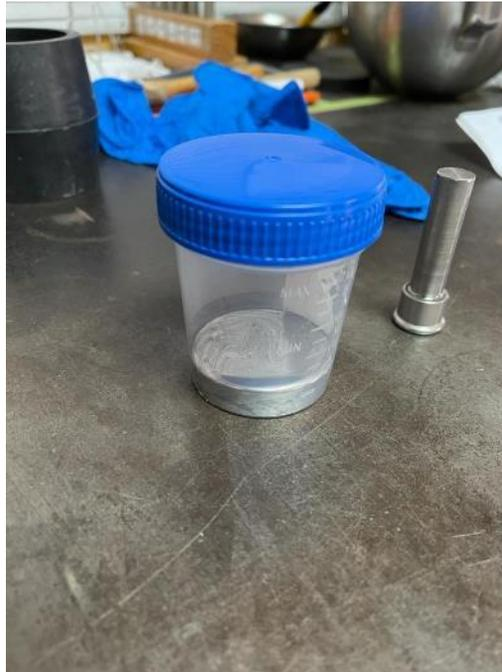
**Ilustración 52. Mercurio utilizado en calibración del permeabilímetro**
