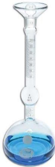
**Ilustración 20. Matraz Le Chatelier para densidad del cemento**
