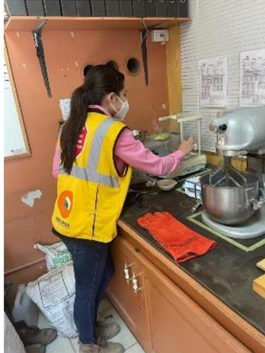
**Ilustración 97. Pesado de la muestra de cemento**
