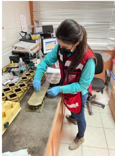
**Ilustración 177. Ensayo ASTM C109 para cubos de cemento**
