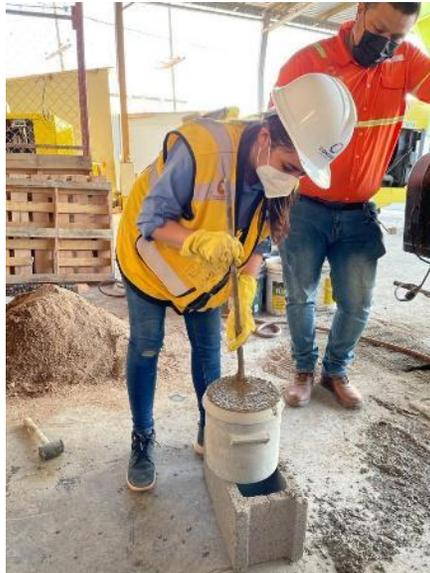
**Ilustración 66. Determinación de la densidad del concreto TREMIE en laboratorio**
