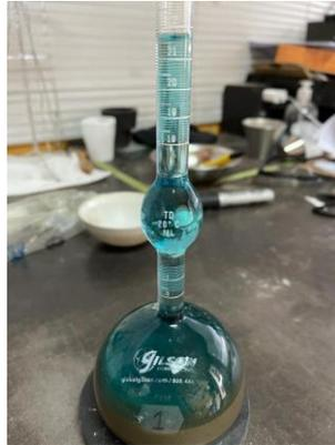
4. Se lavaron y dejaron secando dos matraces para poder realizar después el ensayo de peso específico del cemento.
