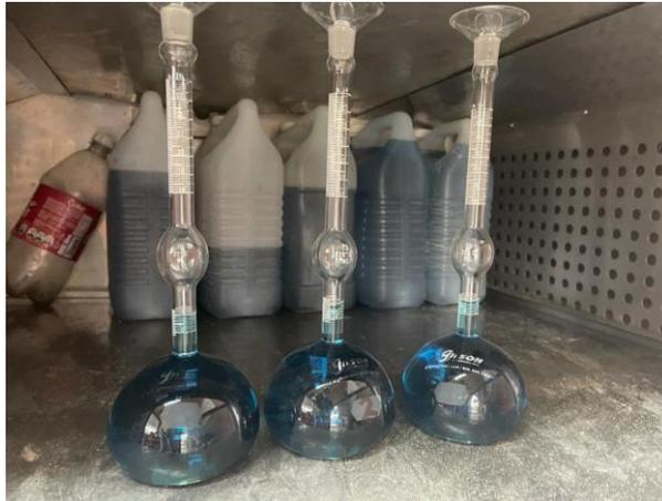
**Ilustración 118. Matraces preparados en cámara de humedad**
