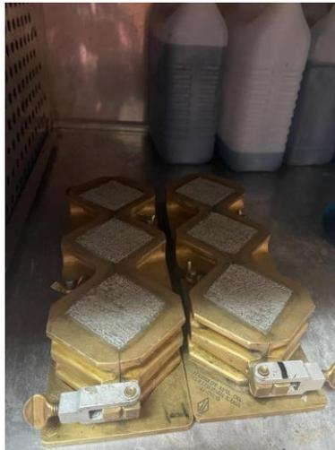
**Ilustración 159. Cubos de cemento en cámara de humedad**
