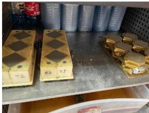
**Ilustración 71. Cubos de cemento tipo I y HE-R**
