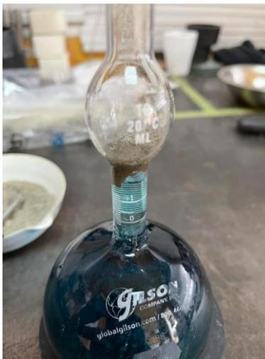
**Ilustración 164. Cemento acumulado en ensayo ASTM C188**
