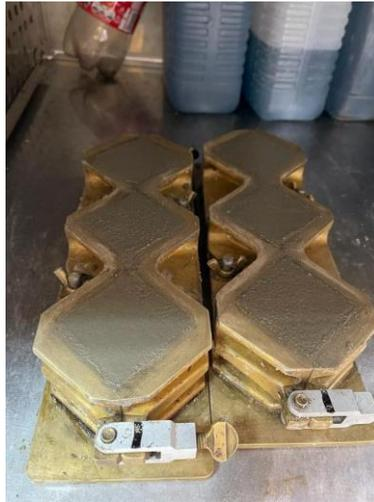
**Ilustración 128. Cubos de cementos en cámara de humedad**
