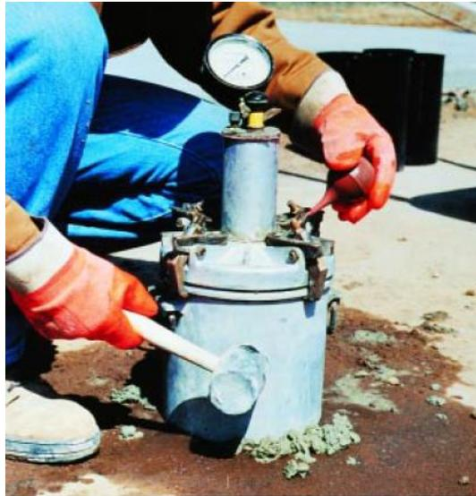
**Ilustración 26. Ensayo para determinar contenido de aire con método de presión**
