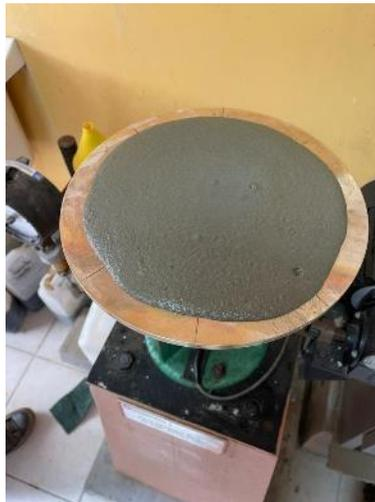
**Ilustración 94. Verificación del flujo del cemento**
