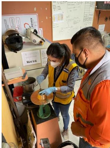
**Ilustración 127. Ensayo de flujo del cemento bajo supervisión**
