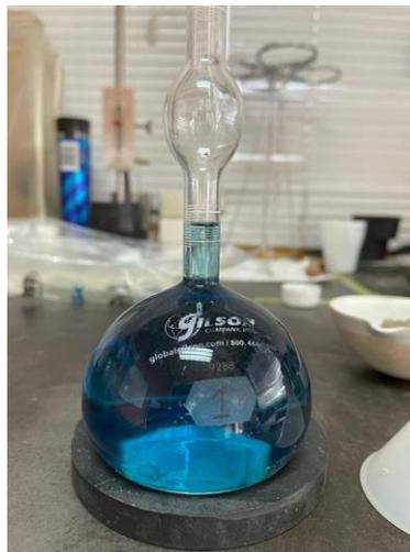
**Ilustración 163. Toma de lectura inicial en ensayo ASTM C188**
