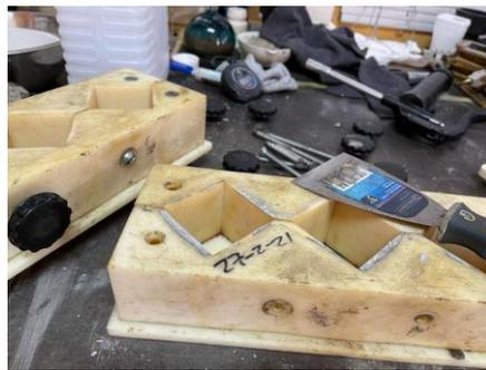
2. Se realizó el ensayo ASTM C109 con tres muestras de cemento distintas.
