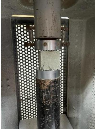
**Ilustración 43. Ensayo de resistencia a la compresión de cubos de cemento**
