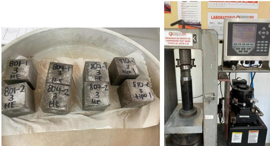
**Ilustración 140. Cubos para ensayo de resistencia a la compresión**
