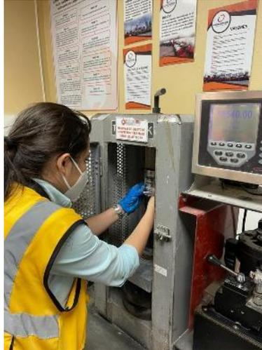
**Ilustración 89. Ensayo en cubos de cemento HE-R**
