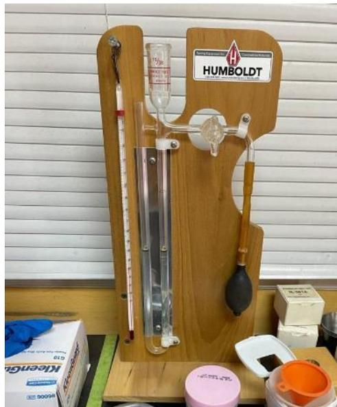
**Ilustración 51. Permeabilímetro (aparato Blaine)**
