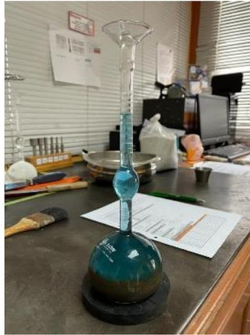
**Ilustración 72. Ensayo de densidad de cemento HE-R**
