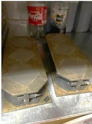
**Ilustración 88. Cubos de cemento**
