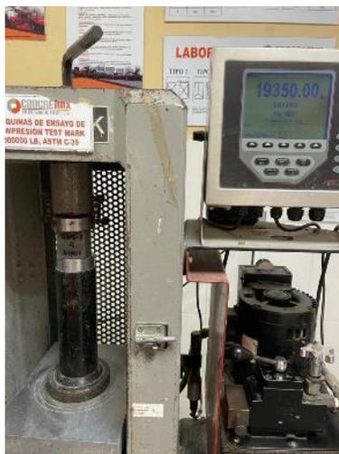
**Ilustración 95. Prueba de compresión en cubos de cemento**
