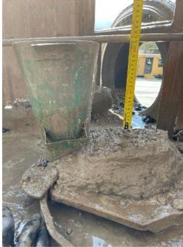
**Ilustración 84. Ensayo ASTM C143 en concreto fresco**
