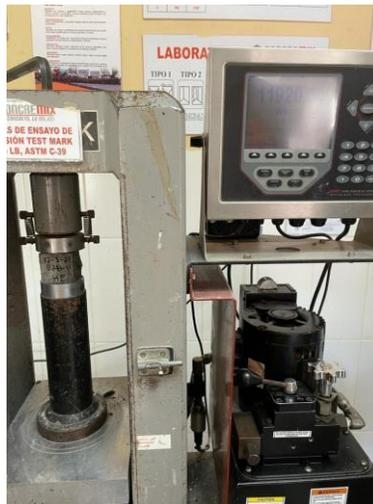
**Ilustración 149. Determinación de resistencia a la compresión de cubos de cemento**
