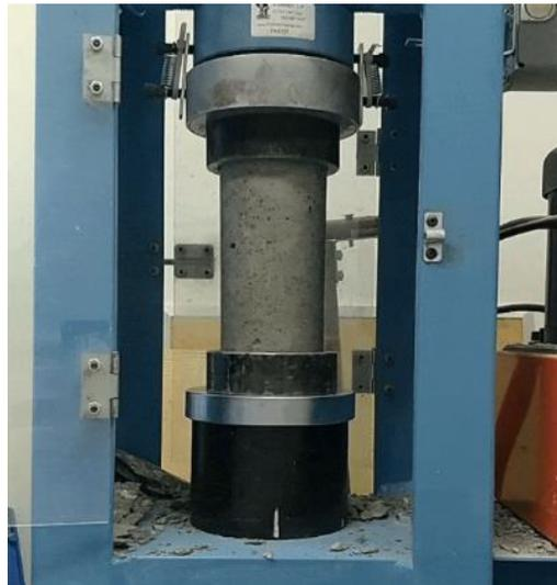
**Ilustración 27. Ensayo de resistencia a la compresión de cilindros de concreto**
