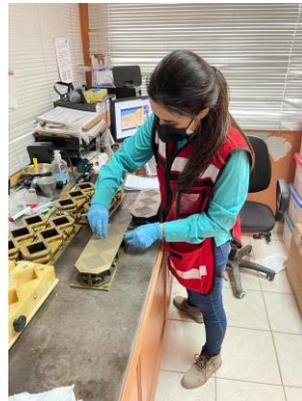
2. Se enseñó y supervisó al nuevo practicante de Ingeniería Civil en el ensayo ASTM C109.
