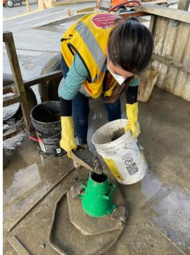
**Ilustración 120. Determinación del revenimiento del concreto recién mezclado**
