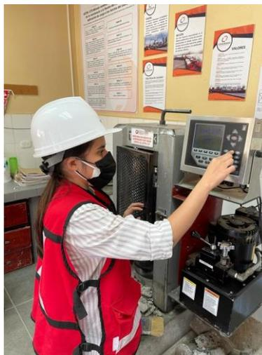
**Ilustración 182. Manejo de máquina de compresión en ensayo en cubos de cemento**
