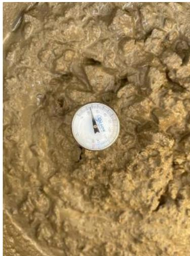
**Ilustración 83. Ensayo ASTM C1064 en concreto fresco**
