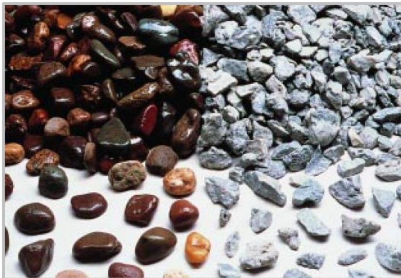
**Ilustración 15. Agregado grueso: grava redondeada (izquierda) y piedra triturada (derecha)**
