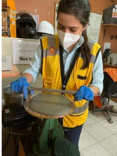
**Ilustración 87. Flujo del cemento**
