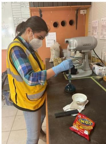
**Ilustración 117. Ingreso de cemento en matraz para ensayo de peso específico del cemento**
