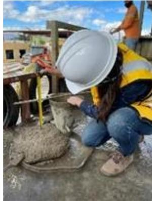
2. Aplicación de ASTM C138/138M-17a para determinar la densidad del concreto.
