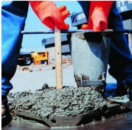
**Ilustración 24. Ensayo de revenimiento para la consistencia del concreto**
