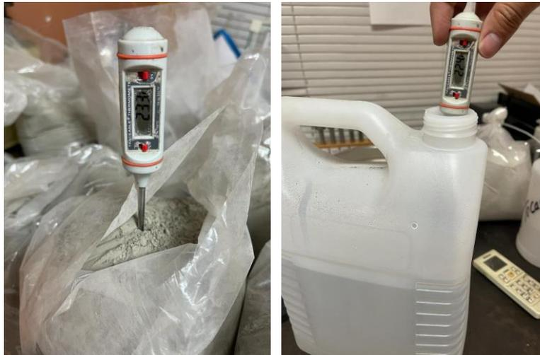
**Ilustración 109. Toma de temperatura del cemento y agua destilada**
