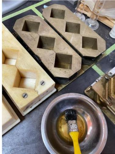
**Ilustración 152. Engrasado de moldes para cubos de cemento**
