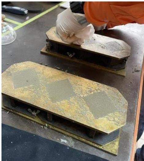
**Ilustración 41. Preparación de cubos de cemento**
