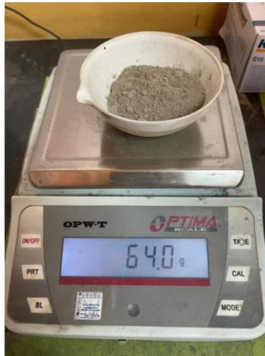
**Ilustración 162. Muestra de cemento para ensayo ASTM C188**
