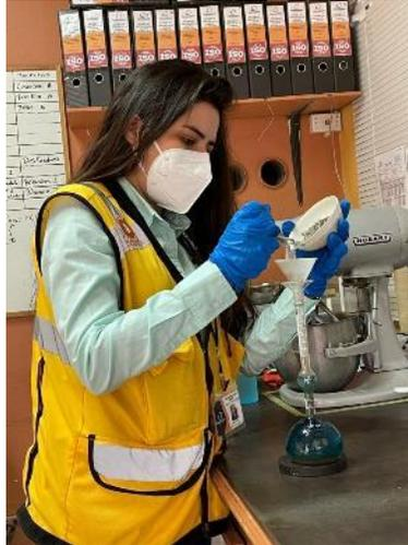
**Ilustración 99. Ensayo de densidad del cemento**
