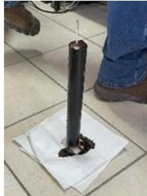
2. Se realizó el ensayo de flujo del cemento (ASTM C230) y ensayo de cubos de cemento para determinar su resistencia a la compresión (ASTM C109).
