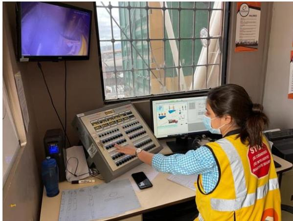
**Ilustración 130. Dosificación de mezclas de concreto**
