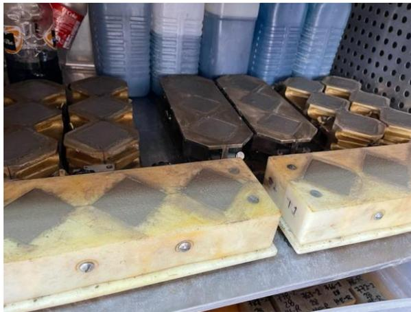
**Ilustración 107. Cubos de cemento elaborados según ASTM C109**
