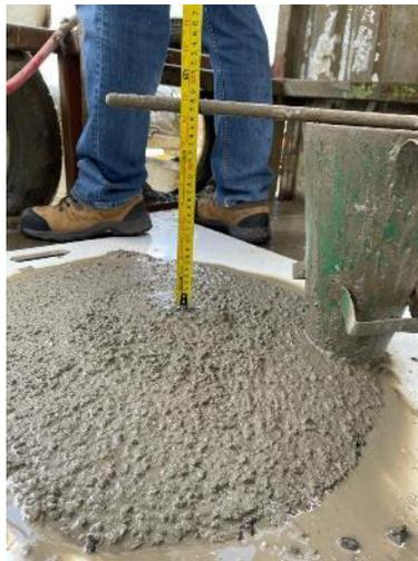
**Ilustración 79. Determinación del revenimiento en concreto fresco**
