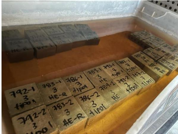
**Ilustración 112. Cubos de cemento reposando en agua dentro de cámara de humedad**
