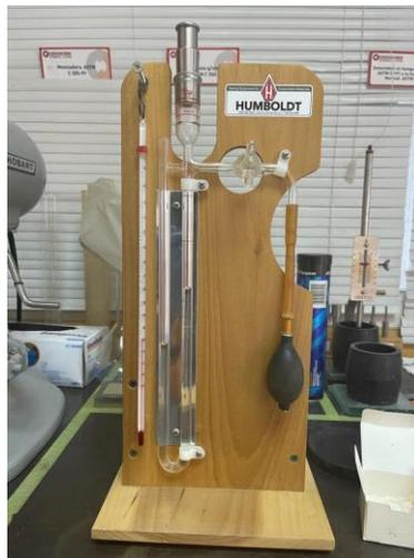
**Ilustración 119. Permeabilímetro de Blaine para conocer finura del cemento**
