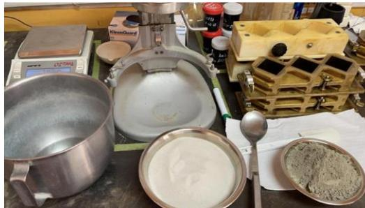
**Ilustración 184. Materiales para ensayo ASTM C109**
