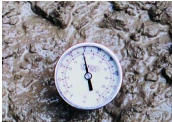
**Ilustración 23. Ensayo de temperatura en el concreto fresco**
