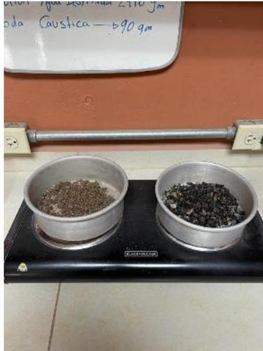
**Ilustración 76. Cálculo de contenido de humedad de agregados finos (izquierda) y gruesos (derecha)**
