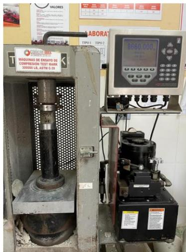
**Ilustración 129. Ensayo ASTM C109 para cálculo de resistencia a la compresión**
