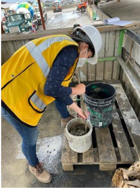
**Ilustración 38. Ensayo de densidad ASTM C138**
