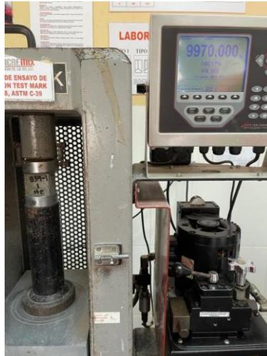
**Ilustración 160. Ensayo de resistencia a la compresión de cubos de cemento ASTM C109**
