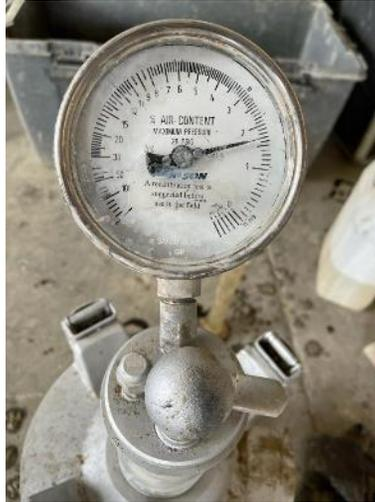
**Ilustración 78. Ensayo de contenido de aire del concreto para experimento**
