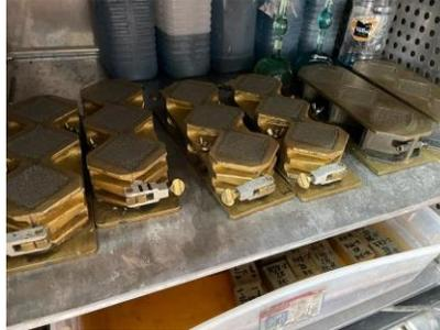
2. Se ensayaron cubos de cemento según ASTM C109.
