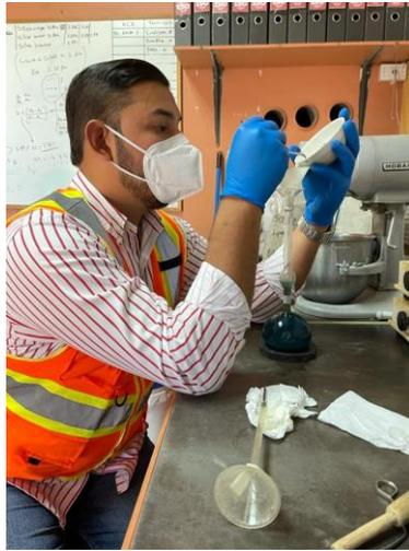
**Ilustración 181. Supervisión al nuevo practicante en ensayo ASTM C188**
