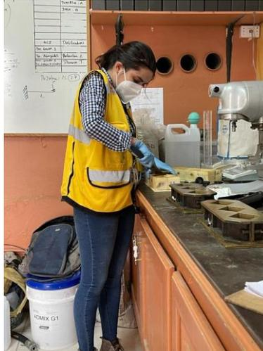
**Ilustración 126. Limpieza de moldes para ensayo de cubos de cemento**
