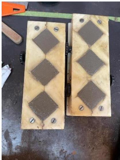
**Ilustración 59. Cubos de cemento**
