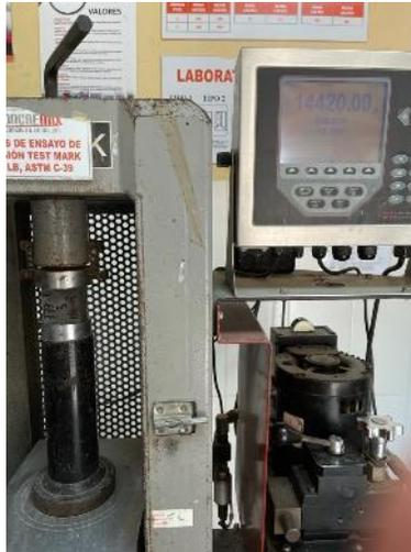
**Ilustración 100. Cubos de cemento a compresión**
