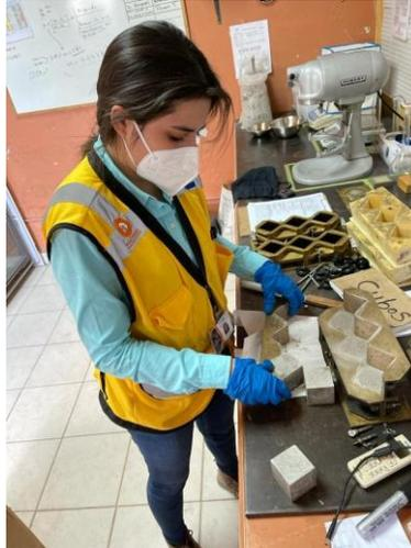
**Ilustración 114. Desencofrado de cubos de cemento**
