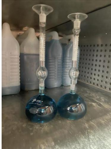
**Ilustración 158. Matraces con queroseno en cámara de humedad**
