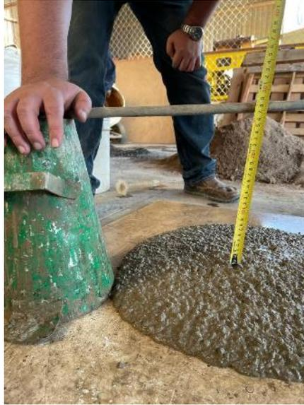
**Ilustración 65. Revenimiento del concreto TREMIE en laboratorio**
