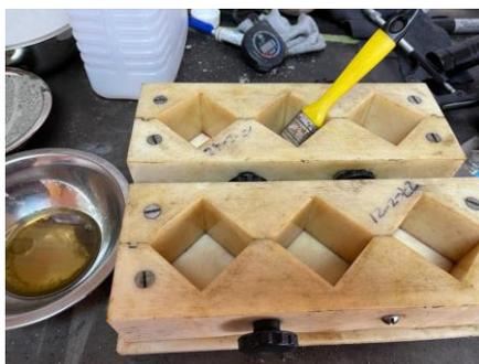
**Ilustración 171. Aplicación de aceite en moldes para cubos de cemento**
