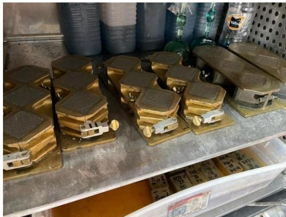
**Ilustración 145. Cubos de cemento elaborados de acuerdo con ASTM C109**
