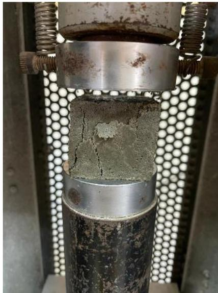
**Ilustración 70. Cubos de cemento a ensayados a compresión**
