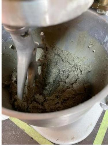
**Ilustración 93. Mezcla de cemento con arena Ottawa y agua**
