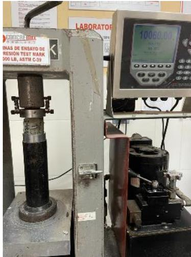
**Ilustración 98. Ensayo de compresión en cubos de cemento**
