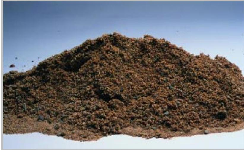
**Ilustración 14. Agregado fino (arena)**
