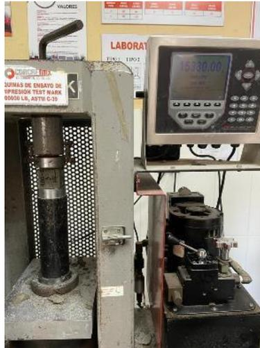
**Ilustración 105. Ensayos en cubos de cemento a 3 días**
