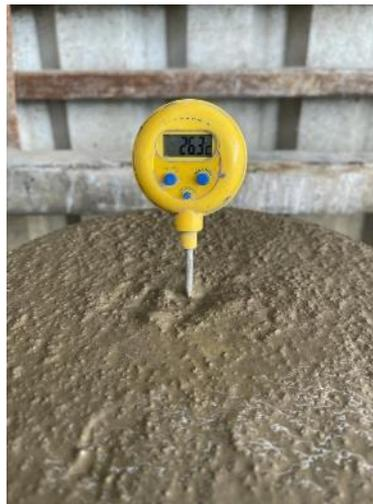
**Ilustración 102. Temperatura del concreto fresco**
