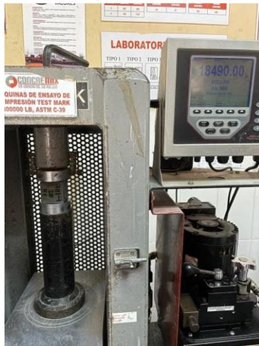
**Ilustración 174. Determinación de resistencia a la compresión del cemento según norma ASTM C109**
