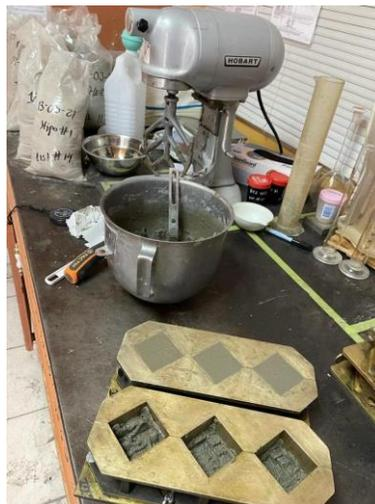
**Ilustración 153. Pasta del mortero en los moldes para ensayo ASTM C109**
