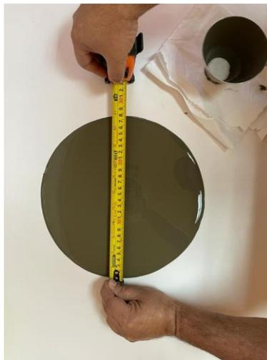
**Ilustración 123. Medición de extensibilidad de la pasta de cemento**
