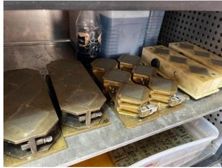
**Ilustración 172. Cubos de cemento elaborados según norma ASTM C109 en cámara de humedad**
