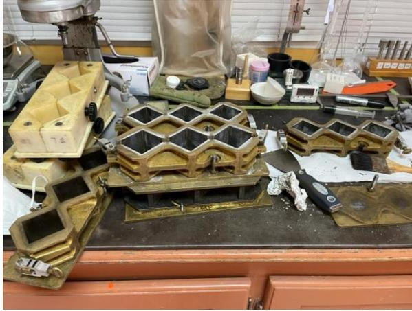
**Ilustración 110. Limpieza de moldes para cubos de cemento**
