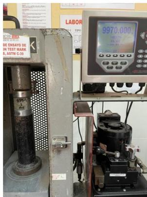
2. Se recibió al personal de ARGOS para que realizaran el ensayo ASTM C109 de cubos de cemento con muestras de 4 fechas diferentes.
