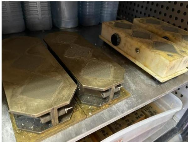
**Ilustración 113. Cubos de cemento elaborados según norma ASTM C109**
