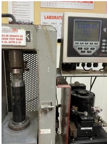
**Ilustración 167. Ensayo de cubos de cemento a 28 días según norma ASTM C109**
