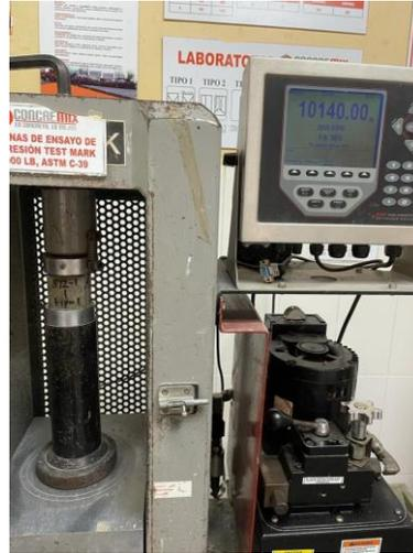
**Ilustración 132. Determinación de la resistencia a la compresión de cubos de cemento**
