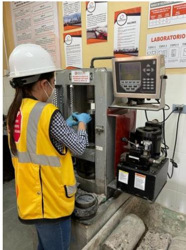
**Ilustración 125. Colocación de cubos de cemento en máquina de compresión**
