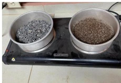
**Ilustración 64. Determinación de humedades en agregados**
