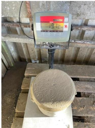
**Ilustración 121. Pesado del molde con concreto para ensayo ASTM C138**
