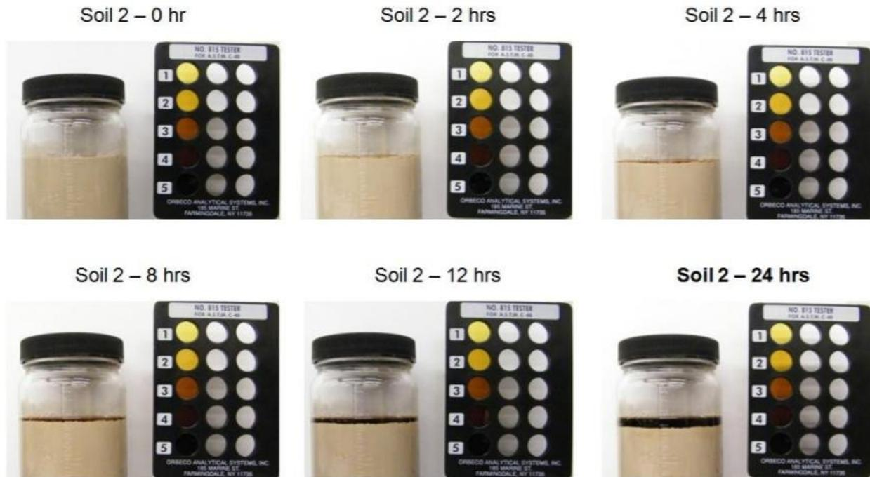
**Ilustración 18. Ensayo ASTM C40 de impurezas orgánicas en agregado fino**
