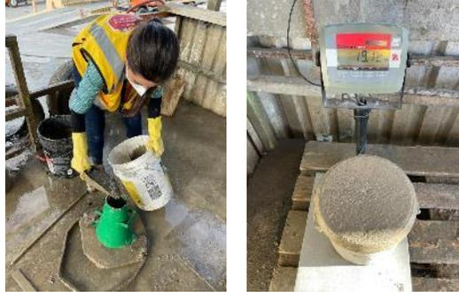
2. Se realizó un ensayo para ver la extensibilidad de una pasta de cemento con y sin aditivo de Lazarus, con personal de Lazarus.
