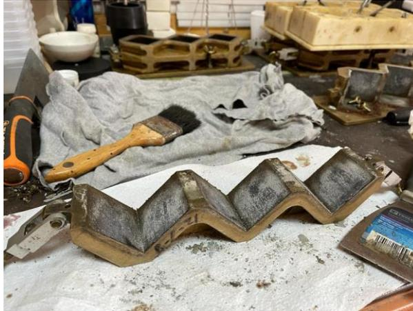
**Ilustración 168. Limpieza y removido de mortero en moldes para ensayo ASTM C109**
