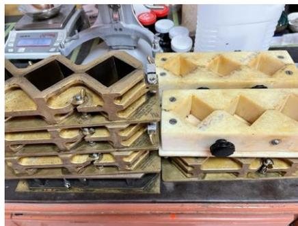
**Ilustración 175. Preparación de moldes utilizados en cubos de cemento**
