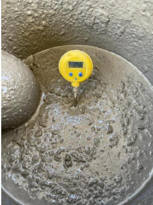
**Ilustración 49. Concreto TREMIE de 42 MPa**
