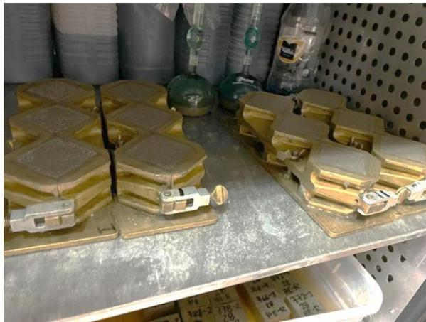
**Ilustración 131. Cubos elaborados según norma ASTM C109**
