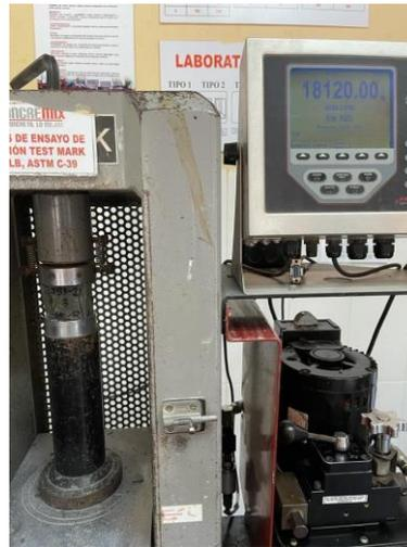
**Ilustración 124. Cálculo de resistencia a la compresión de cubos de cemento**
