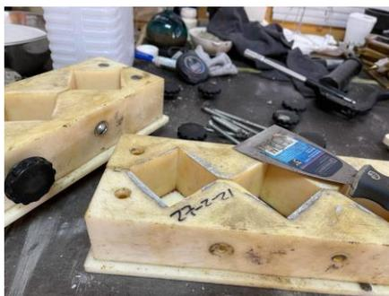
**Ilustración 170. Limpieza de moldes utilizados cubos de cemento**
