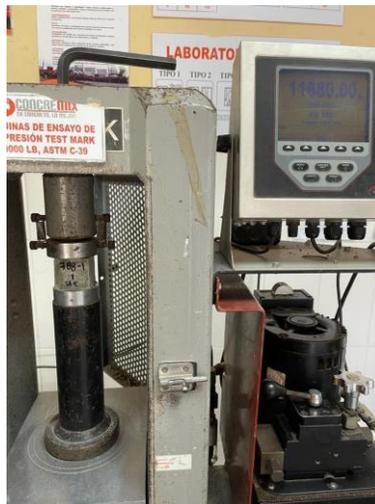
**Ilustración 111. Ensayo de resistencia a la compresión de cubos de cemento a 1 día**
