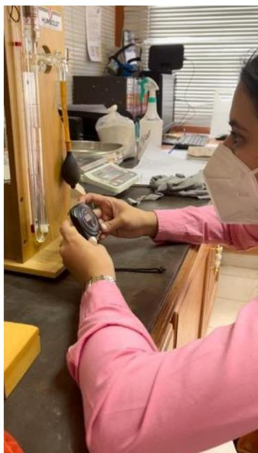
**Ilustración 96. Ensayo de fineza con aparato de Blaine**
