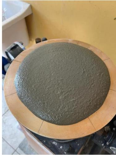
**Ilustración 108. Ensayo ASTM C230 flujo para pruebas de cemento**
