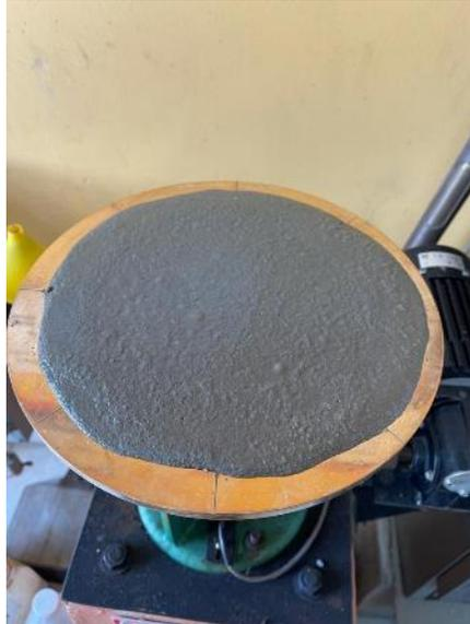
**Ilustración 58. Prueba de flujo del cemento**
