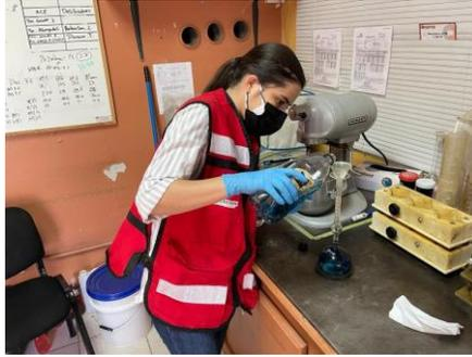
**Ilustración 180. Ensayo ASTM C188 para peso específico del cemento**
