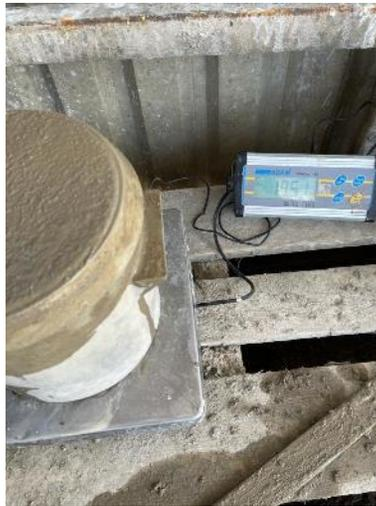
**Ilustración 85. Ensayo ASTM C138 en concreto fresco**
