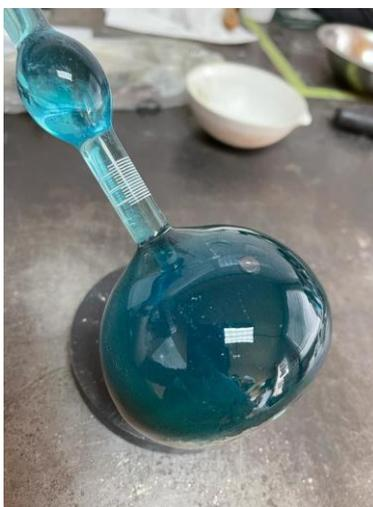
**Ilustración 165. Aire atrapado en el matraz en ensayo ASTM C188**
