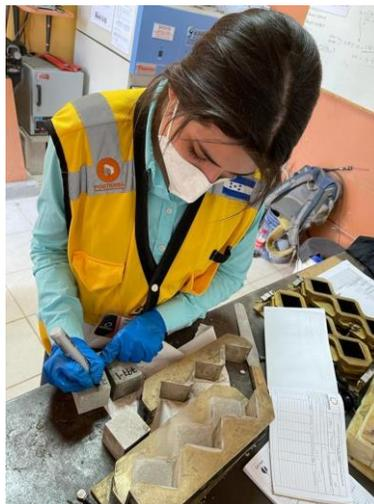
**Ilustración 115. Rotulación de cubos de cemento previo a ser ensayados a compresión**
