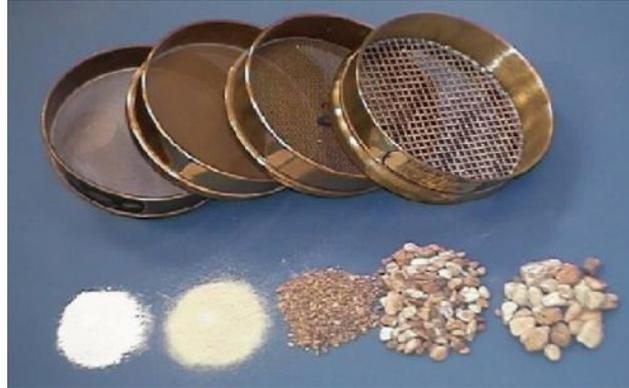
**Ilustración 17. Ensayo de granulometría en agregados para el concreto**
