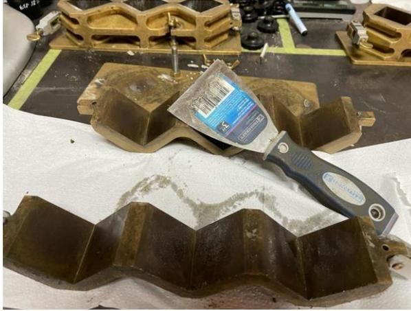
**Ilustración 150. Limpieza de moldes para elaboración de cubos de cemento**
