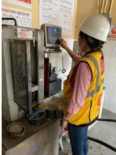
**Ilustración 82. Resistencia a la compresión de cubos de cemento**
