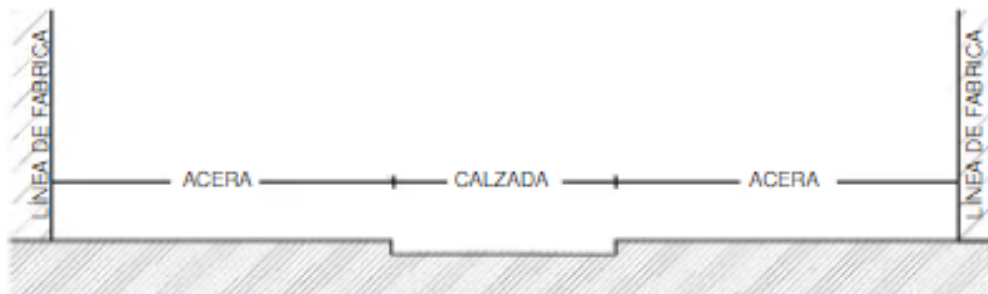
Ilustración 4- Estructura básica de una calle.
