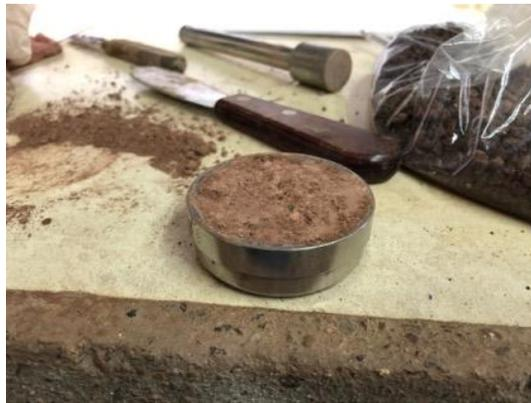
**Ilustración 59. Realización de probeta para un ensayo de corte directo**
