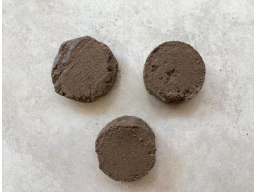
**Ilustración 31. Resultado ensayo de corte directo en muestra de suelo de Viviendas Morazán.**
