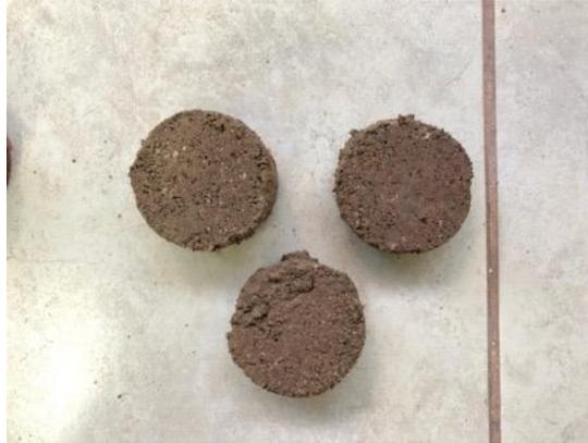
**Ilustración 35. Resultado de probeta luego de ensayo de corte directo**
