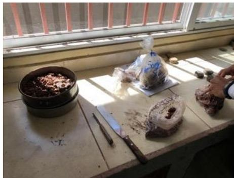
**Ilustración 25. Preparación de muestras de suelo para probetas de corte directo**
