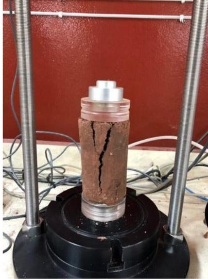
**Ilustración 26. Prueba de compresión simple en suelo cohesivo**
