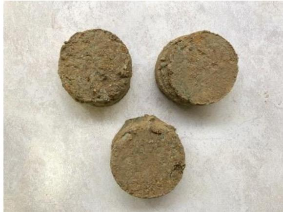
**Ilustración 38. Resultado de probeta de suelo arenoso de ensayo de corte directo**
