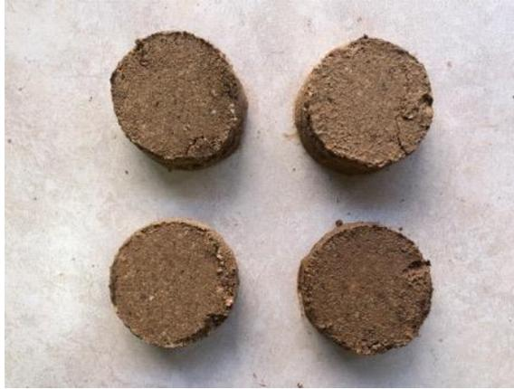
**Ilustración 63. Resultado de probetas de ensayo de corte directo en un limo con arena.**
