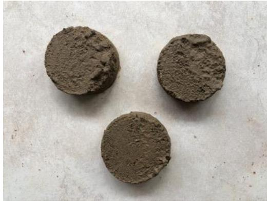
**Ilustración 67. Resultado de probetas de ensayo de corte directo en suelo arenoso limoso.**
