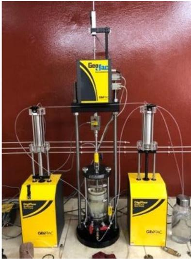
**Ilustración 69. Equipo de ensayo triaxial en estado confinado no drenado.**
