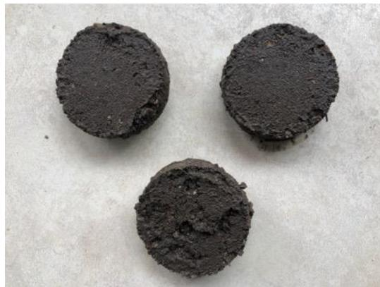
**Ilustración 68. Resultado de probetas de ensayo de corte directo en suelo arenoso.**
