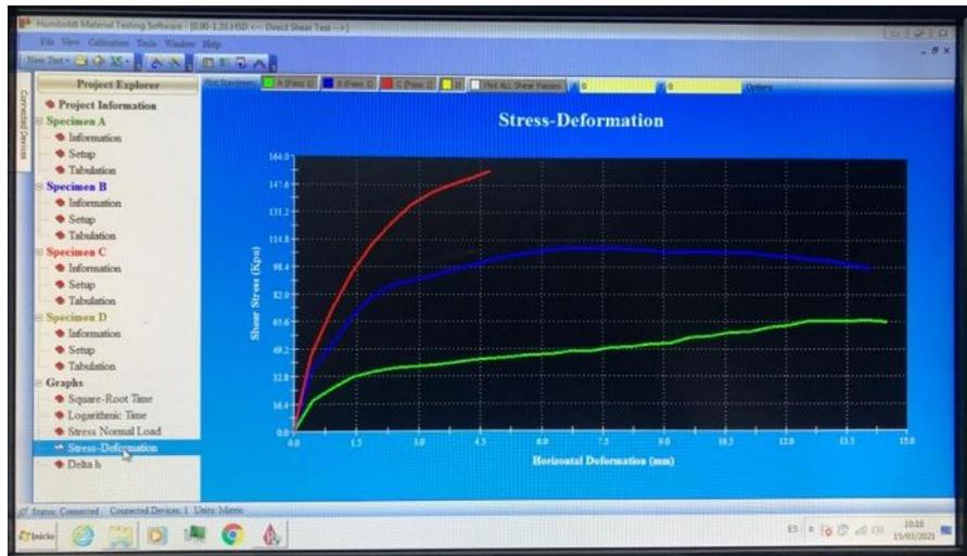
**Ilustración 57. Gráficos de esfuerzo cortante vs deformación horizontal en ensayo de corte directo**
