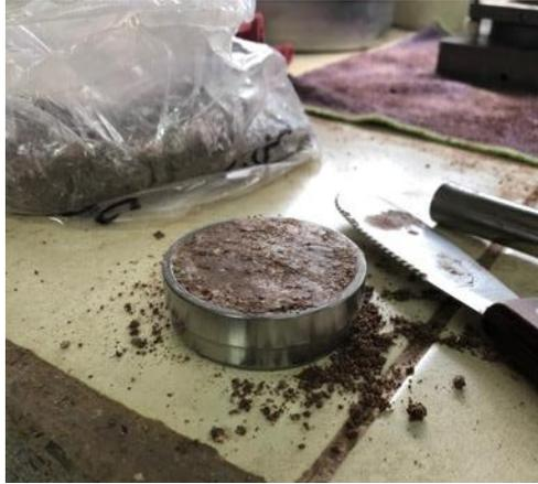
**Ilustración 53. Elaboración de probetas para ensayo de corte directo**
