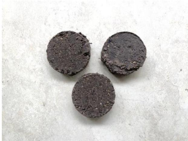
**Ilustración 43. Resultados de probetas de ensayo de corte directo en un suelo arenoso.**
