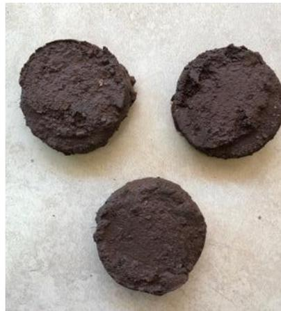
**Ilustración 29. Resultado probetas de ensayo de corte directo en proyecto Palmerola.**
