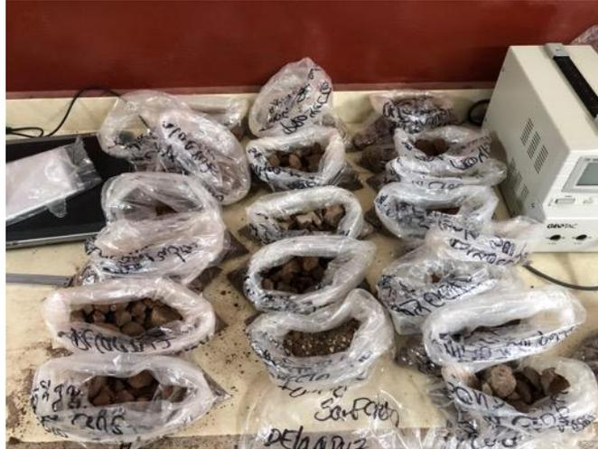
**Ilustración 54. Inspección visual preliminar de características del suelo en un ensayo SPT**
