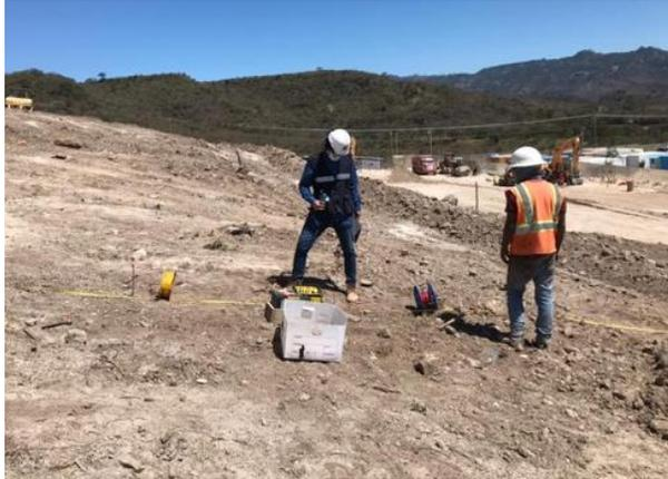
**Ilustración 34. Desarrollo de ensayo eléctrico-vertical**
