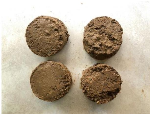
**Ilustración 56. Resultado de probetas de ensayo de corte directo en suelo arena limoso.**
