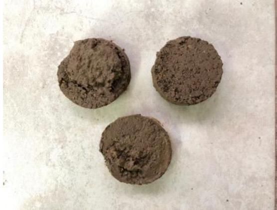
**Ilustración 55. Resultado de probetas de ensayo de corte directo en suelo limo arenoso.**
