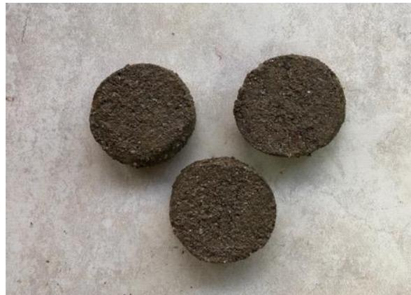
**Ilustración 23. Resultado de probetas en ensayo de corte directo**
