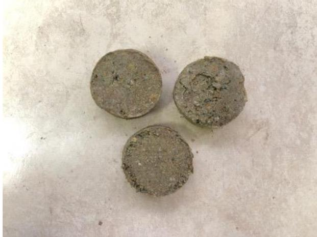
**Ilustración 44. Resultado de probetas de ensayo de corte directo en una arena arcillosa.**
