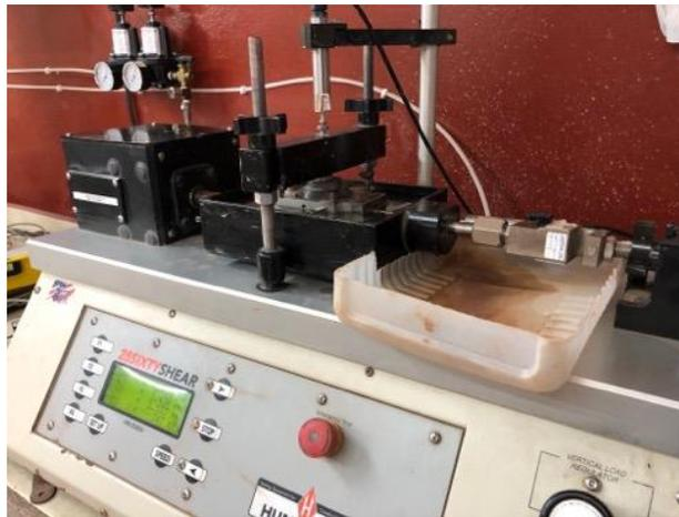
**Ilustración 37. Equipo HUMBOLDT HM-2560A para ensayo de corte directo**
