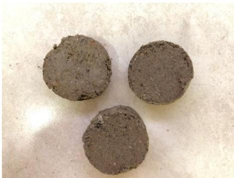
**Ilustración 33. Resultado de probetas de ensayo de corte directo en arena arcillosa**
