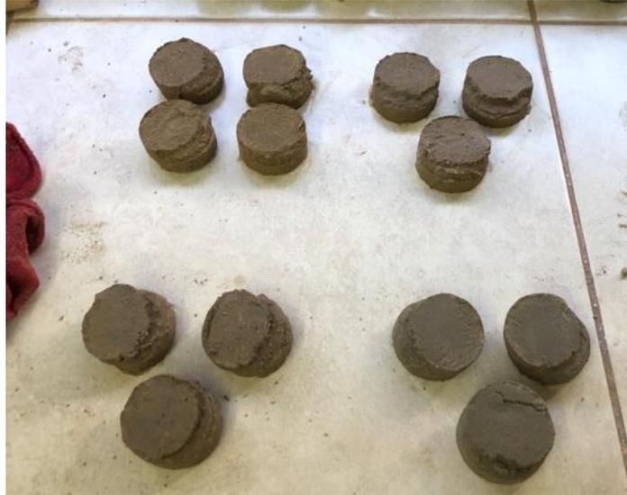
**Ilustración 48. Resultado de probetas en 4 ensayos de corte directo**
