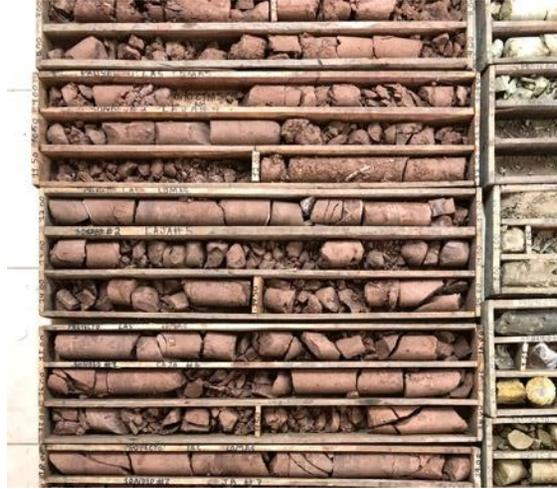
**Ilustración 39. Sondeo de perforación por rotación**
