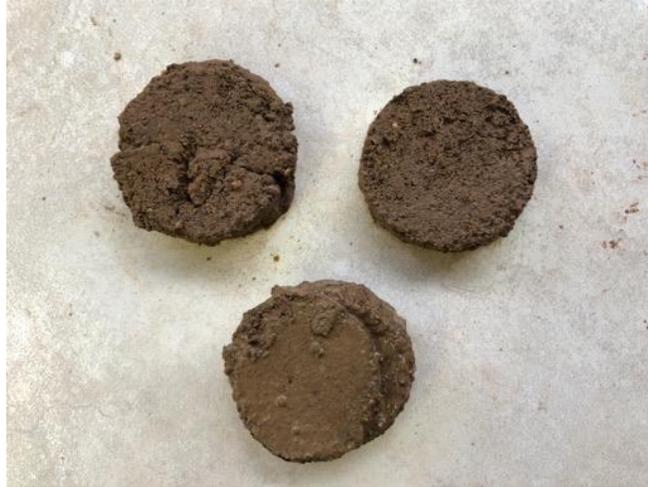
**Ilustración 58. Resultado de probetas de ensayo de corte directo en una arena arcillosa**
