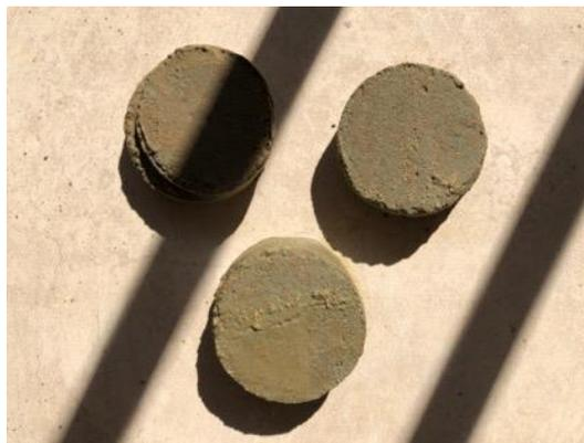
**Ilustración 64. Resultado de probetas de ensayo de corte directo en un limo.**
