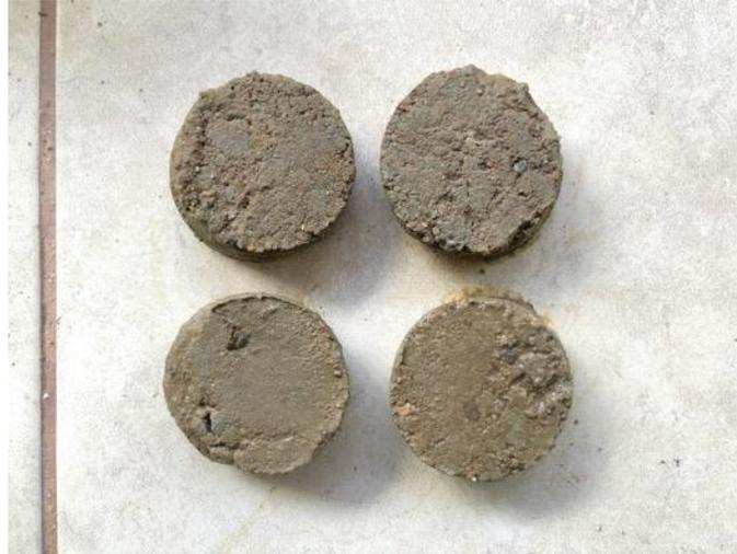
**Ilustración 46. Resultado de probetas de ensayo de corte directo en una arena limosa.**
