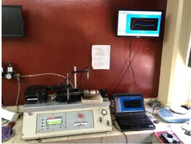
**Ilustración 51. Equipo para elaboración de ensayo de corte directo**
