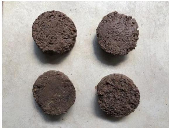
**Ilustración 62. Resultado de probetas en ensayo de corte directo.**
