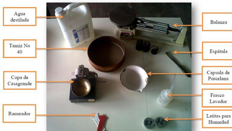
**Ilustración 9 Equipo para ensayo límites de Atterberg**
