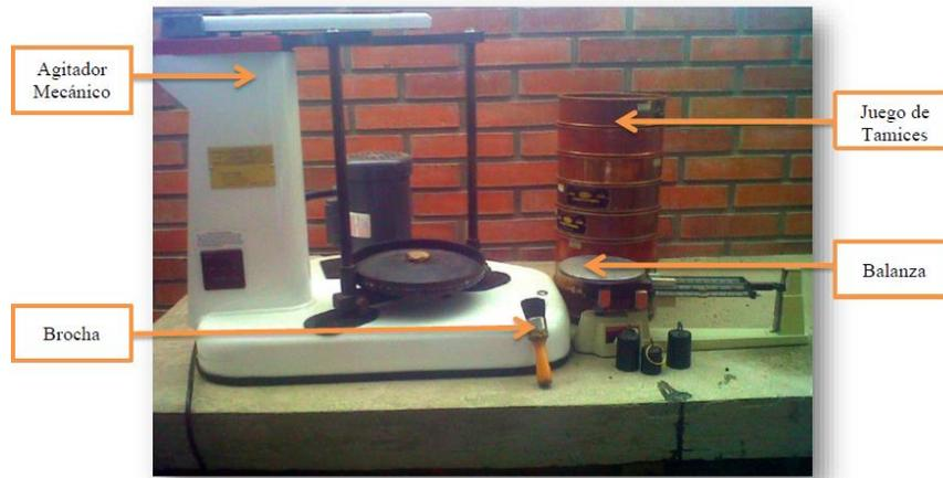
**Ilustración 8 Equipo para ensayo de granulometría**
