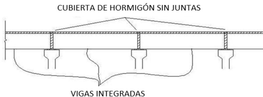
**Ilustración 36. Puente con vigas integradas (continuidad completa)**
