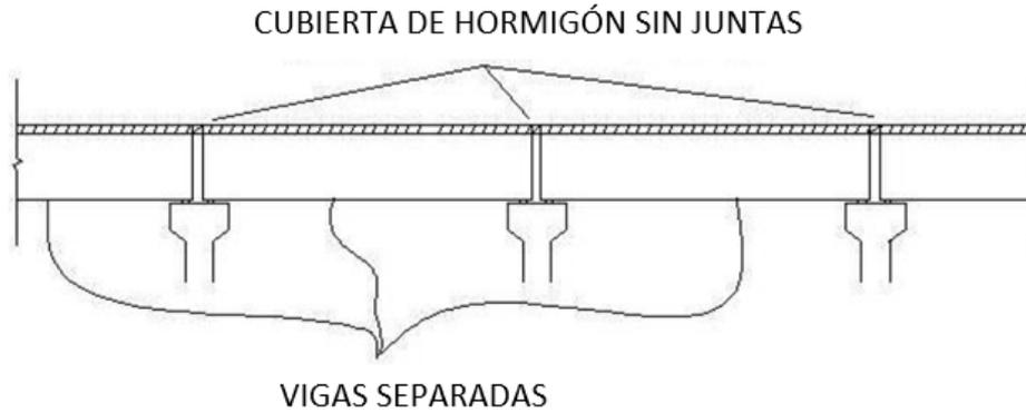
**Ilustración 37. Puente con vigas separadas (continuidad parcial)**
