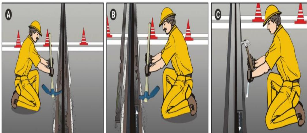
**Ilustración 24. Esquema de cambio de junta**
