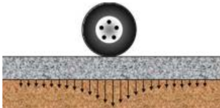
Ilustración 23 Transmisión de Cargas en Pavimento Rígido
