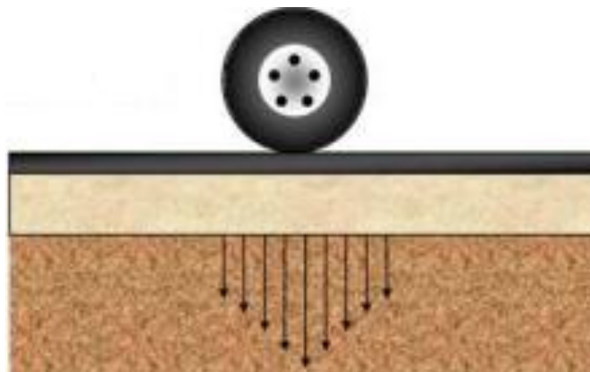
Ilustración 20 Transmisión de Cargas en Pavimento Flexible
