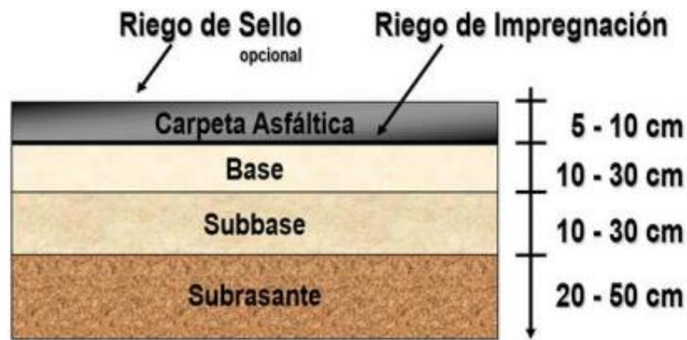
Ilustración 19 Corte Transversal de Estructura
