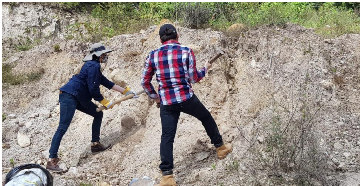
Ilustración 52. Extracción de muestra de suelo Est. 1+280
