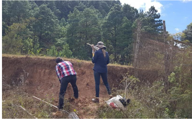
Ilustración 50. Extracción de muestra de suelo Est. 1+370
