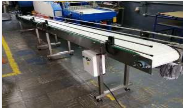
Figura 4.19 Banda transportadora 5 metros.
