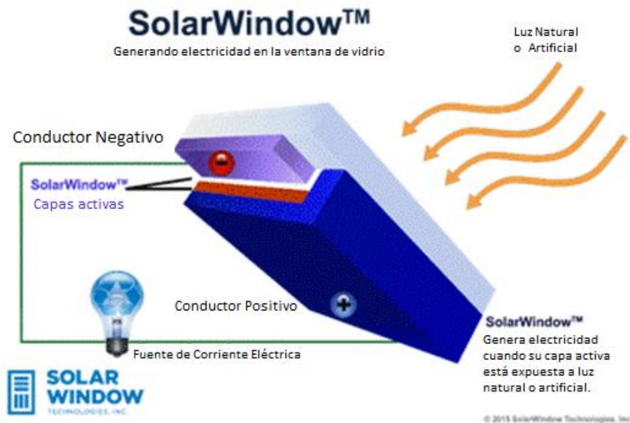
Ilustración IV.13 Sistema de ventana solar. Fuente: www.ecosolaresp.com
