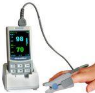
Figura 4.7 Pulsioxímetro portátil de altas prestaciones Choicemed
