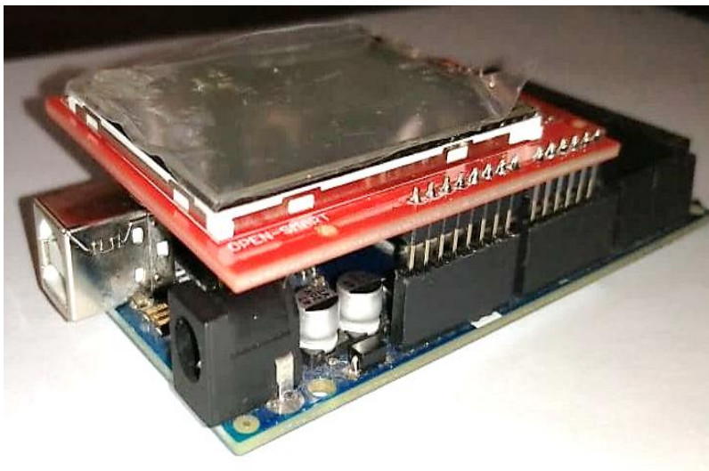
Figura 8.4 Vista lateral de Ensamblado de pantalla. Fuente: (Elaboración propia, 2021)
