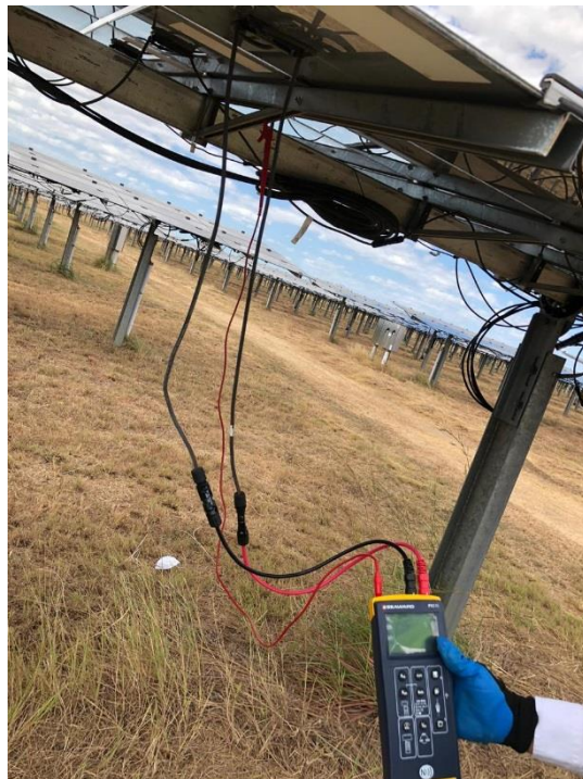
Ilustración 28. Medición de eficiencia de Módulos FV
