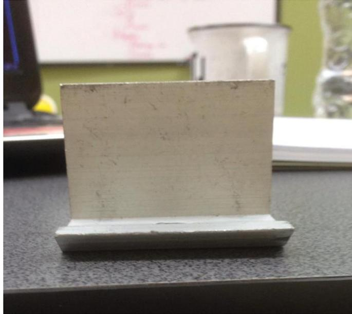
**Ilustración 18: Vista Frontal de un End Clamp**
