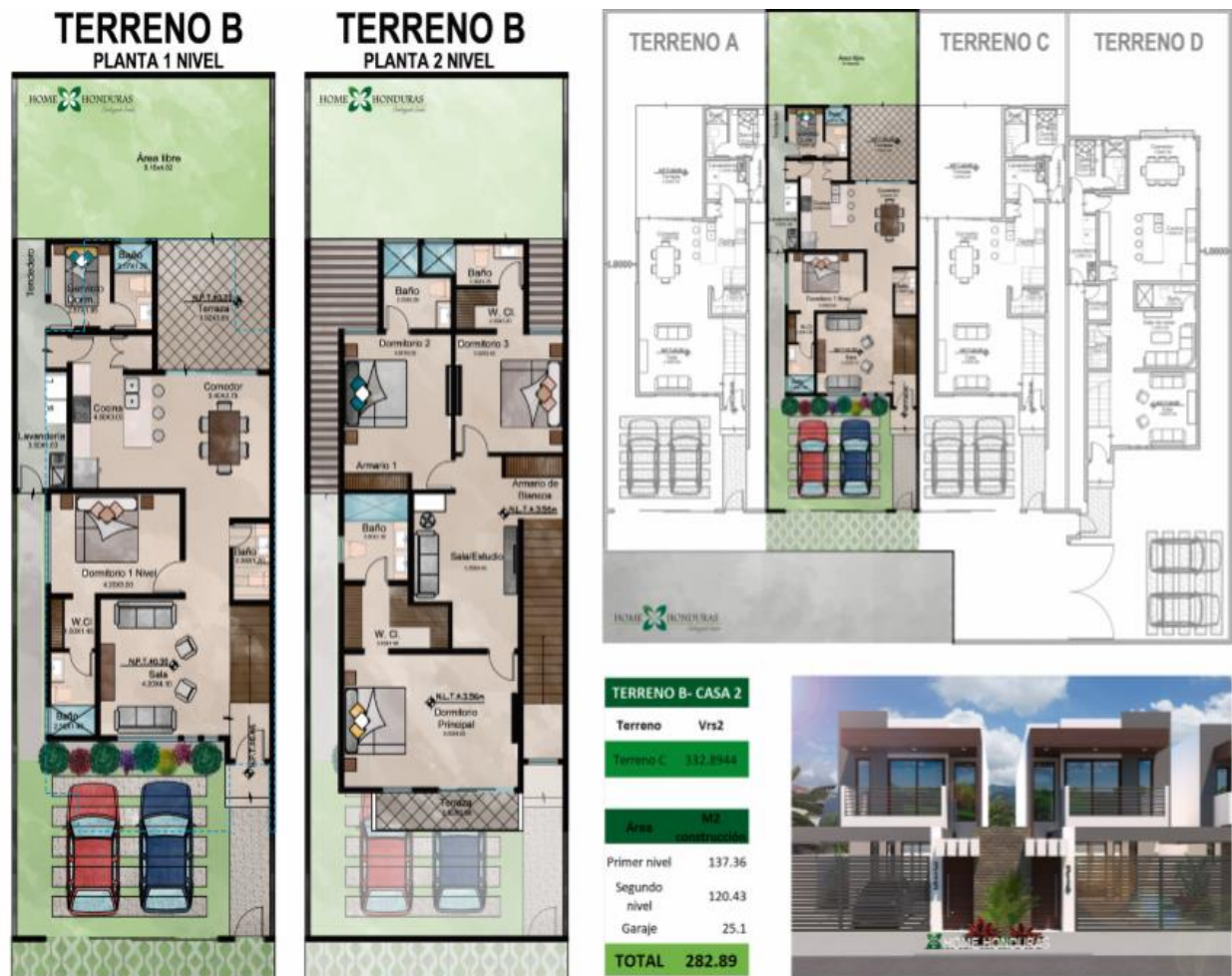
Ilustración 43. Terreno B- Casa 2 Distribución general.
