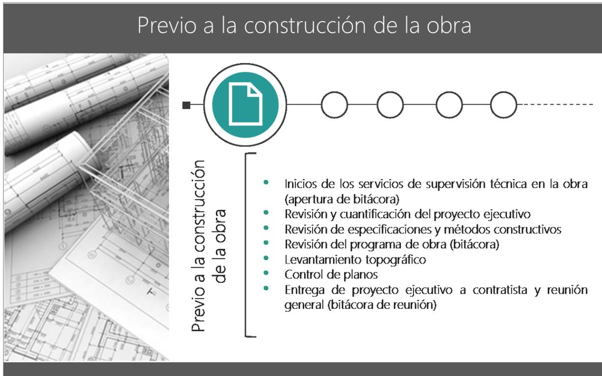
**Ilustración 16 Funciones de la supervisión técnica previo a la construcción de obra.**
