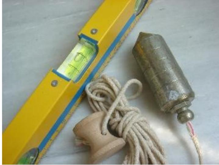
**Ilustración 19 Herramientas para la verificación de muro a plomo.**
