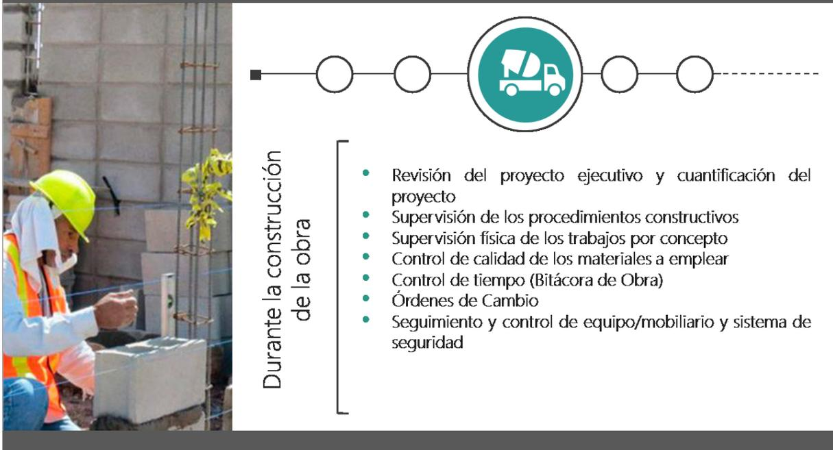
**Ilustración 18 Funciones de campo de la supervisión técnica durante la construcción de la obra.**
