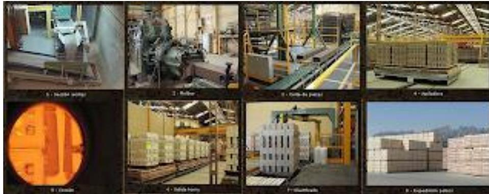
**Ilustración 16. Proceso de obtención de la cerámica**
