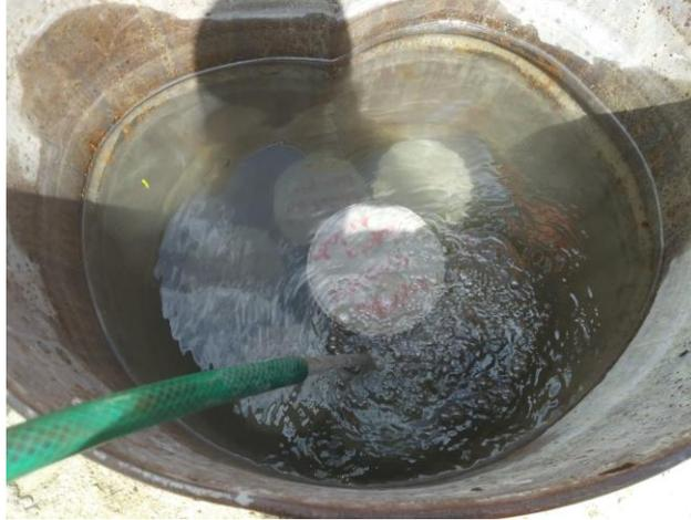
**Ilustración 80 Curado de cilindros.**
