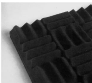
Fig. 2.7 Material absorbente a base de espuma de poliuretano (Illsonic Sonex de Illbruck, distribuido por Macco, S.L.)
