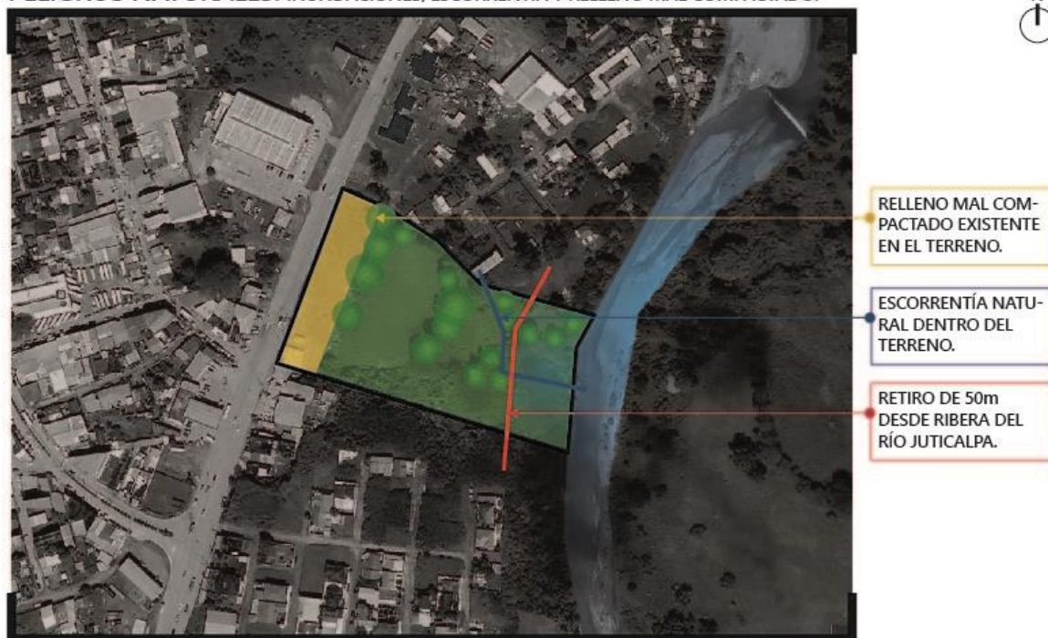
Ilustración 82 Peligros naturales dentro del terreno: inundaciones, escorrentía y relleno mal compactado.
