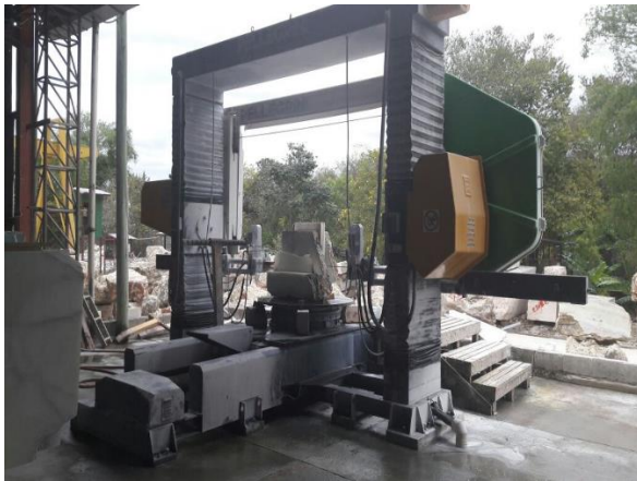
Maquinaria utilizada para corte de bloques
