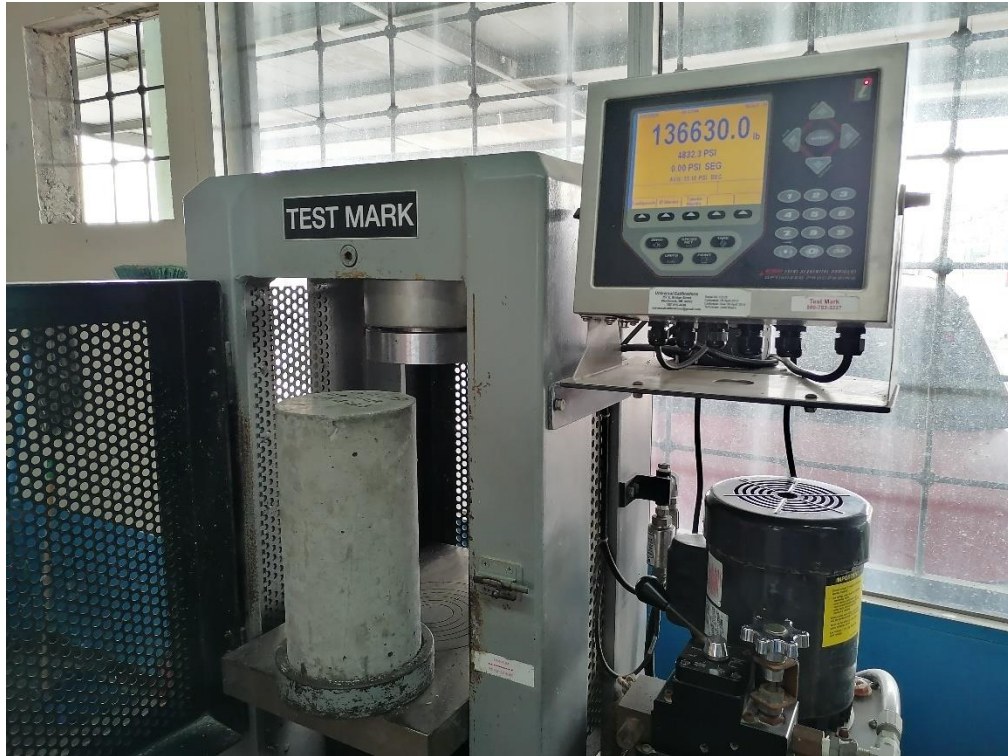
Ilustración 56 Ruptura de Cilindro
