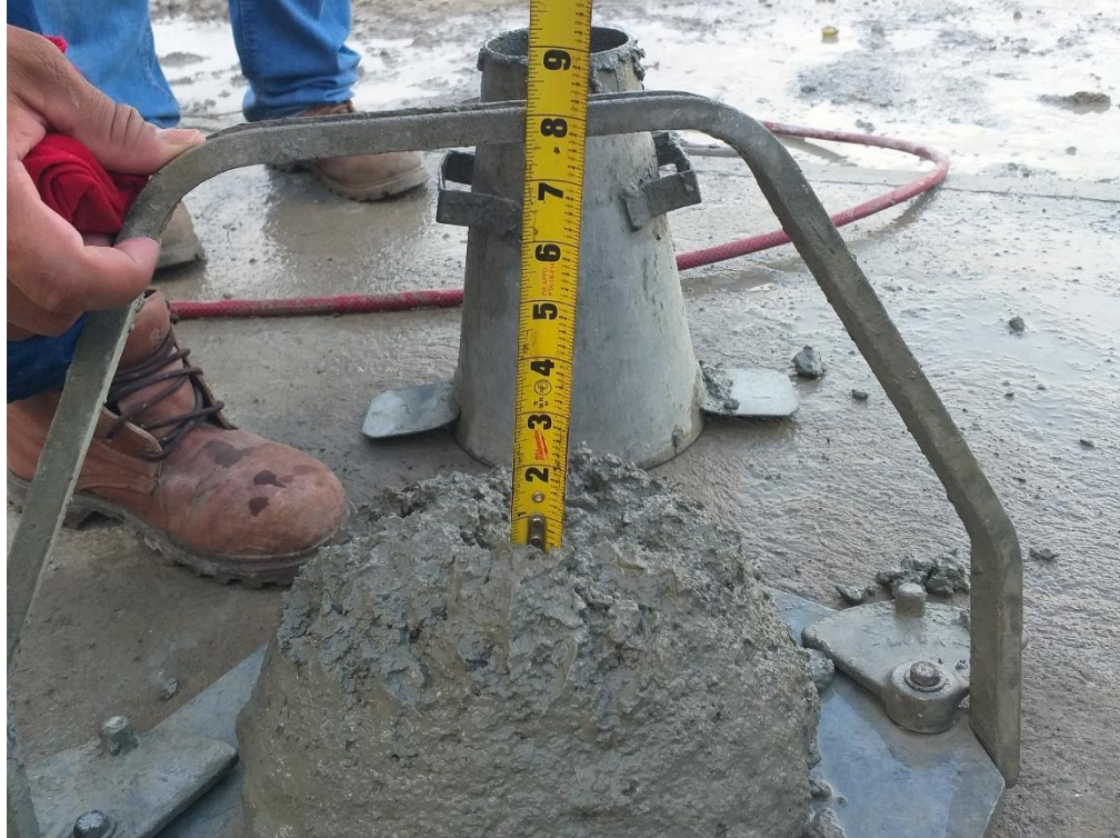
Ilustración 52 Realización de Ensayo de Revenimiento
