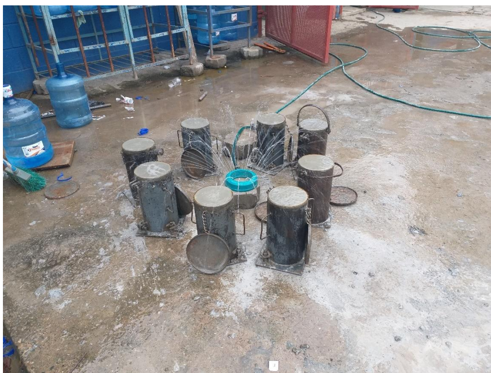
Ilustración 51 Curado de Cilindros para Ensayo de Compresión en Sitio
