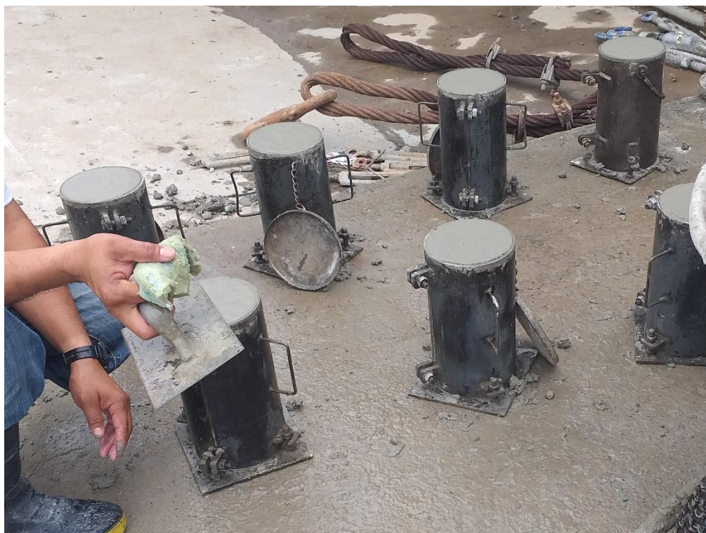
Ilustración 50 Realización de Cilindros para Ensayo de Compresión
