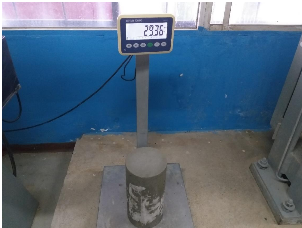
Ilustración 54 Peso de cilindro para ensayo de compresión
