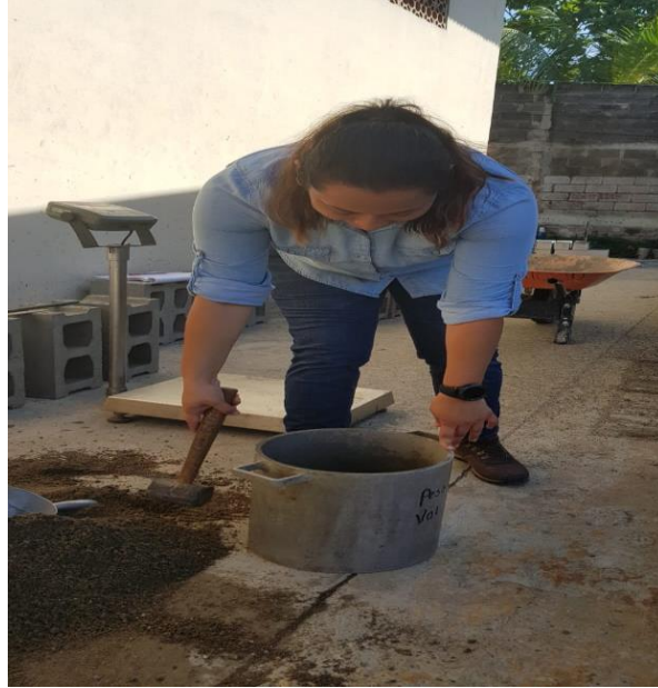
Ilustración 11. Ensayo de peso volumétrico.
