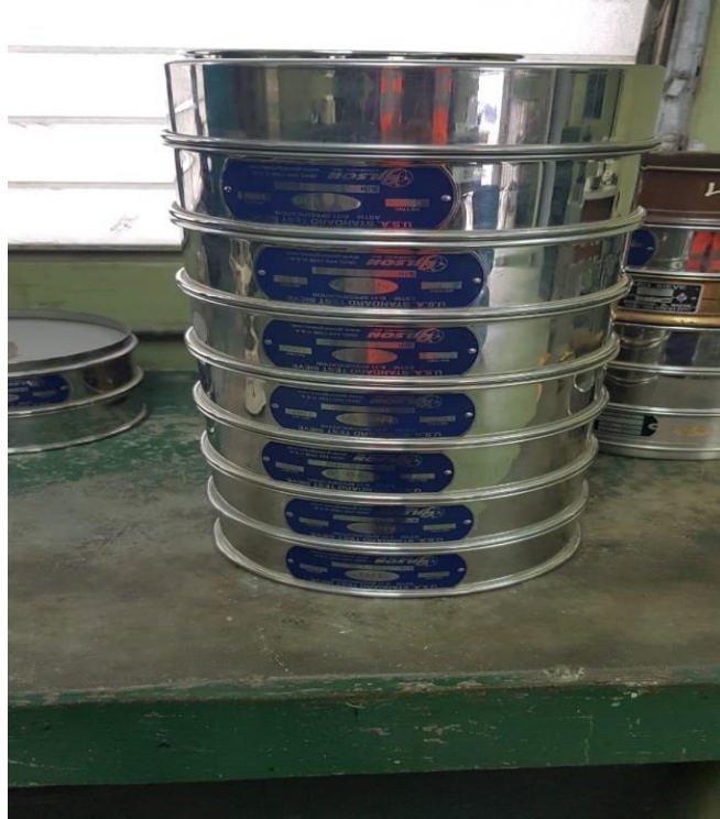
Ilustración 9. Tamices utilizados en el ensayo de granulometría
