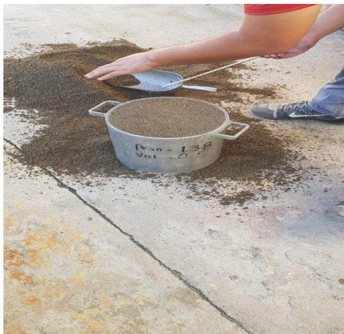
Ilustración 6. peso volumétrico de un agregado de arena húmeda.
