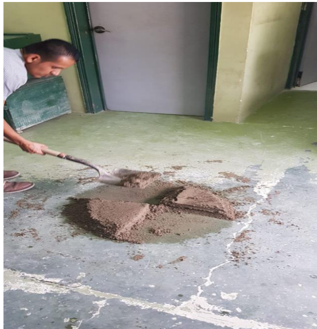
Ilustración 10. Cuarteo del agregado antes del ensayo de granulometría.
