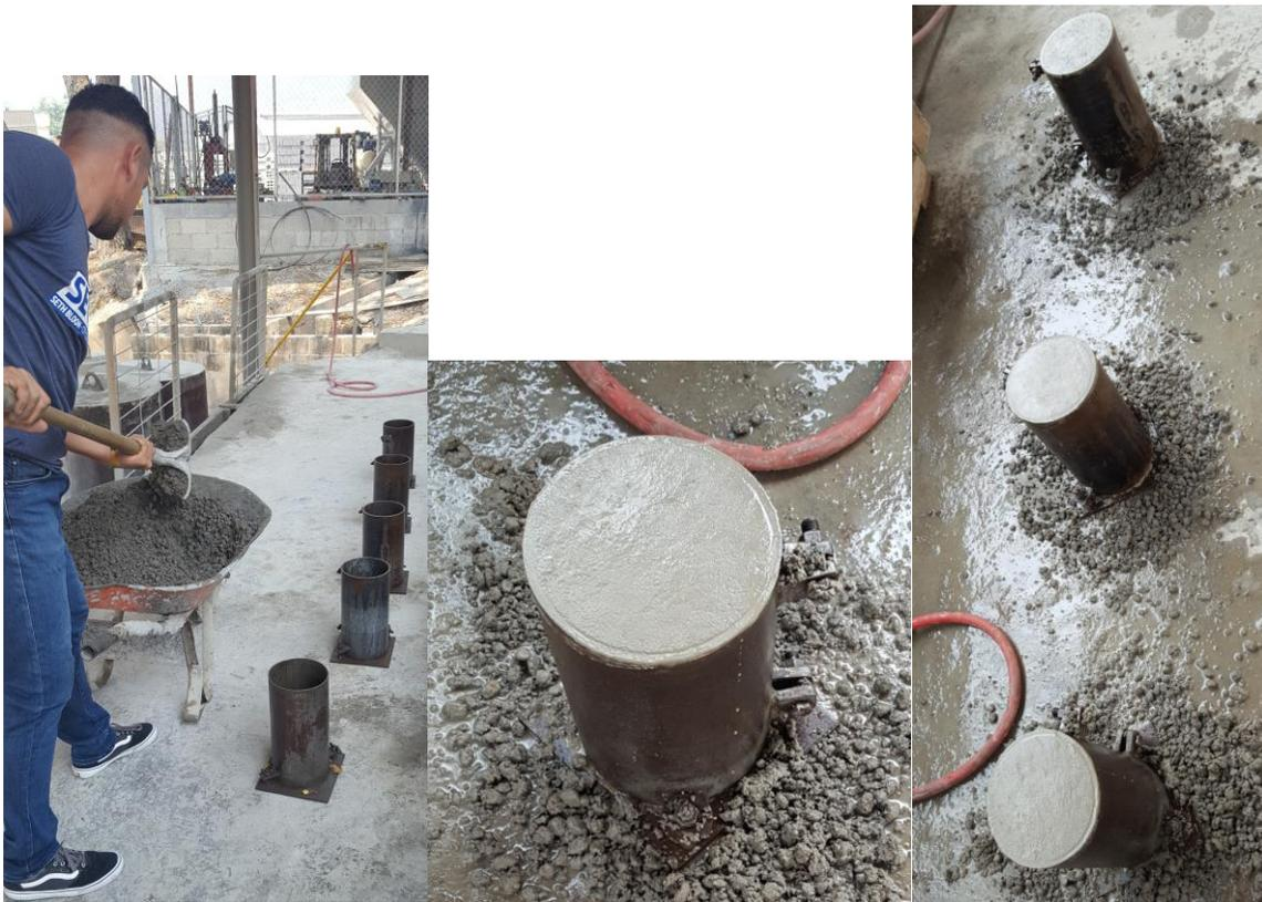
**Ilustración 107. Elaboración de cilindros de los tubos de concreto**
