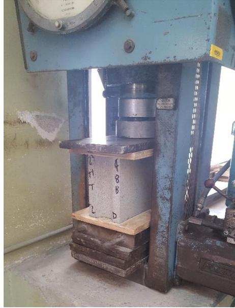
**Ilustración 110. Pruebas de resistencia en bloques**
