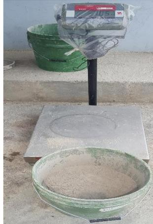
**Ilustración 24. Pesado de los agregados**
