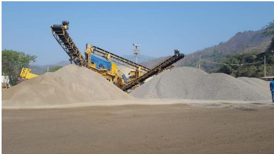
**Ilustración 97. Trituradora para agregados.**
