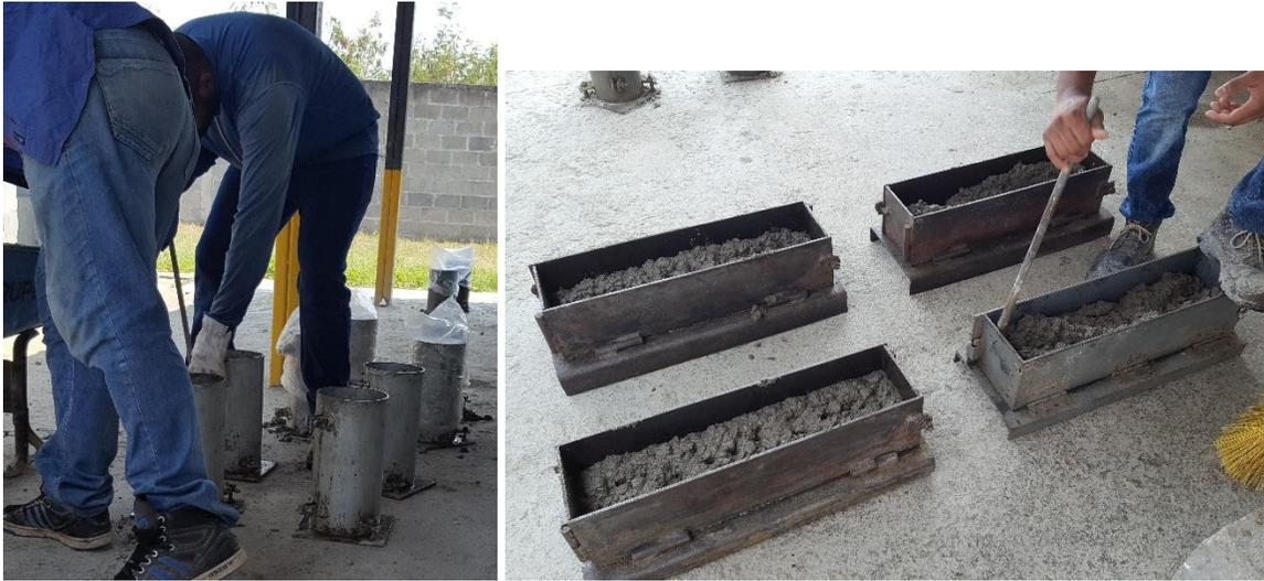
**Ilustración 28. Elaboración de cilindros y vigas**
