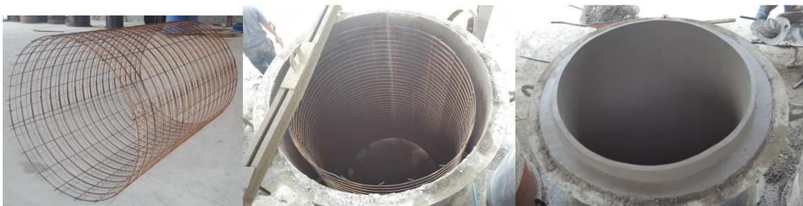
**Ilustración 105. Elaboración de tubería de concreto 42" diámetro**
