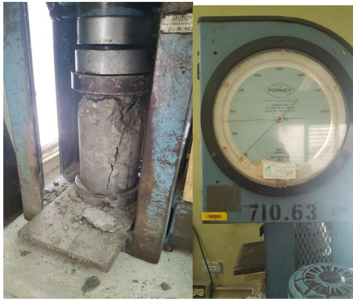
**Ilustración 17. Ruptura de cilindros y vigas**
