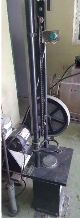
**Ilustración 4. Martillo Marshall para elaborar briquetas de asfalto**
