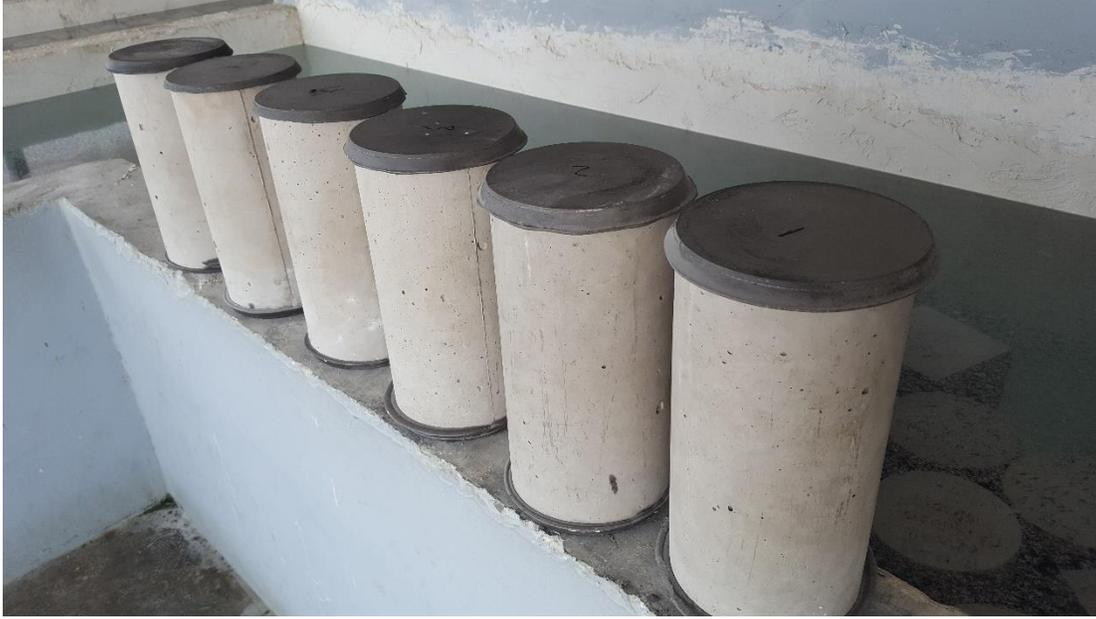
**Ilustración 112. Preparado de cilindros con material de cabeceo para posterior ruptura**
