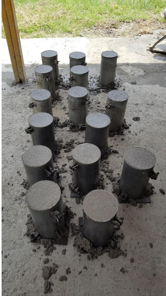
**Ilustración 124. Elaboración de cilindros en diseños de mezcla**
