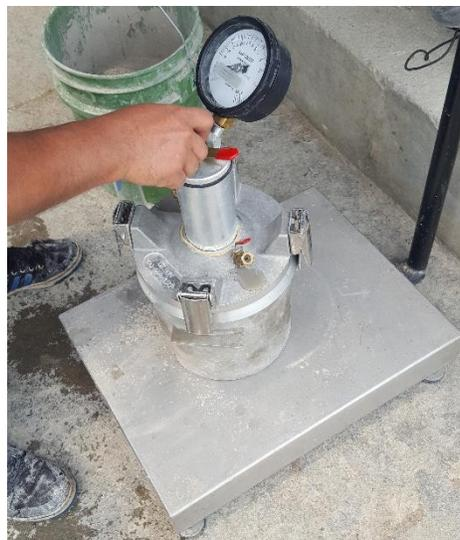
**Ilustración 27. Prueba de contenido de aire y peso unitario del concreto**
