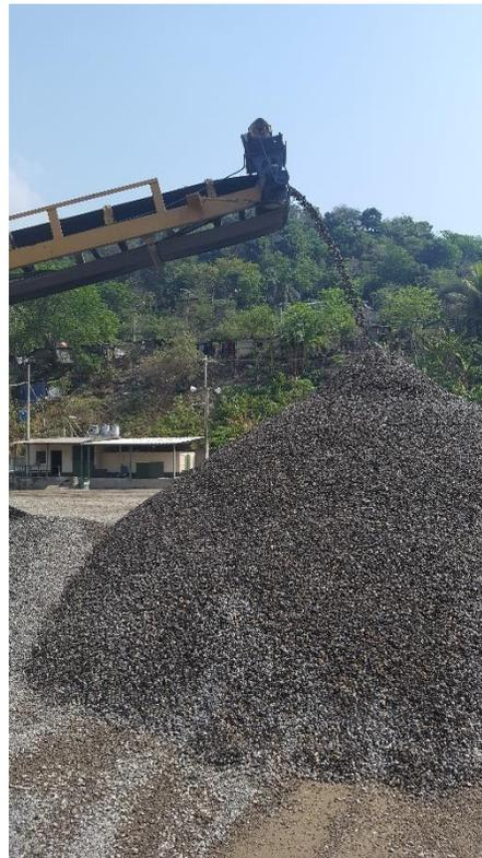
**Ilustración 111. Extracción de agregados mediante el uso de la trituradora**
