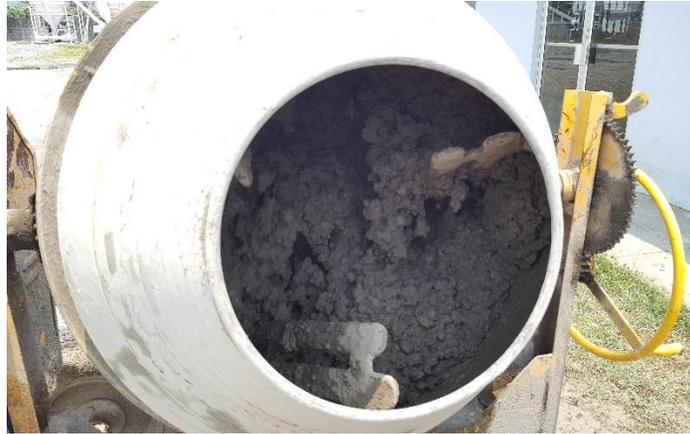
**Ilustración 22. Mezcladora de concreto**
