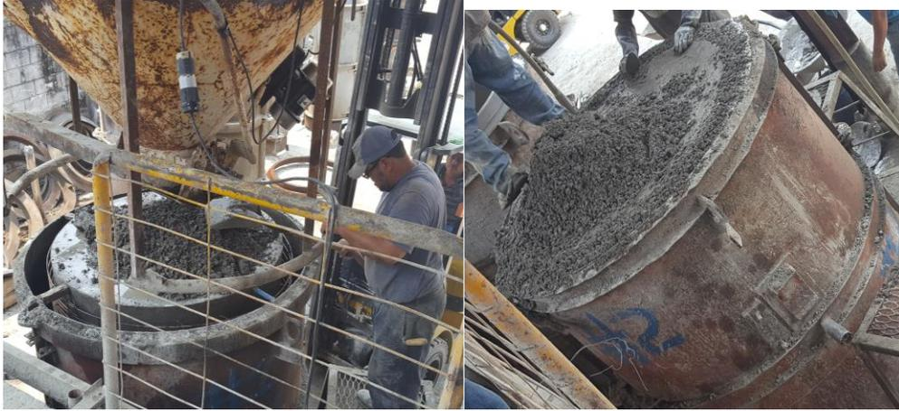
**Ilustración 106. Preparación del tubo de concreto de diámetro 42"**
