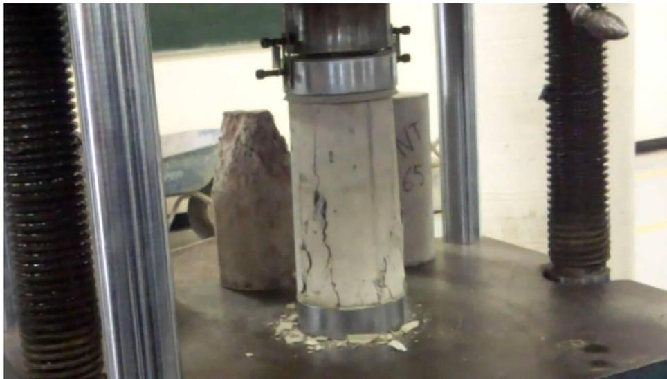
**Ilustración 11. Pruebas de resistencia en concreto**
