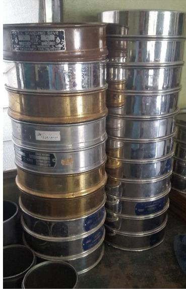
**Ilustración 50. Tamices para la realización de granulometría**
