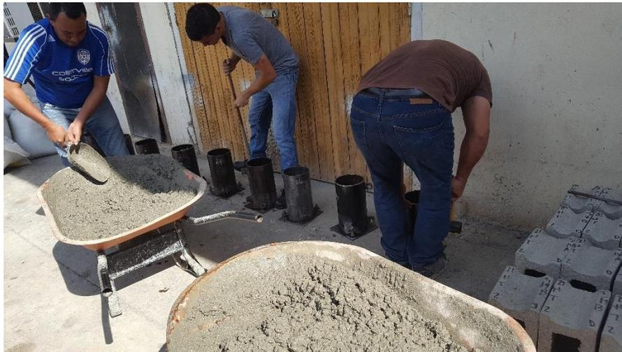
**Ilustración 38. Proceso de elaboración de los diseños de mezcla**
