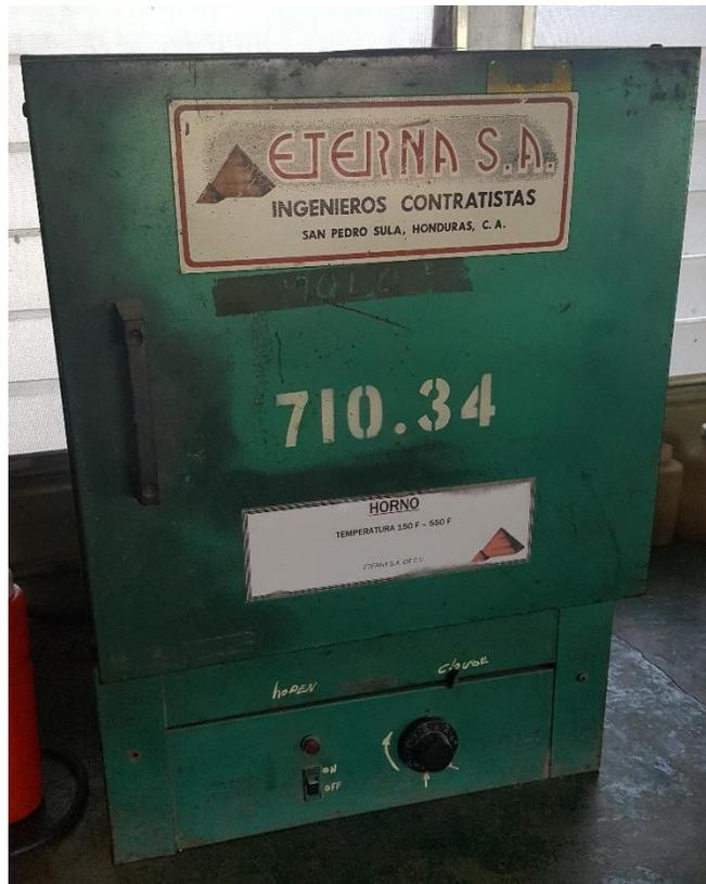
**Ilustración 57. Horno para el secado de la muestra**
