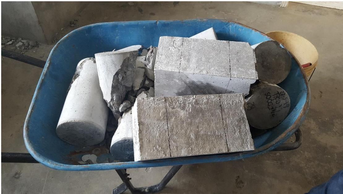
**Ilustración 123. Vigas y cilindros posterior a pruebas de rupturas**
