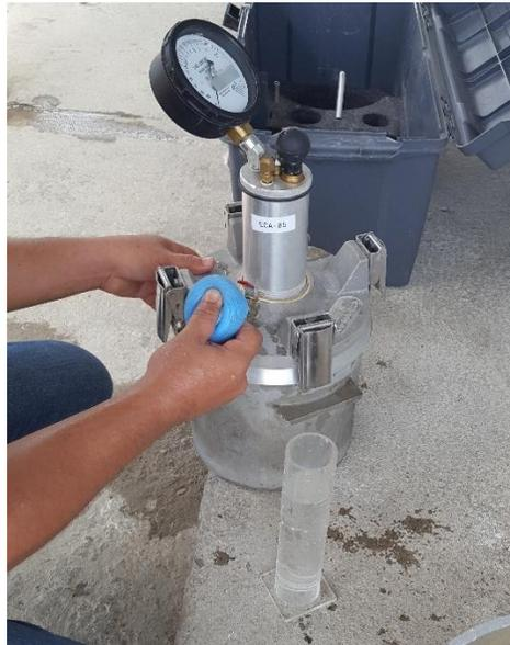
**Ilustración 36. Prueba de peso unitario y contenido de aire**
