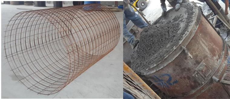
**Ilustración 15. Elaboración de tubería de concreto diámetro 42"**
