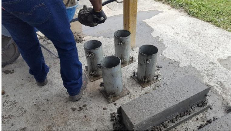
**Ilustración 37. Elaboración de cilindros**
