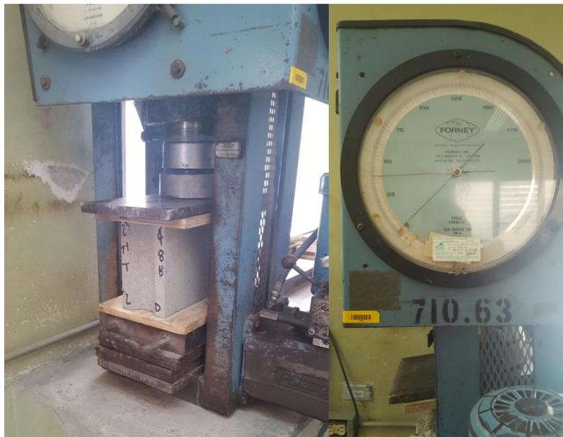
**Ilustración 18. Pruebas de ruptura en bloques**
