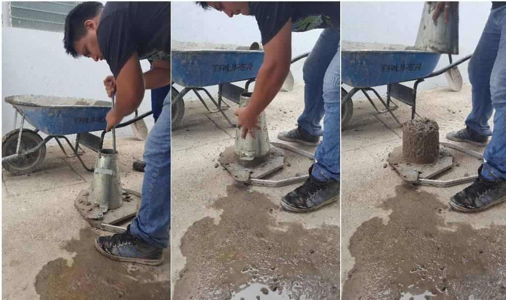
**Ilustración 26. Varillado y realización de prueba de revenimiento**
