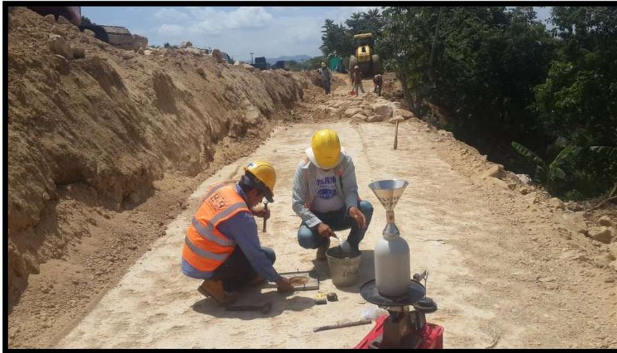
**Figura 4. Densidad in situ. Estación 211+300**
