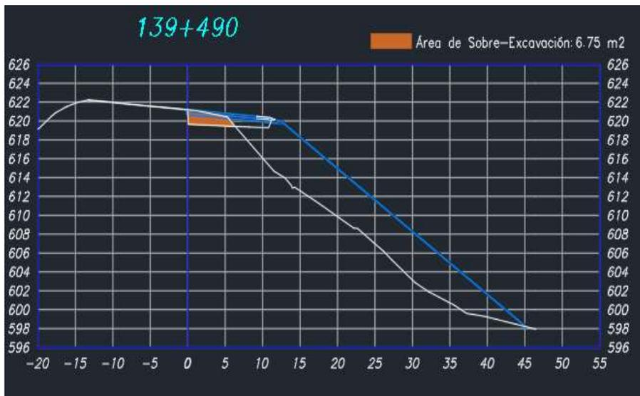
**Figura 7. Sección de sobre-Excavación. Estación: 139+490**
