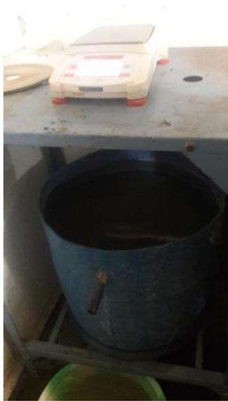
**Figura 7. Balanza digital para determinación de densidad máxima teórica de concreto asfáltico.**
