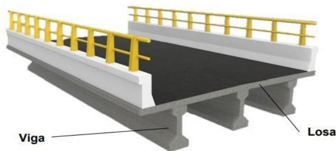
**Ilustración 41 - Superestructura de losa sobre vigas**
