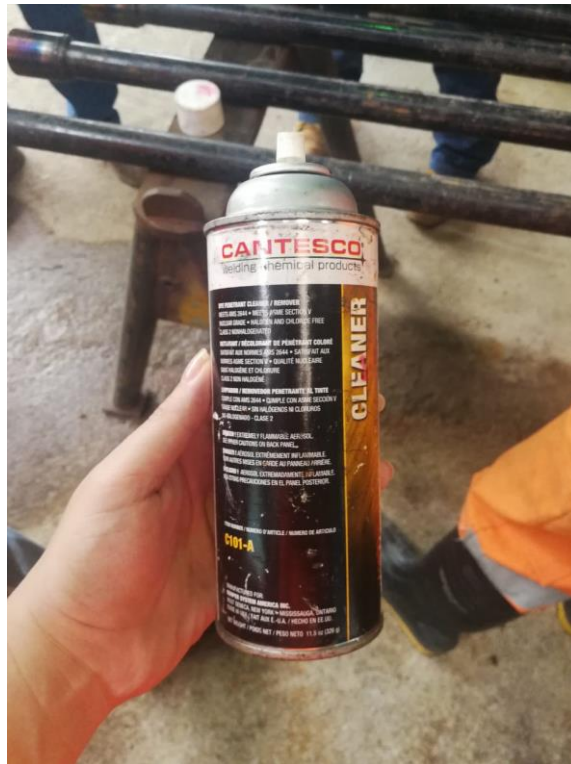
Ilustración 9: Limpiador de escoria en tubería.
