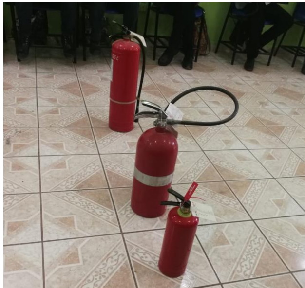
Ilustración 3: Tipos de extintores.
