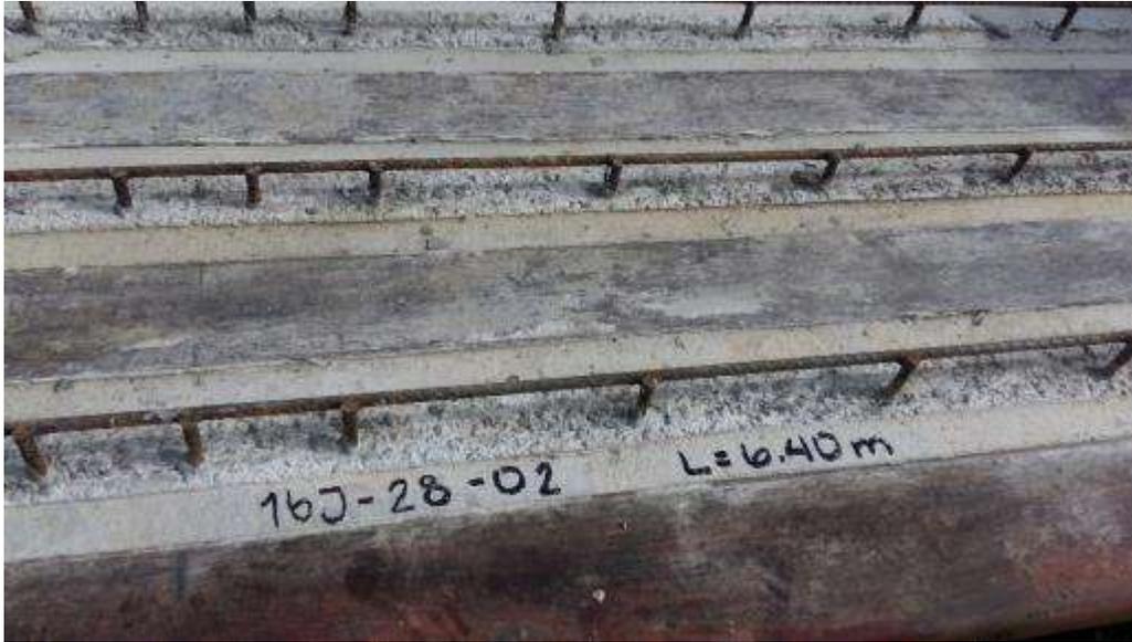
**Figura 9. Vigueta 16J terminada y etiquetada.**
