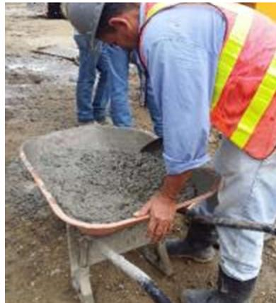
**Figura 36. Megamall, ensayos en concreto fresco.**
