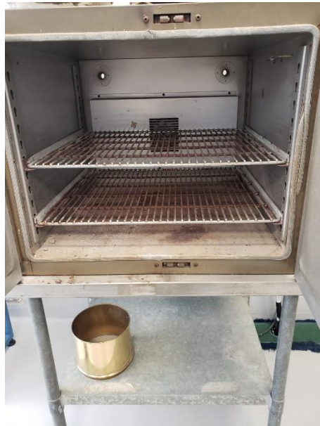
Figura 15 Horno para secar los agregados.
