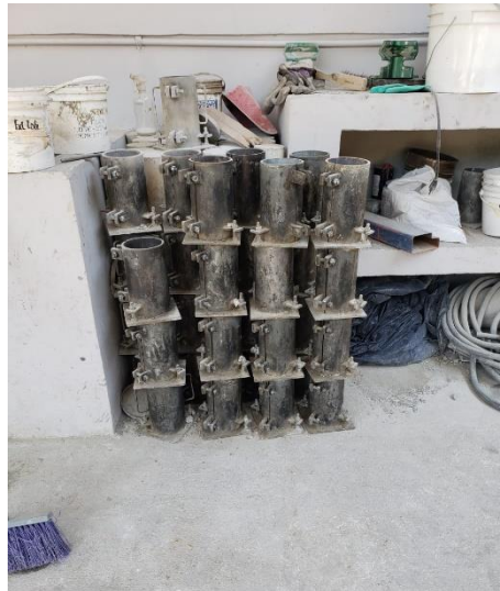
Figura 10 Moldes para especímenes de concreto 4inx8in
