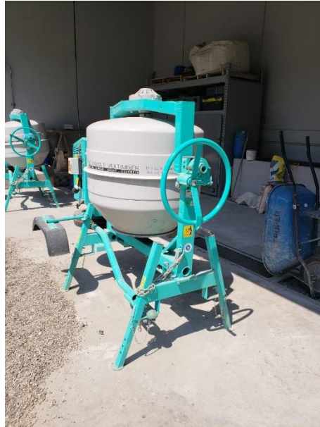
Figura 12 Mezcladora utilizada en las pruebas de comportamiento de los aditivos con el concreto.
