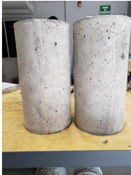
Figura 6 Especímenes para ruptura de 6inX12in
